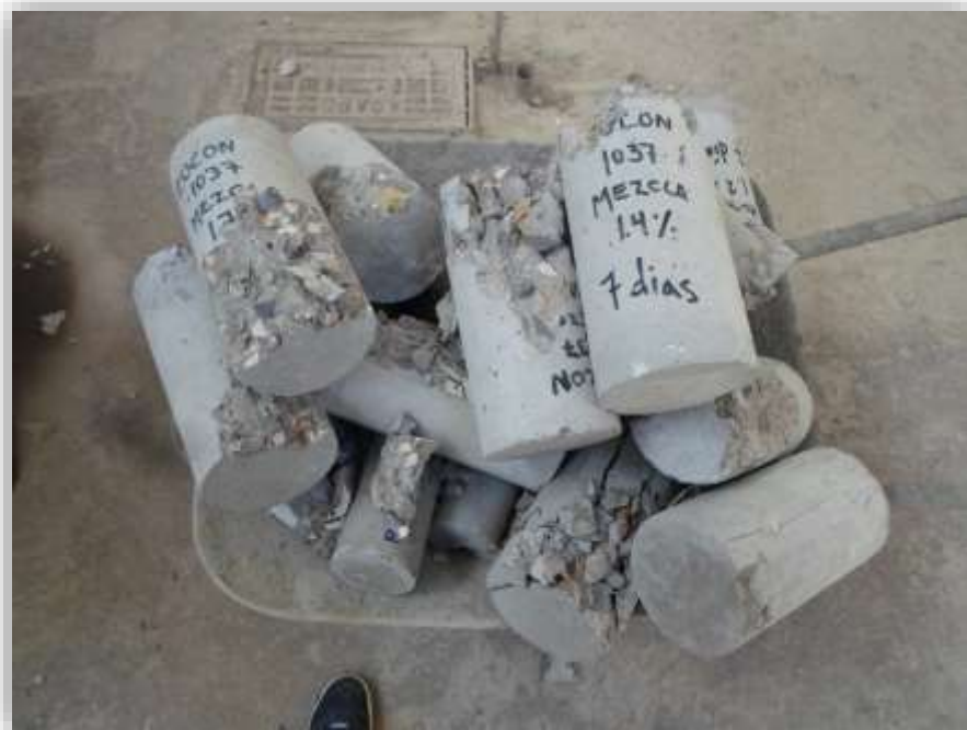
Foto N°29: Se observa el tipo de falla de todos los especímenes solicitados para la verificación de resistencias a edad de 7 días.
