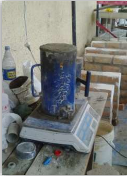
Foto N°16: Obtención del PU del C° Fresco
