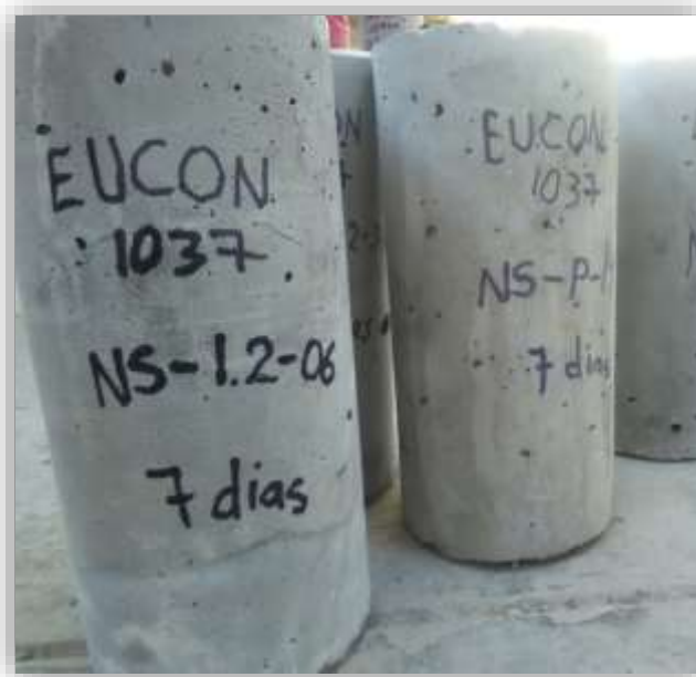
Foto N°19: Retiro de probetas del lugar de curado para acondicionamiento medición y posterior ensayo a compresión.
