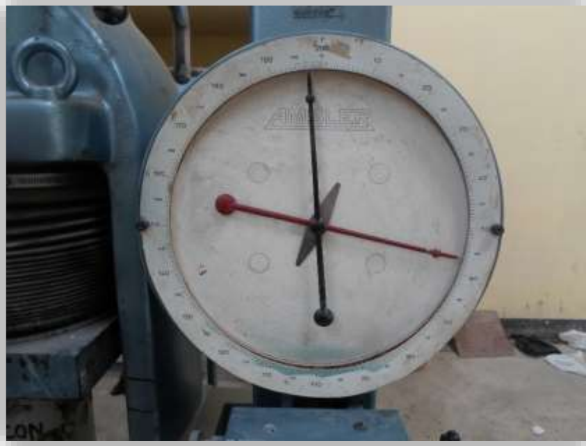
Foto N°28: Carga que soporta uno de los especímenes de concreto ensayados.
