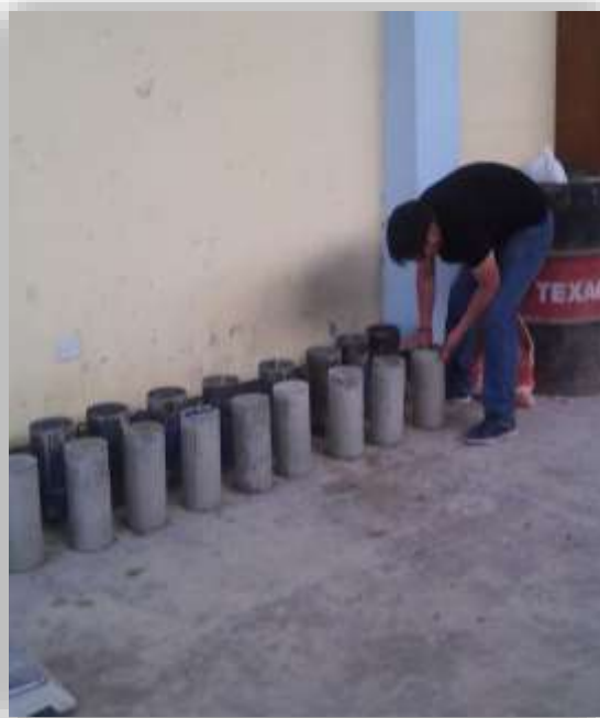
Foto N°16: Obtención del PU del C° Fresco
