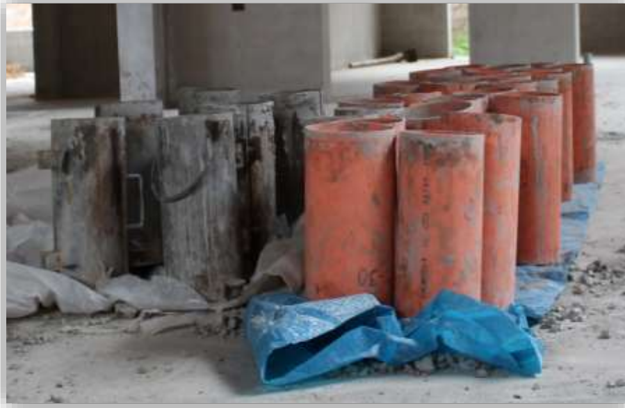
Foto N°14: Probetas listas para llenado después de la colocación de una fina película de aceite a las paredes internas de la probeta para evitar adherencia del concreto al momento del desencofrado.
