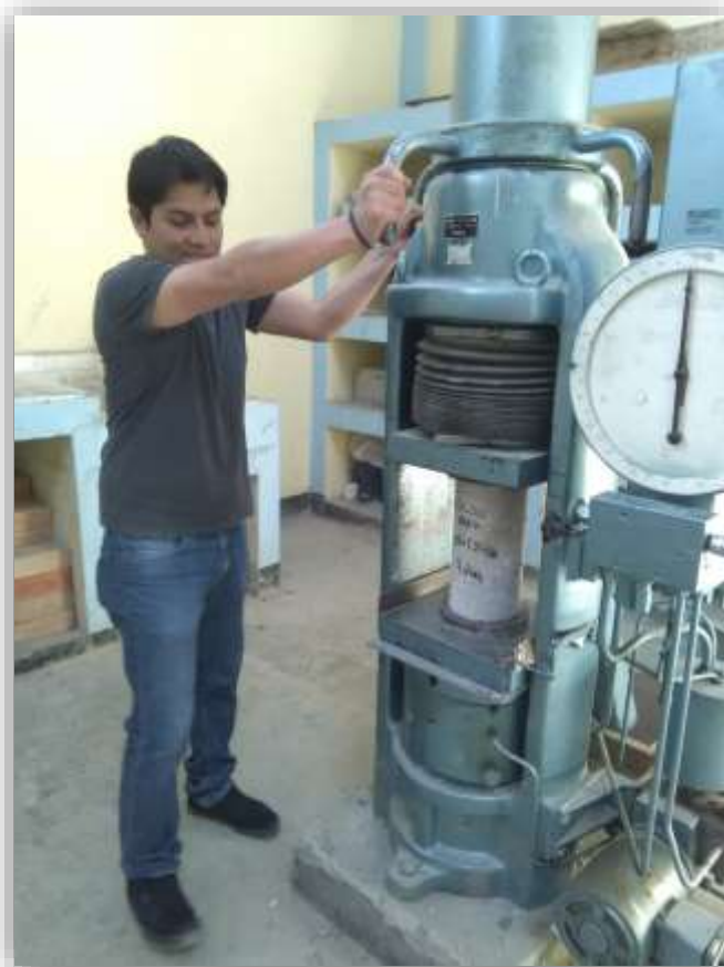
Foto N°20: Maquina de ensayo a compresión realizando en el ensayo de especímenes con edades de 7 días.
