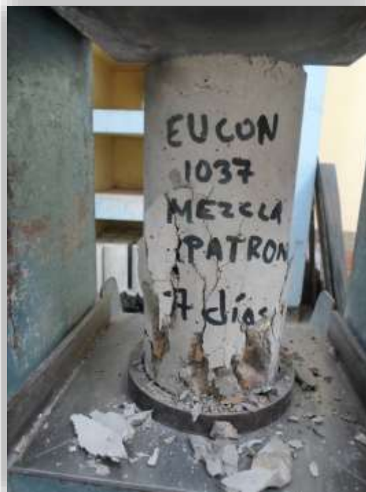
Foto N°27: Se observa el tipo de falla de un espécimen a edad de 7 días. Tipo de falla 3
