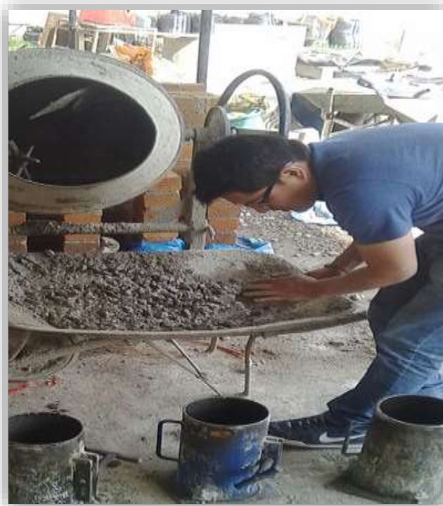
Foto N°15: Observamos llenado de probetas para su posterior rotura.
