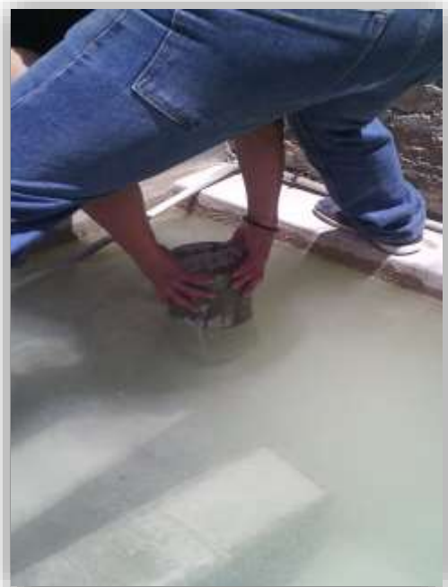
Foto N°16: Obtención del PU del C° Fresco
