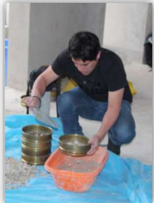
Foto N°04: Se observa la realización del análisis granulométrico del agregado grueso.
