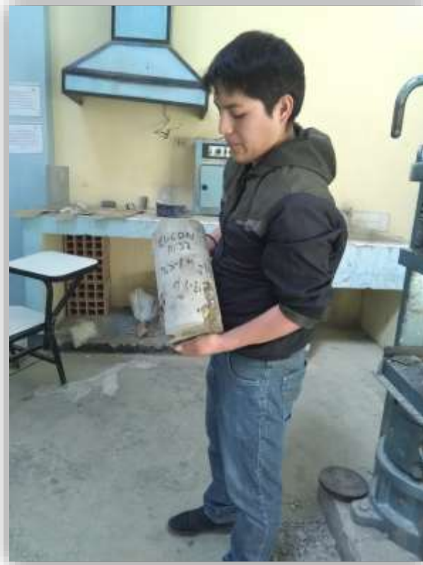
Foto N°23: Se observa el tipo de falla de un espécimen de edad de 28 días. Tipo de falla 2
