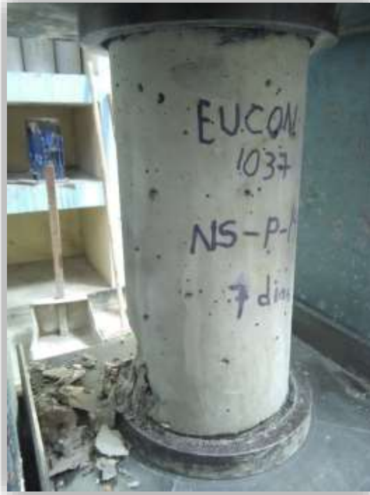
Foto N°21: En este caso se observa la falla típica del espécimen ensayado. En este caso se observa una falla de tipo 5.
