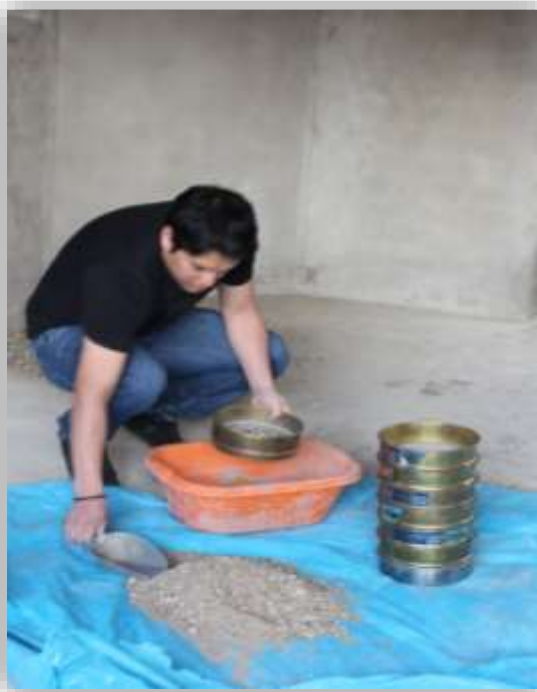
Foto N°03: Se observa la realización del análisis granulométrico del agregado fino.
