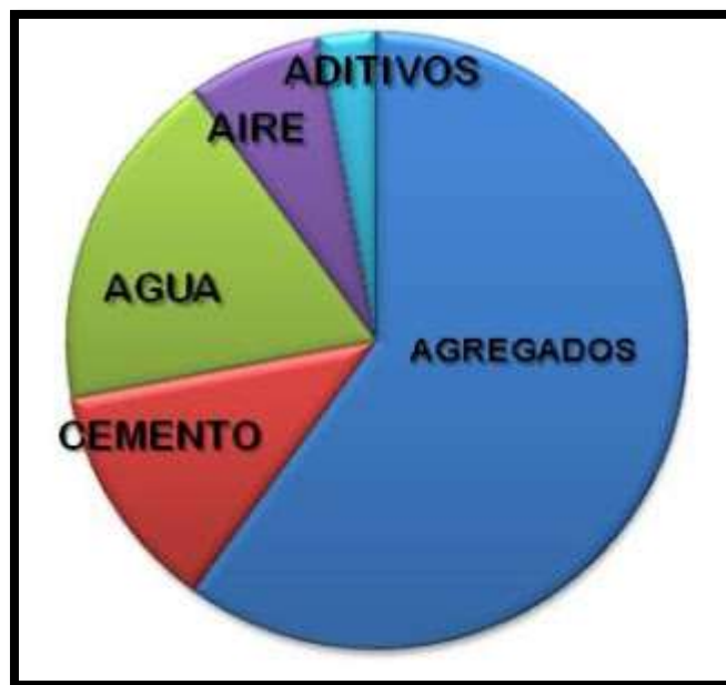
Figura N°01: Componentes del concreto.
