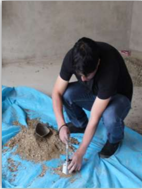
Foto N°05: Verificación de estado de humedad del agregado fino para determinar su peso específico.
