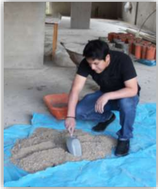
Foto N°02: Selección del agregado fino para los ensayos de laboratorio.
