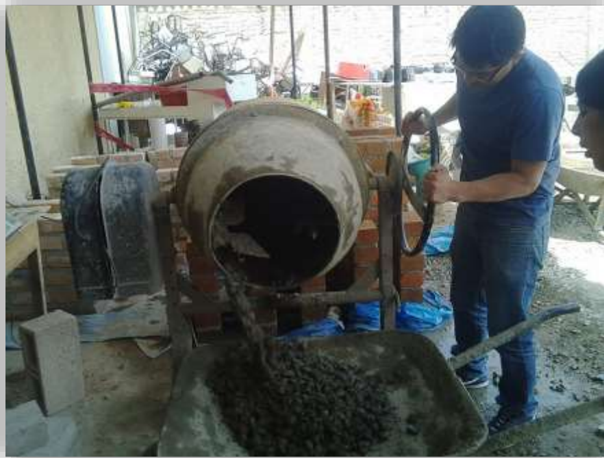
Foto N°10: Mezcla de concreto lista para realizar los ensayos en estado fresco
