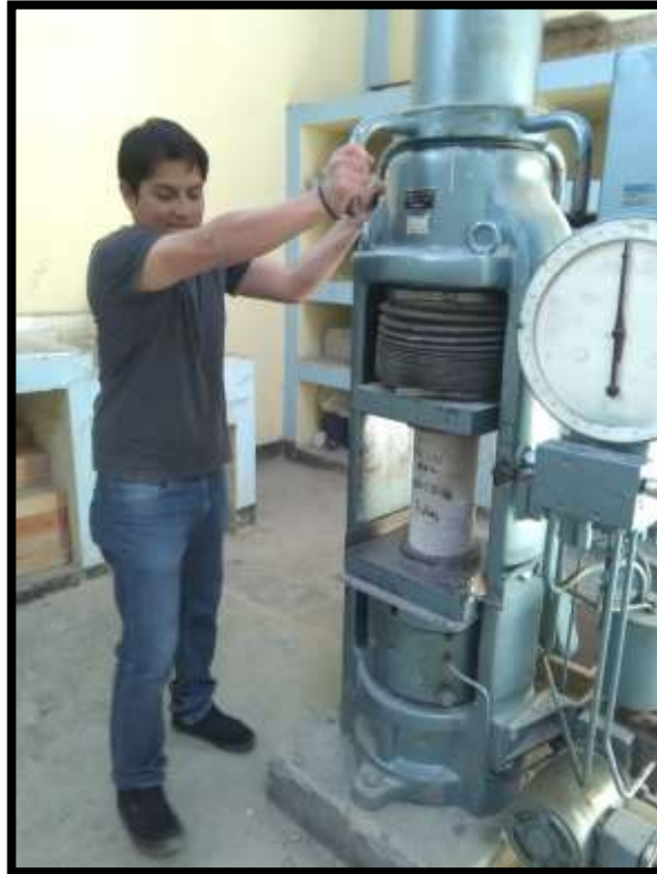
FIGURA N°09: Ensayo de Resistencia a la Compresión
