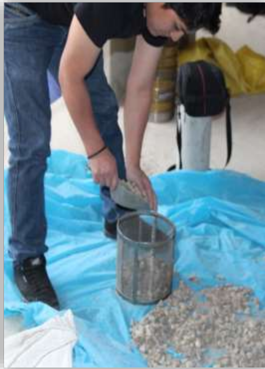
Foto N°07: Ensayo para la determinación del peso específico del agregado grueso.
