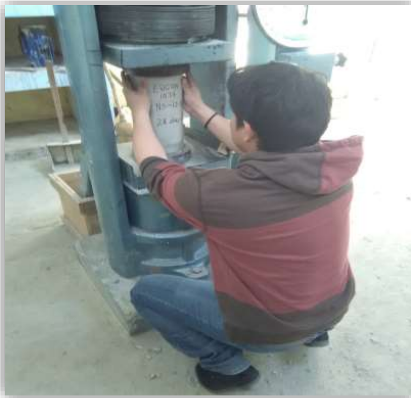
Foto N°22: Ensayo de compresión uniaxial con especímenes de edades de 28 días.
