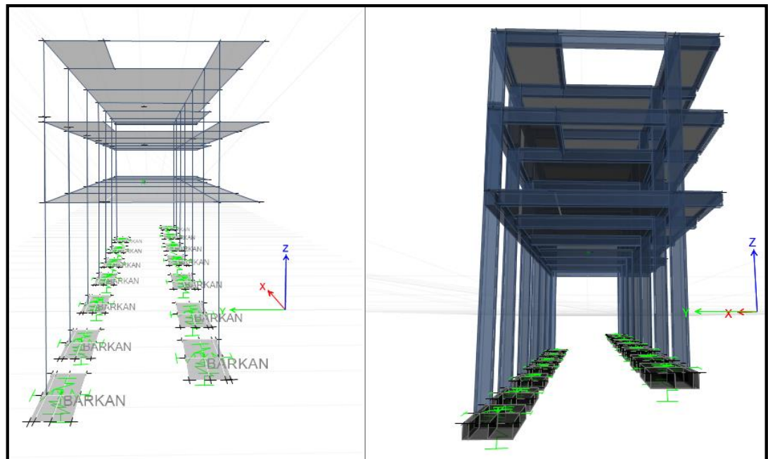
Fig. 30: Definición y asignación del spring en el centrode de las zapatas, para el modelo D.D Barkan-O.A Savinov. Fuente: Etabs 2016
