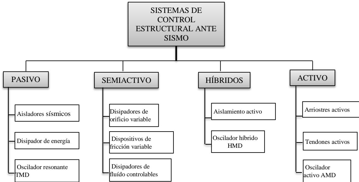
Fig. 4. Sistemas de control estructural. Fuente: Pardo. 2007. pag.31
