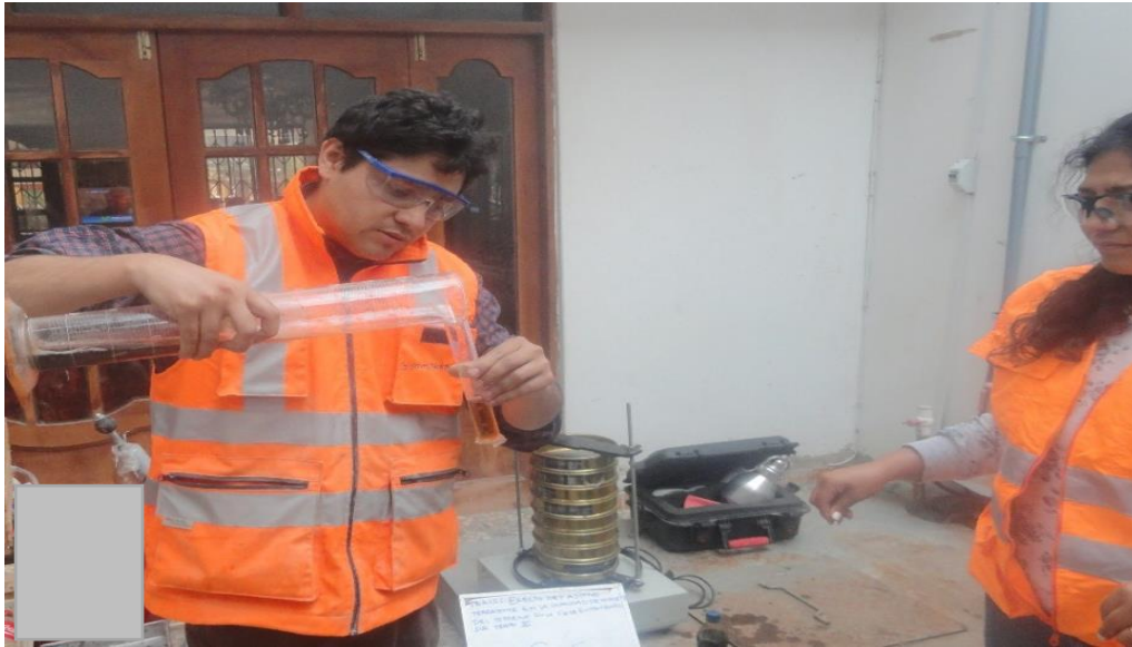
FOTO 4: Realizando los ensayos en laboratorio con la colocación del aditivo Terrazyme a la muestra.
