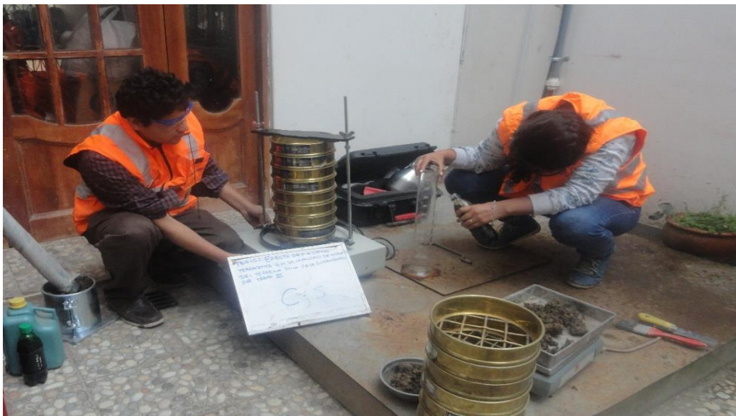
FOTO 4: Realizando los ensayos en laboratorio con la colocación del aditivo Terrazyme a la muestra.
