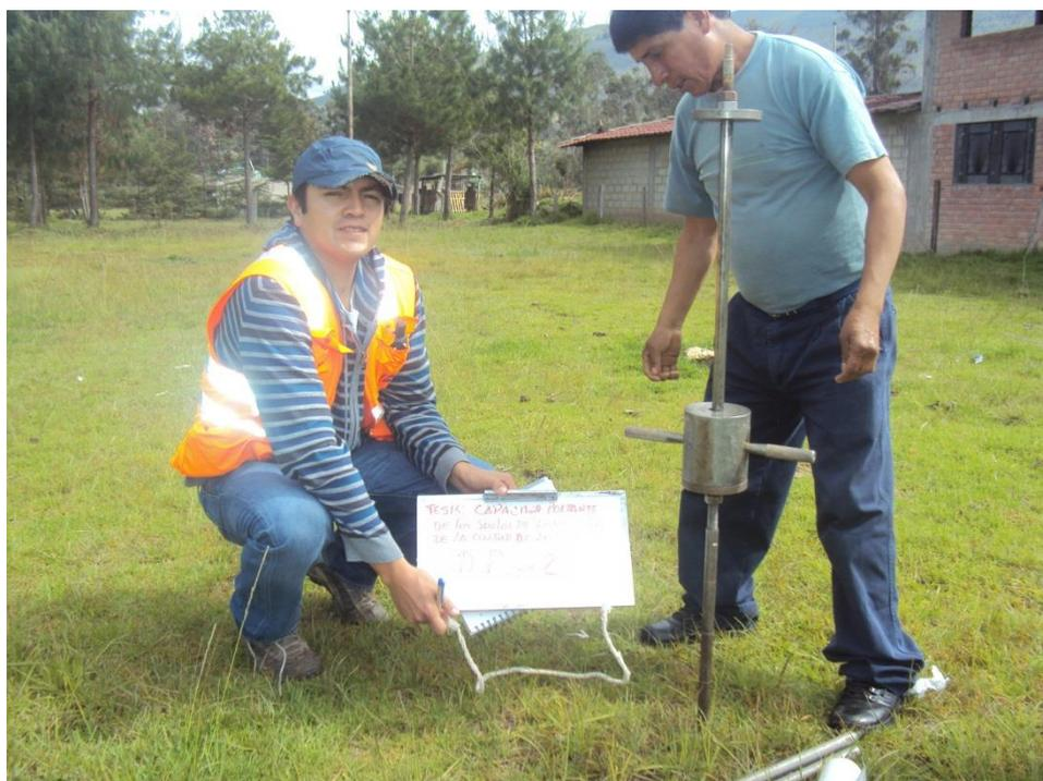
**Figura 16: Realizando la ejecución de calicatas y ensayo DPL**
