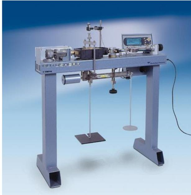
Figura 2: Aparato de cizalladura
