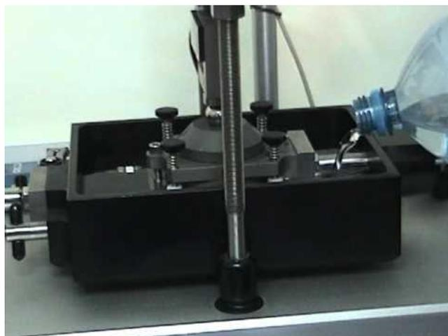
Figura 3: Caja de cizalladura
