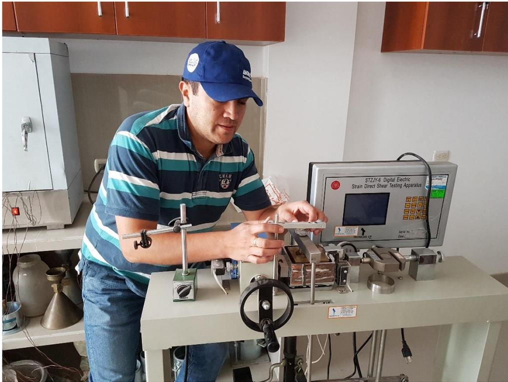
**Figura 19: Realizando el ensayo de Corte Directo**
