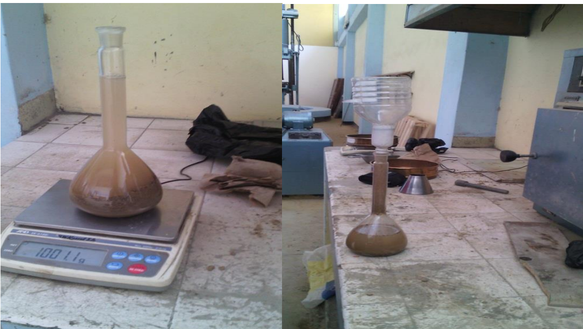
FOTO N°04: Determinación de las propiedades físico mecánicas de los agregados: Peso específico y absorción.
