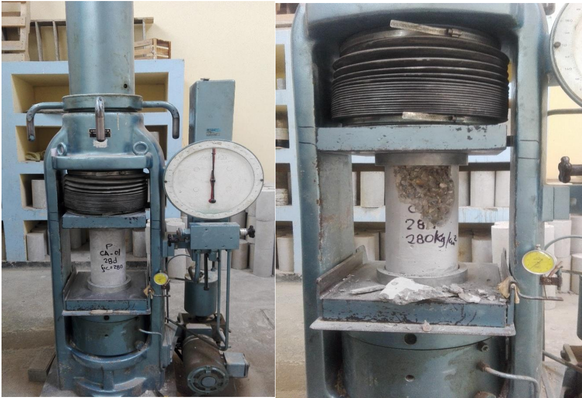
FOTO N°11: Realización de ensayo a compresión se puede apreciar la máquina de compresión axial, deformímetro de carga, en la fotografía de la derecha se observa el espécimen roto experimentando una falla tipo corte, de modo frágil.
