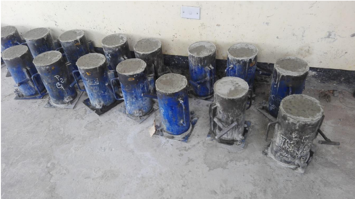
FOTO N°05: Especímenes de concreto con 24 horas de elaborado, previo a su desencofrado, codificación y curado respectivo.
