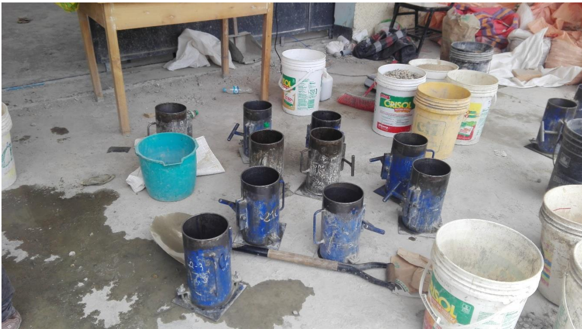
FOTO N°08: Probetas normadas para el vaciado de concreto en el Laboratorio.
