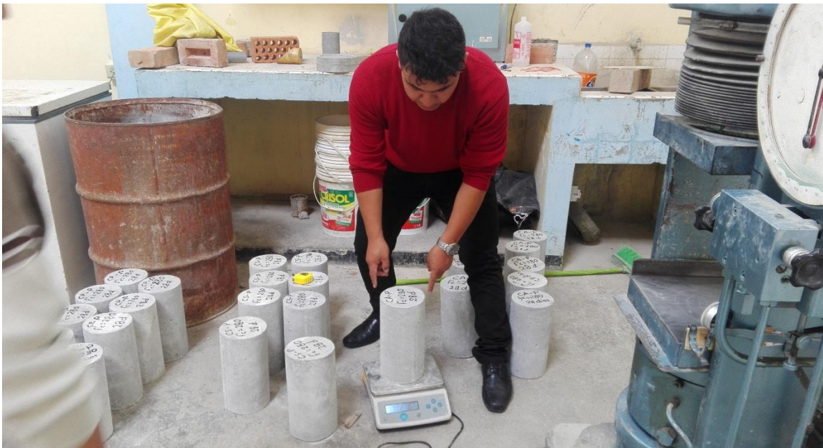
FOTO N°10: Pesaje de especímenes de concreto previo a la realización del ensayo de resistencia a la compresión de especímenes de concreto.
