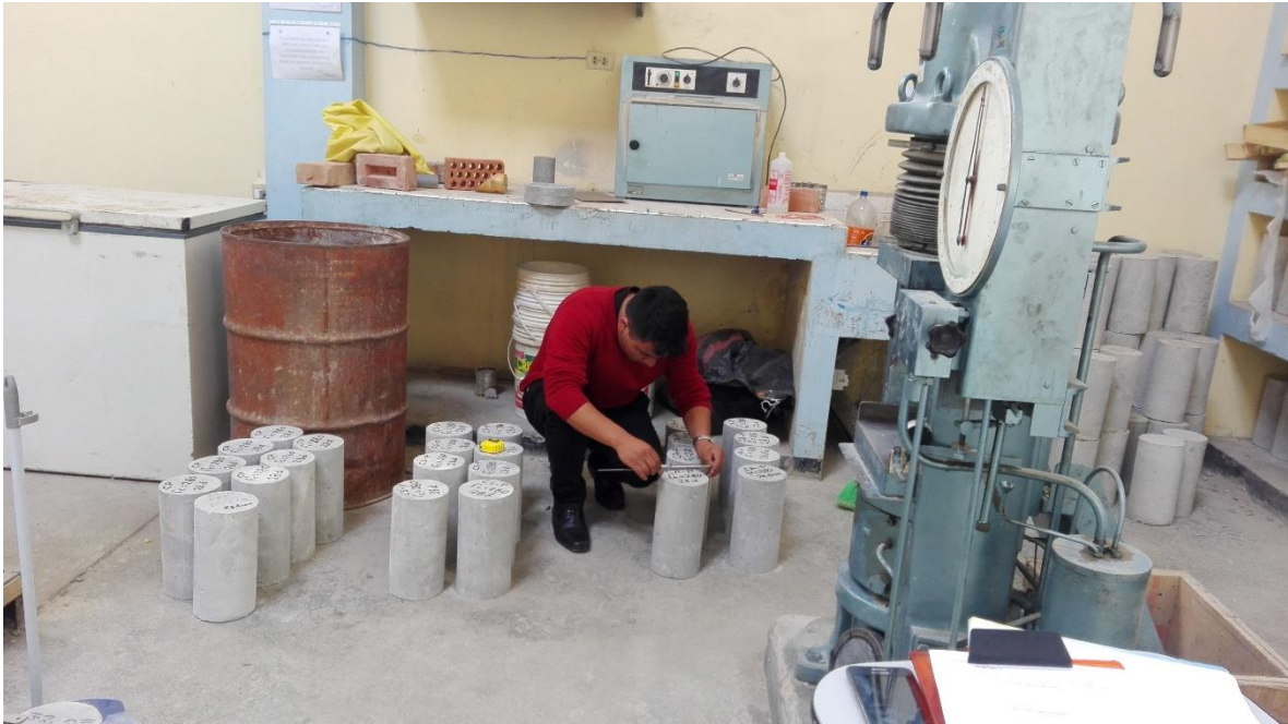
FOTO N°09: Recopilación de información previa a la realización del ensayo de resistencia a la compresión de especímenes de concreto.
