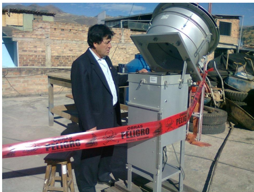
Figura 7. Equipo de volumen (HiVOI), para la obtención de PM_{10} y un Kit de conversión en partículas menores de PM_{2,5} en la estación de la Colmena Baja-Municipalidad Provincial de Cajamarca.
