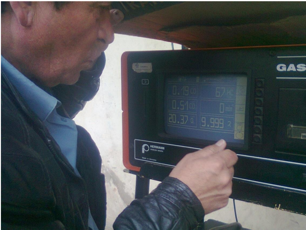
Figura 1. Analizador de gases de monóxido de carbono (CO).ubicada en la Av. Hoyos Rubio.
