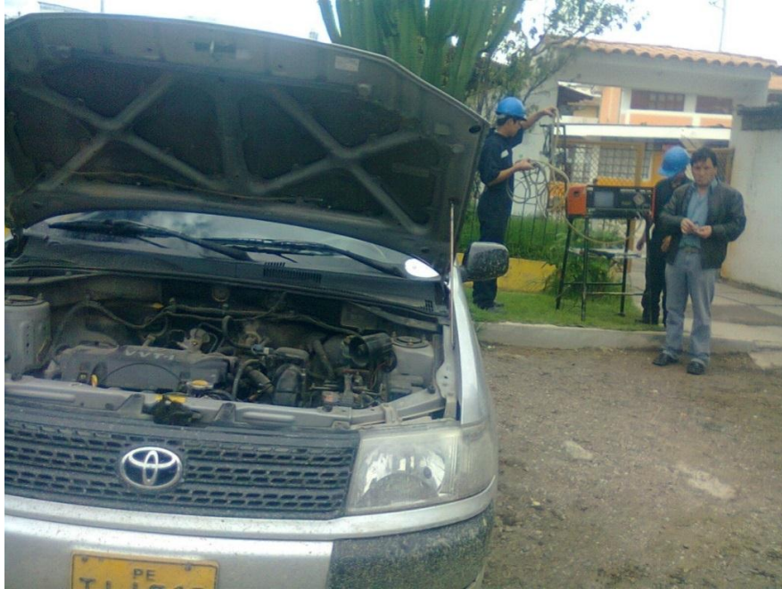
Figura 3. Analizador de gases de monóxido de carbono (CO, ubicada en la plazuela de San Pedro nos permite verificar que no está contaminando el medio ambiente porque el CO es cero.
