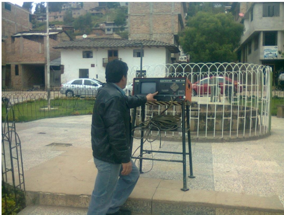
Figura 6. Analizador de gases de monóxido de carbono CO, ubicado en la plazuela de Chontapaccha,
