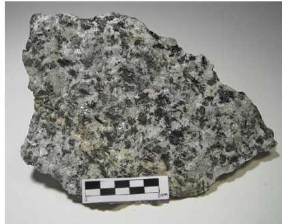
Figura 14. Muestra de granodiorita biotítica. España. (Ancochea; 2013).
