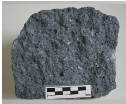
Figura 18. Muestra de andesita con matriz afanítica. España. (Ancochea; 2013).
