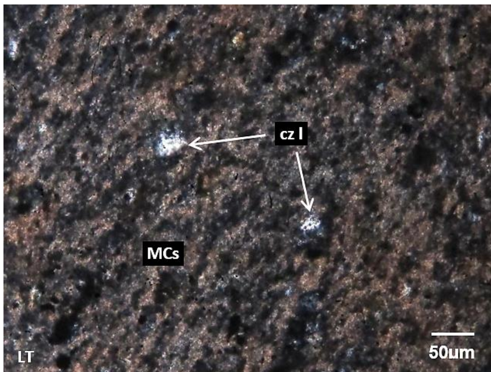
Figura 44. Fotomicrografía de partes de la sección donde se observa mayor presencia de micas (MCs); con pequeños cristales de cuarzo I (cz I) diseminados.
