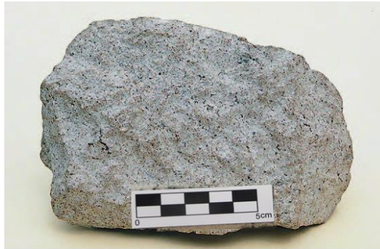
Figura 13. Muestra riolita con matriz afanítica. España. (Ancochea; 2013).
