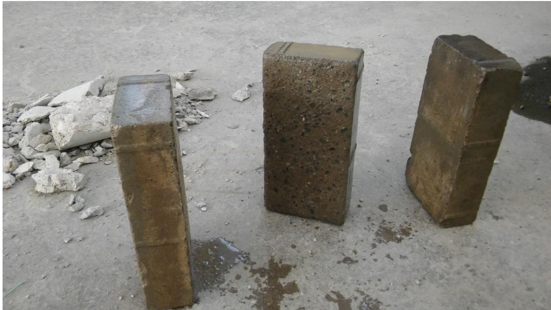
FOTO 09: Tipo de Adoquín de Concreto Utilizado en la Pavimentación de las Calles en Estudio
