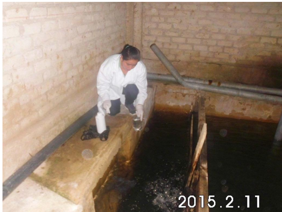
Figura 16. Toma de muestra de agua en la captación del sistema de agua potable de Sucre
