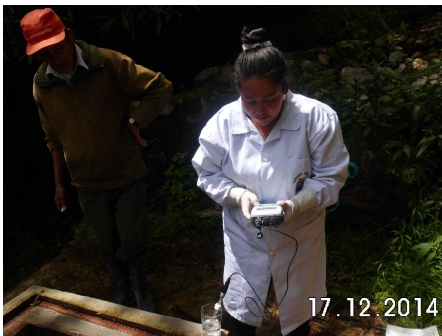
Figura 14. Calibración del equipo multiparámetros
