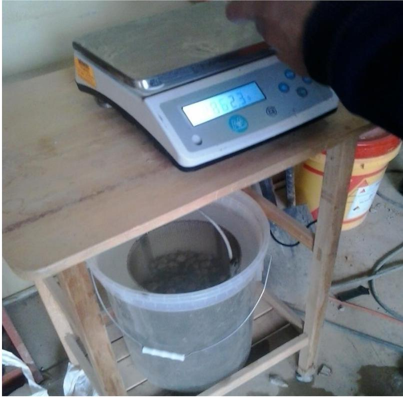
*Imagen N° 21: Peso Específico del Agregado Grueso*
