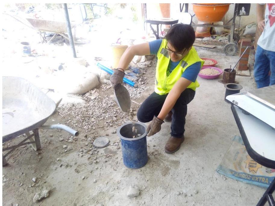
*Imagen N° 20: Peso Unitario Seco Suelto del agregado*
