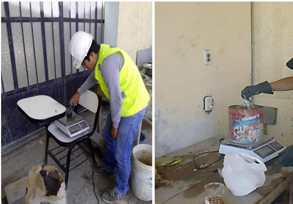
*Imagen N° 24: Medición del aditivo Masterglenium® SCC 3800 y fibra sintética*
