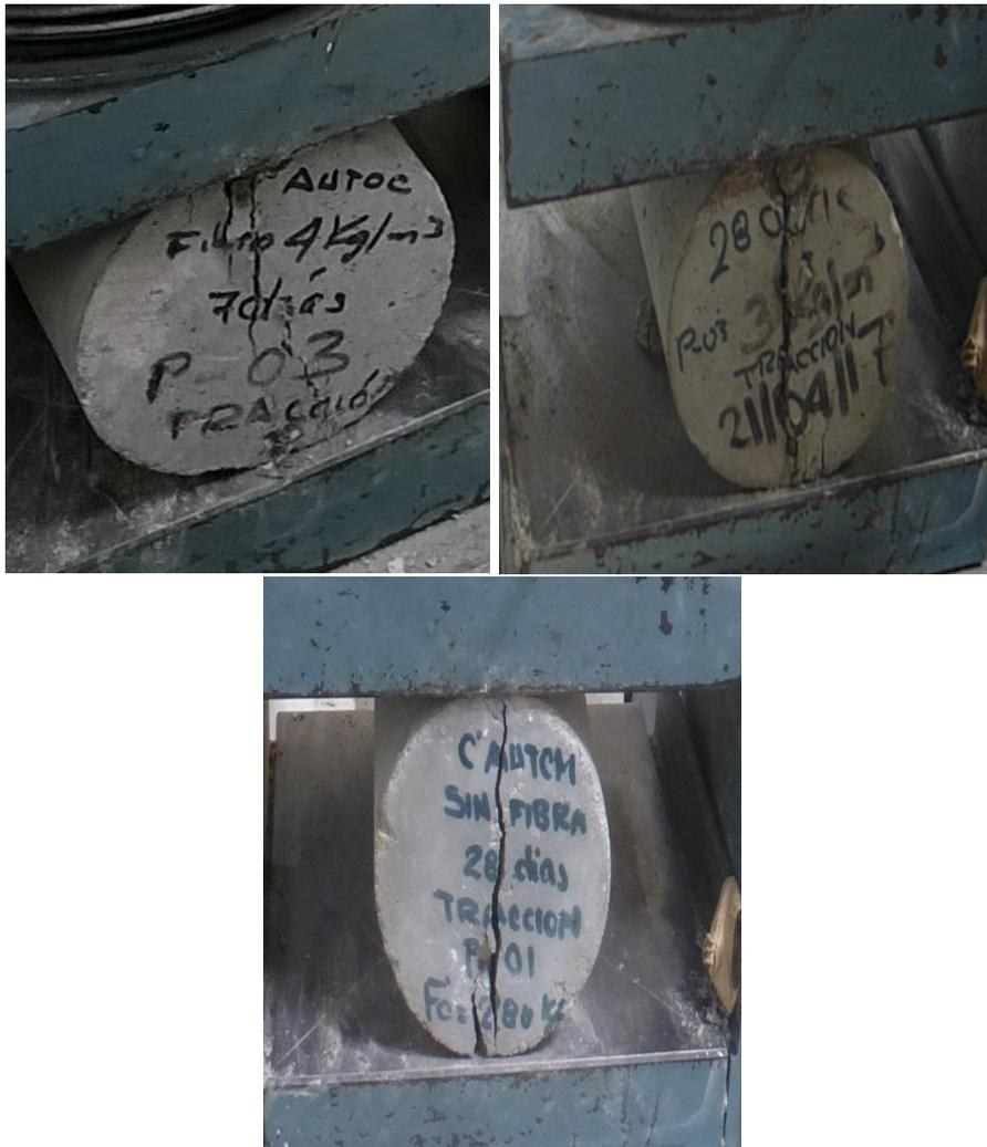
Imagen N° 35: Fallas típicas de las probetas ensayadas a tracción indirecta
