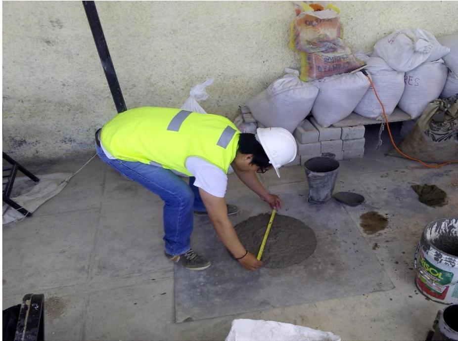
*Imagen N° 27: Medición de la extensión de flujo (propiedades en estado fresco).*
