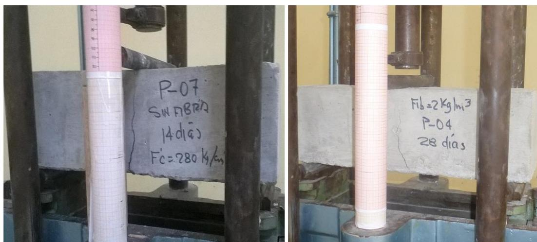
*Imagen N° 37: Fallas típicas de las probetas prismáticas ensayadas a flexión*
