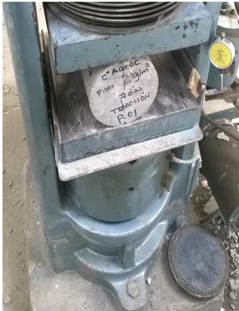
Imagen N° 34: Ensayo a tracción indirecta de las probetas cilíndricas de concreto
