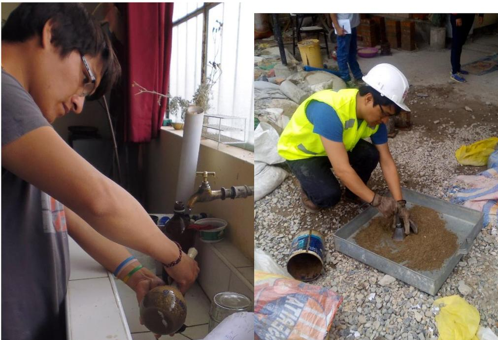
*Imagen N° 22: Peso Específico del Agregado Fino*
