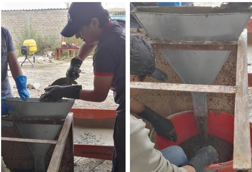
De este ensayo se determina el parámetro  $t_v$ , que es el tiempo en que tarda en salir la mezcla de concreto autocompactante del embudo y la clase de viscosidad.
