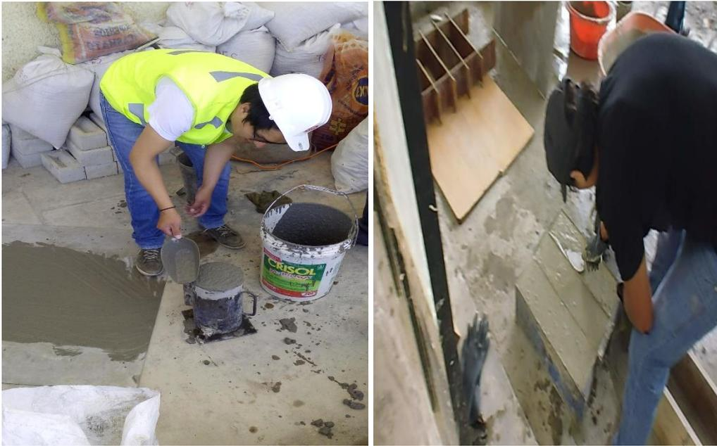
*Imagen N° 29: Elaboración de los especímenes de concreto.*
