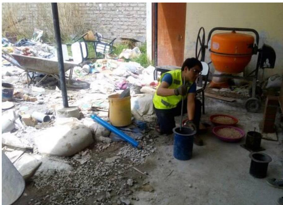
*Imagen N° 19 : Peso Unitario Seco Compactado del Agregado*
