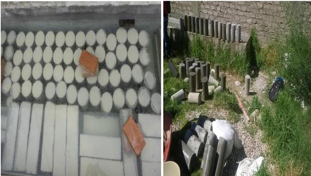
*Imagen N° 30: Curado y extracción de las probetas para sus respectivos ensayos en estado endurecido.*
