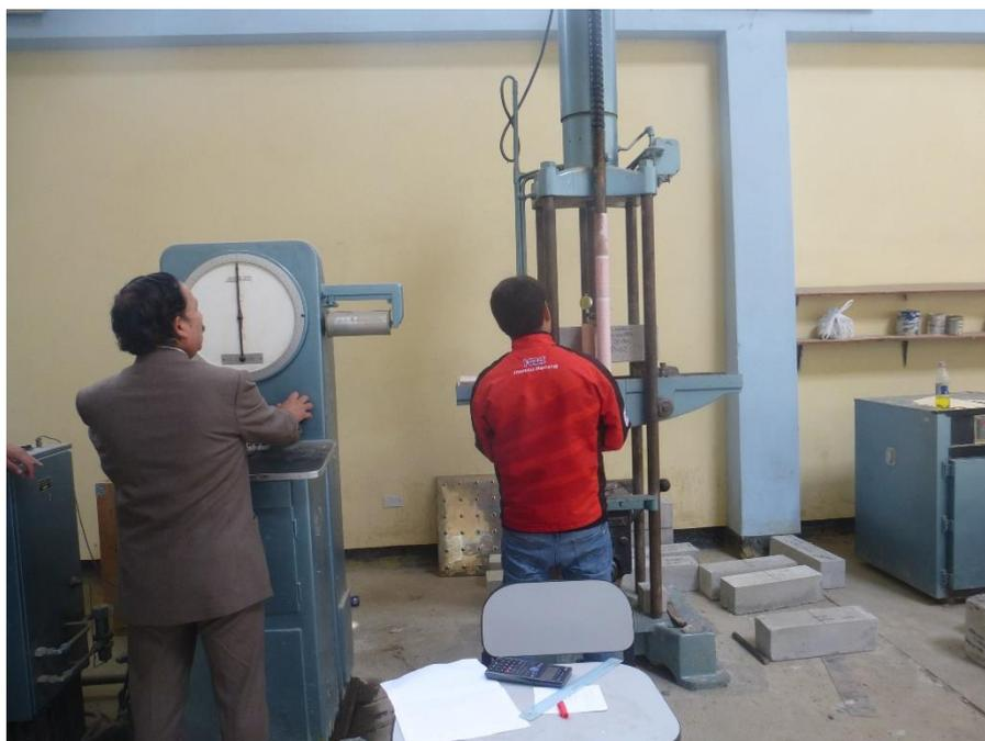
*Imagen N° 36: Ensayo a flexión de las probetas prismáticas.*
