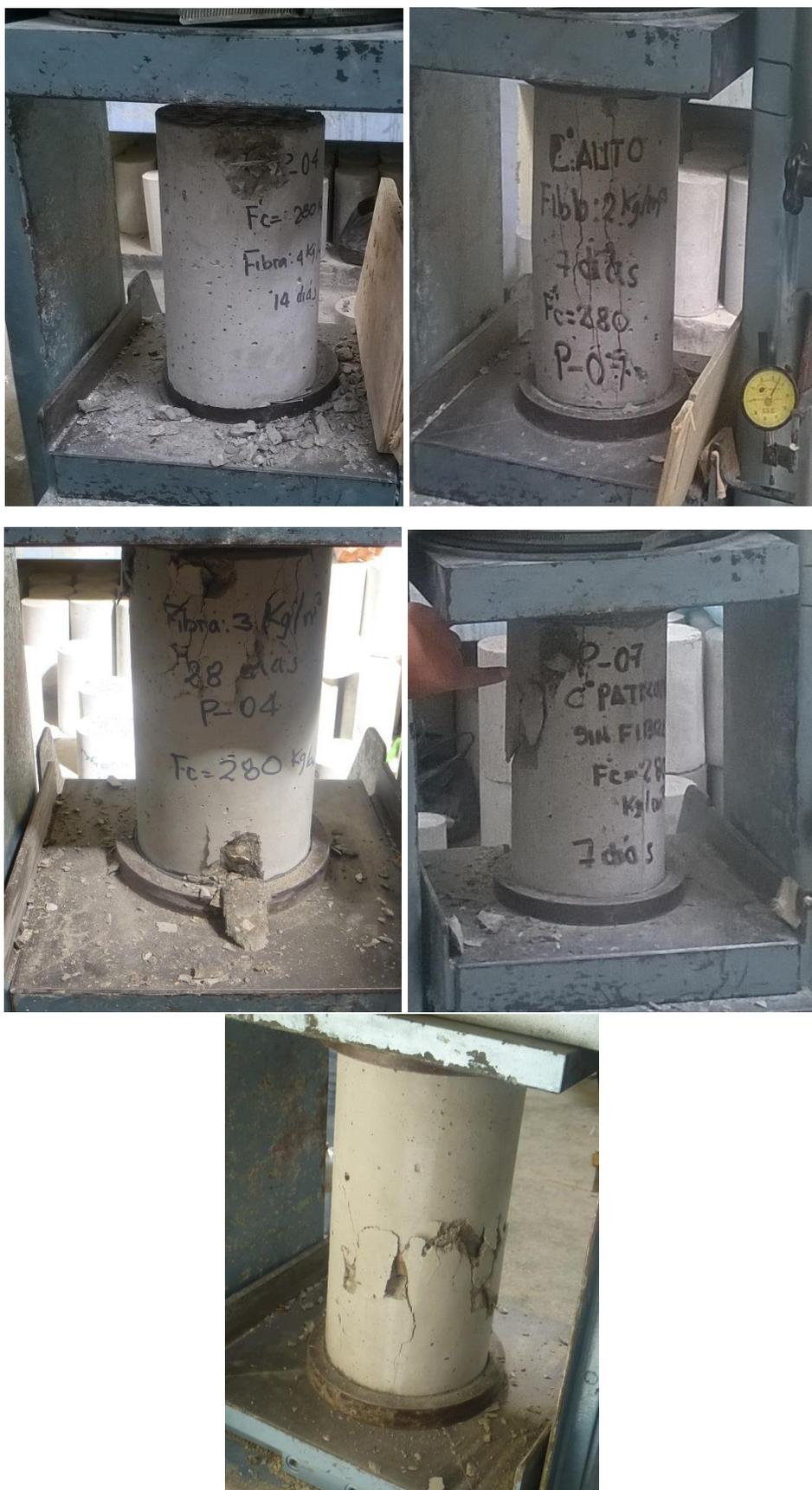
Imagen N° 33: Fallas típicas de las probetas ensayadas a compresión.
