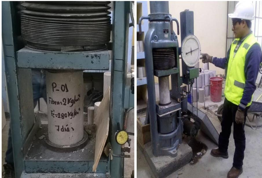
*Imagen N° 31: Ensayo a compresión de las probetas cilíndricas*
