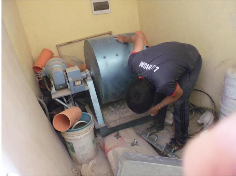
*Imagen N° 23: Ensayo de abrasión en la maquina loa Ángeles*
