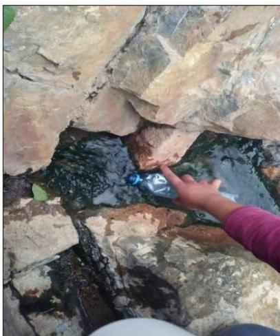
Foto 16. Medición de caudal de cada punto de muestreo por el método volumétrico.
