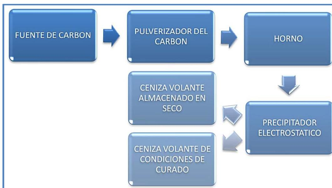
**Figura 2.** Proceso de Obtención de la Ceniza Volante
