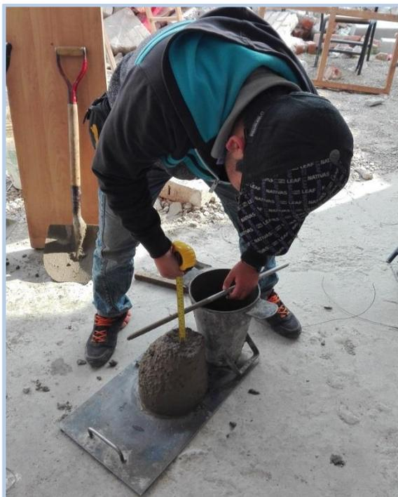
**Figura 34.**Medición del asentamiento de la mezcla de concreto.
