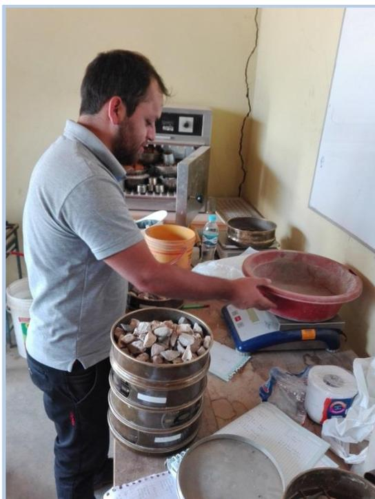
**Figura 29.** Ensayo de granulometría del agregado grueso.
