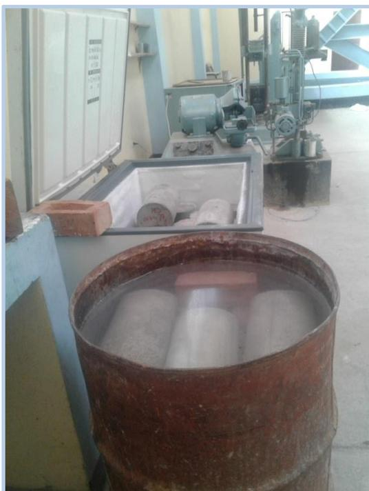
**Figura 37.**Curado de especímenes de concreto.
