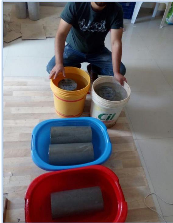
**Figura 40.** Saturación de especímenes de concreto para el ensayo de absorción y porosidad
