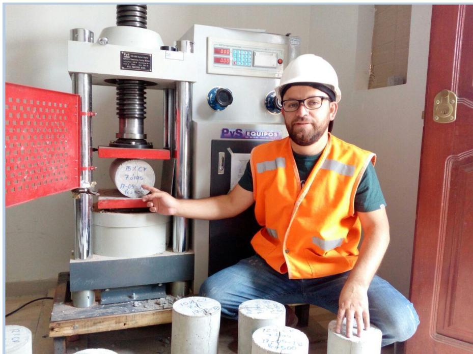
**Figura 43.** Falla del espécimen cilíndrico con adición del 15% de ceniza volante después del ensayo a tracción
