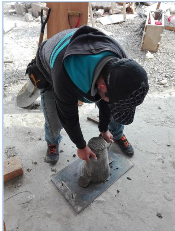
**Figura 33.**Ensayo para determinar el asentamiento de la mezcla de concreto.
