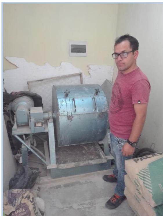
**Figura 31.**Ensayo para determinar el desgaste a la abrasión del agregado grueso.
