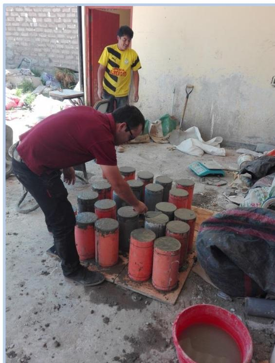
**Figura 35.**Elaboracion de especímenes de concreto.
