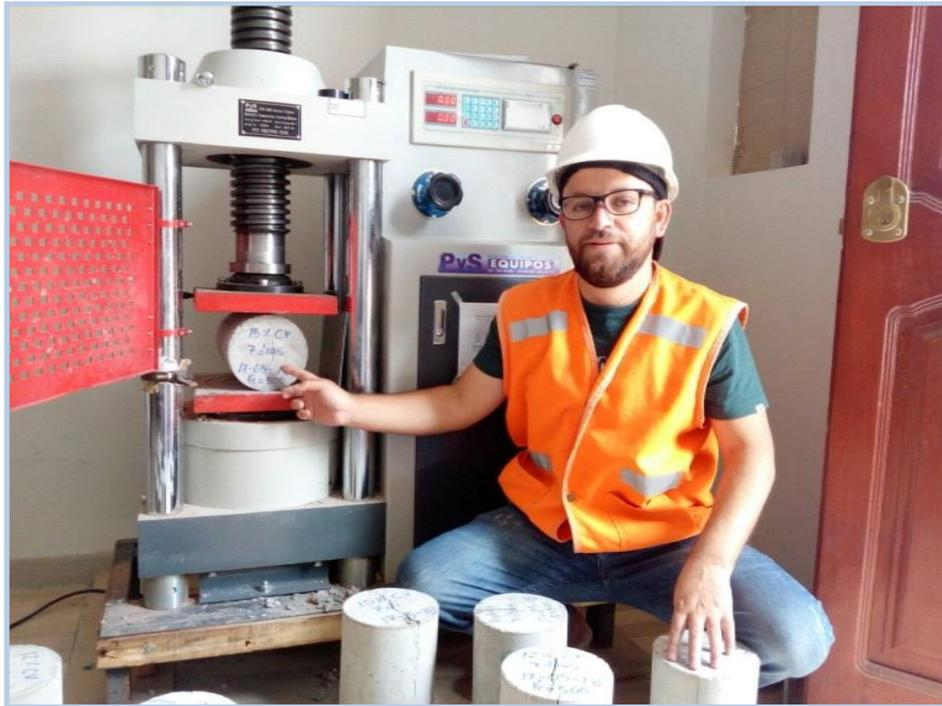
**Figura 42.** Ensayo a tracción de los especímenes cilíndricos de concreto a edad de 7 días
