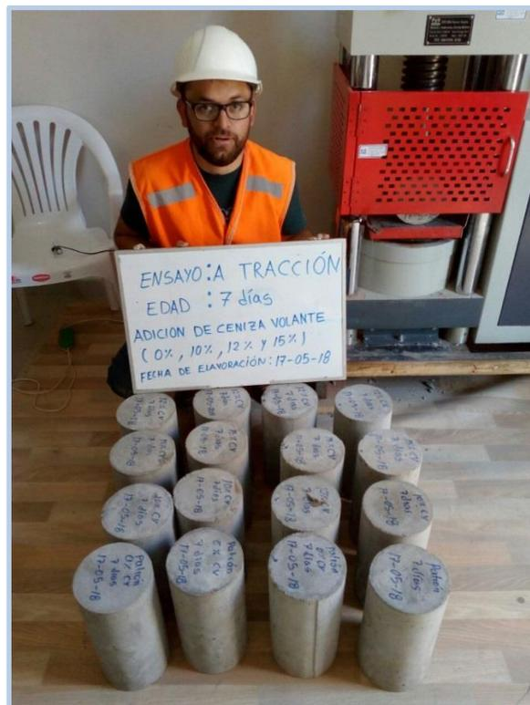
**Figura 41.** Especímenes cilíndricos para el ensayo de tracción en el concreto
