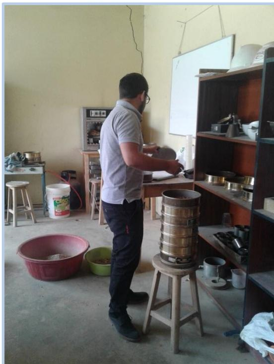
**Figura 28.** Ensayo de granulometría del agregado fino
