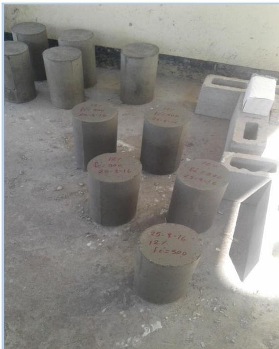
**Figura 36.**Desencofrado y codificación de los especímenes de concreto.
