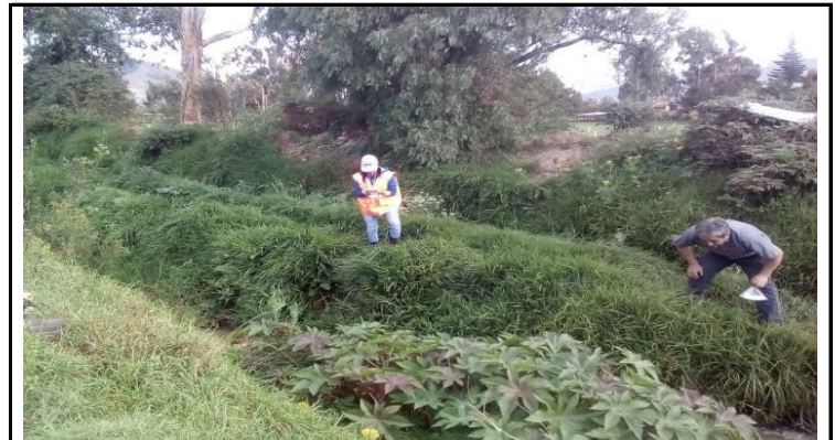
FOTO 06 Aforo - Medicion de tiempos - metodo de flotador
