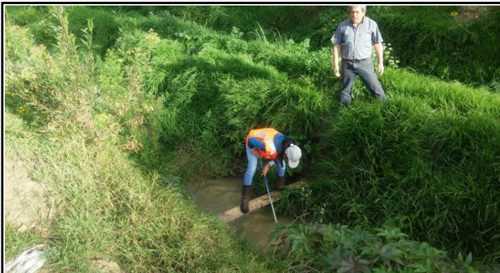
FOTO 05: Aforo - Medicion de progresivas y tirantes
