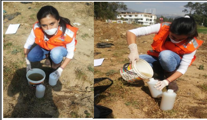
FOTO 09: Extracción de la muestra para medición de parámetros in-situ
