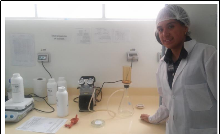
FOTO 18 Ensayo de Sólidos Suspendidos Totales
