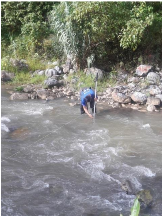
Figura 40 y Figura 41.- Midiendo tirantes de agua y velocidades en la sección del río Chirimayo a la altura de 2393 msnm.
