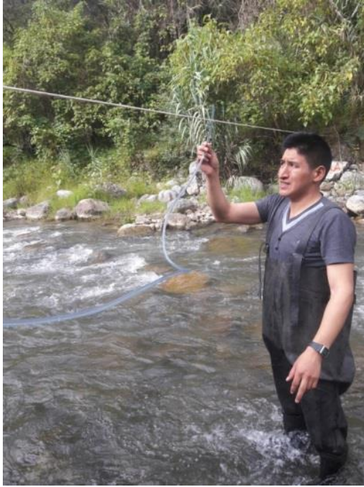
Figura 38 y Figura 39.- Nivelación y medición de alturas en la sección de aforo del río Chirimayo a la altura de 2393 msnm.
