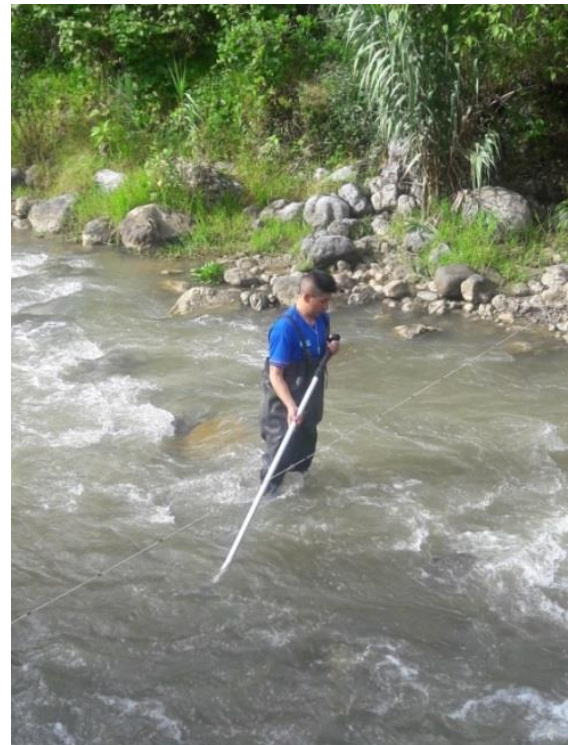
Figura 40 y Figura 41.- Midiendo tirantes de agua y velocidades en la sección del río Chirimayo a la altura de 2393 msnm.
