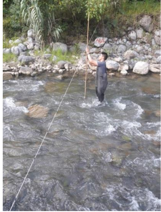
Figura 38 y Figura 39.- Nivelación y medición de alturas en la sección de aforo del río Chirimayo a la altura de 2393 msnm.
