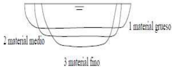
Figura N° 14. Relación caudal, profundidad y ancho de río.
