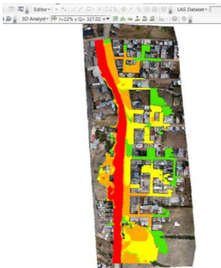
Figura N° 66. Identificación de zonas inundables asociadas a la intensidad de peligro según el INDECI en Arcgis 10.4
