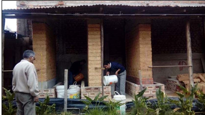
Figura N° 59: Llenado de la Poza 03 para el ensayo de Inundación simulada del Muro Estabilizado ME.
