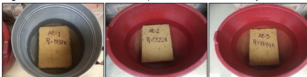
Figura N° 27: Adobes estabilizados después de las 24 horas del ensayo de absorción.
