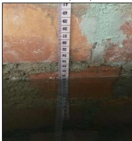
Figura N° 65: Lectura Día 02 a las 16:30 de ascenso (Capilaridad) sobre el Muro ML (32.70).
