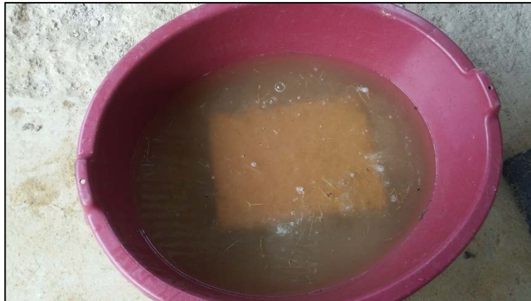
Figura N° 24: Adobe expuesto al factor erosivo del agua.
