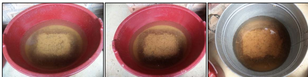
Figura N° 22: Adobes después de las 24 horas del ensayo de absorción.
