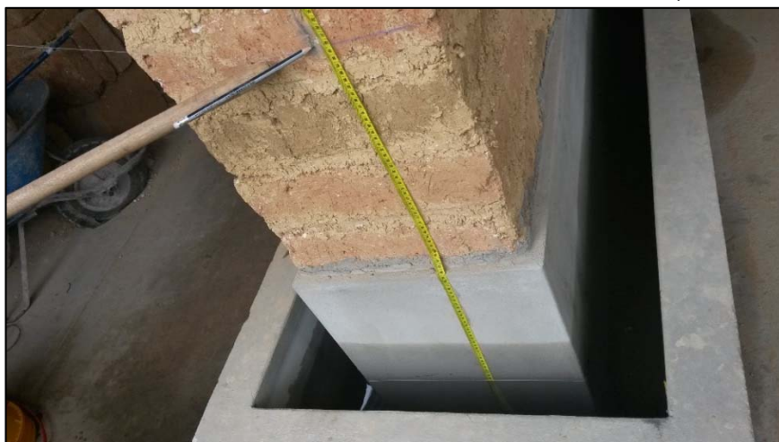
Figura N° 56: Muro MT al terminar el Periodo corto de Inundación (Cara Frontal).
