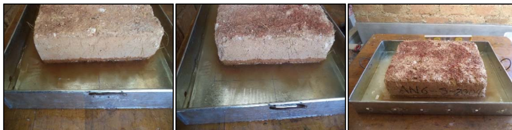
Figura N° 36: Adobes en el ensayo de succión.
