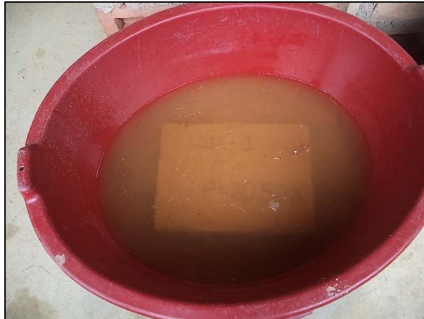
Figura N° 21: Adobe durante el ensayo de absorción.
