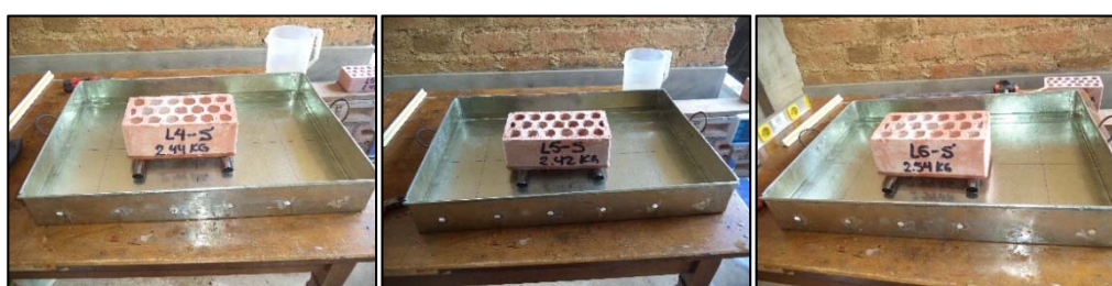
Figura N° 42: Ladrillos KK de arcilla Industrial en el ensayo de succión.
