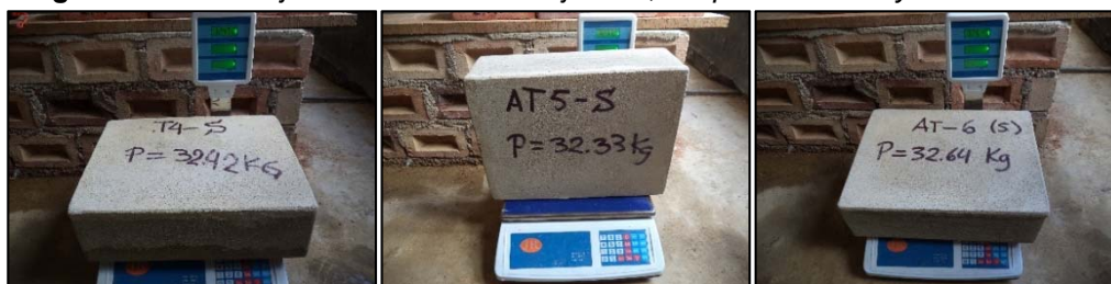
Figura N° 41: Pesaje de los adobes tarrajeados, después del ensayo de succión.
