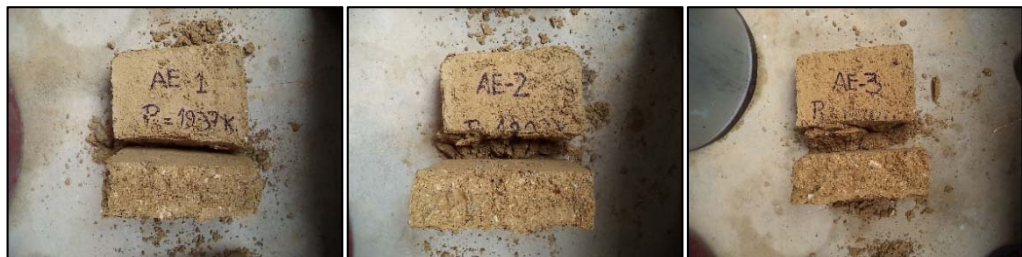
Figura N° 29: Interior de adobes estabilizados después de las 24 horas del ensayo de absorción.
