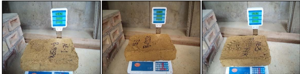
Figura N° 28: Pesaje de adobes estabilizados después de las 24 horas del ensayo de absorción.
