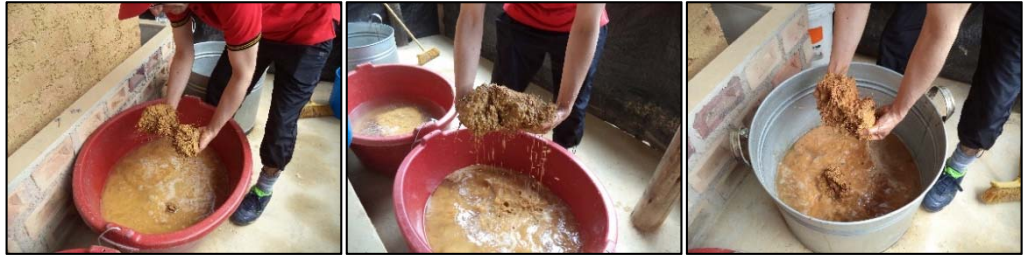
Figura N° 23: Adobes totalmente desintegrados después del ensayo de absorción.
