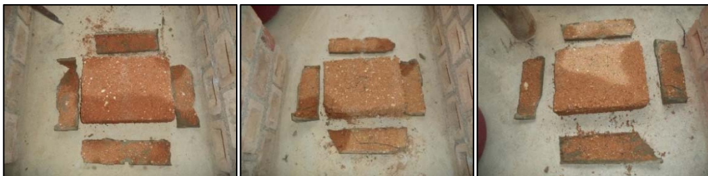
Figura N° 33: Núcleo de adobes con humedad después del retiro del tarrajeo exterior después del ensayo de absorción.
