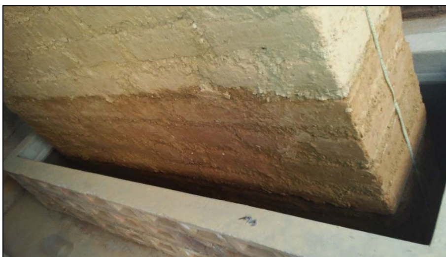
Figura N° 84: Muro estabilizado al término del Ensayo de Inundación Simulada.
