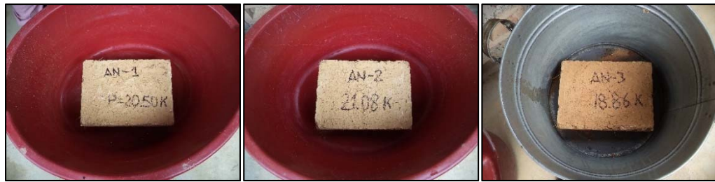
Figura N° 20: Adobes identificados antes de iniciar el ensayo de Absorción.
