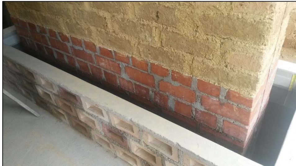
Figura N° 67: Muro ML después del Periodo Corto de Inundación.
