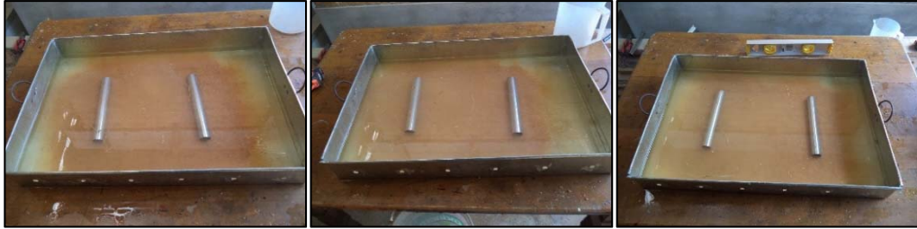
Figura N° 37: Partículas de material de adobes al fondo de la bandeja al terminar el ensayo de succión.
