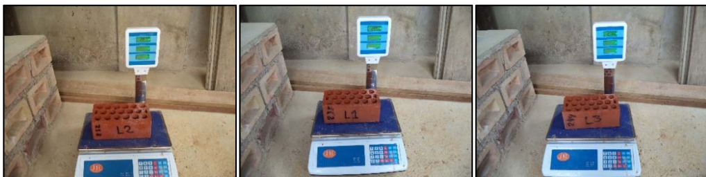
Figura N° 35: Pesaje de ladrillos KK de arcilla industrial después del ensayo de absorción.
