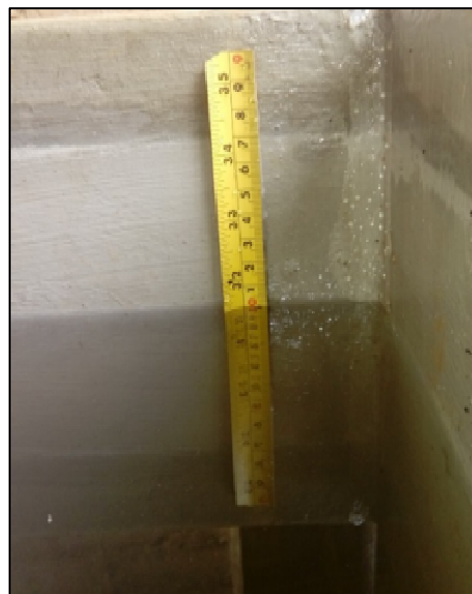
Figura N° 50: Cinta métrica para las lecturas de descenso en la poza P2 del Muro MT.
