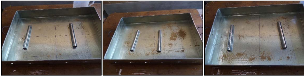
Figura N° 39: Bandejas al finalizar el ensayo de succión en adobes estabilizados.
