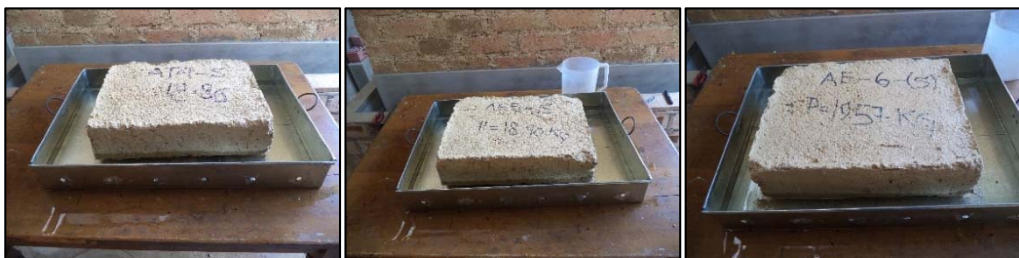
Figura N° 38: Adobes estabilizados en el ensayo de succión.
