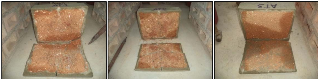
Figura N° 32: Retiro de una cara de los adobes tarrajeados, después de las 24 horas del ensayo de absorción para ver la humedad al interior del adobe.
