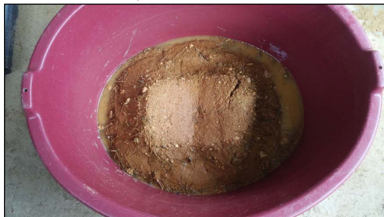
Figura N° 25: Adobe después de estar expuesto al factor erosivo del agua convertido en una masa pastosa e inconsistente después de 45 minutos.
