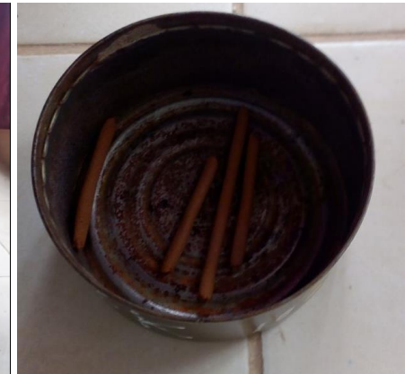
Foto 104 : Ensayo de límite plástico, elaborando cilindros de 3 mm de diámetro.
