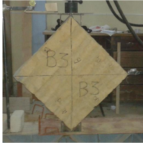
Foto 92 : Ensayo a compresión diagonal del murete del adobe estabilizado (Tipo B).
