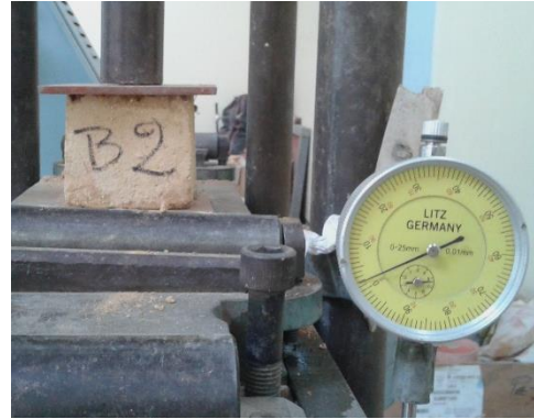
Foto 77 : Ensayo a compresión de la unidad (cubo) del adobe estabilizado (Tipo B)
