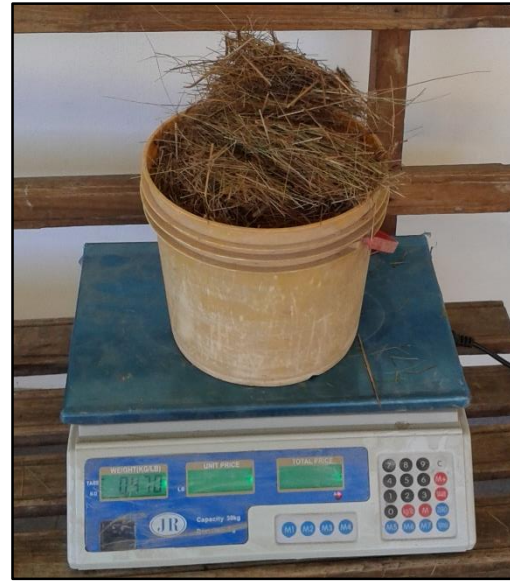
Foto 12 : Pesaje de paja ichu en la balanza analítica.
