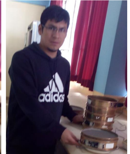
Foto 101 : Realización del ensayo granulométrico por tamizado por lavado.
