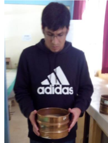
Foto 101 : Realización del ensayo granulométrico por tamizado por lavado.
