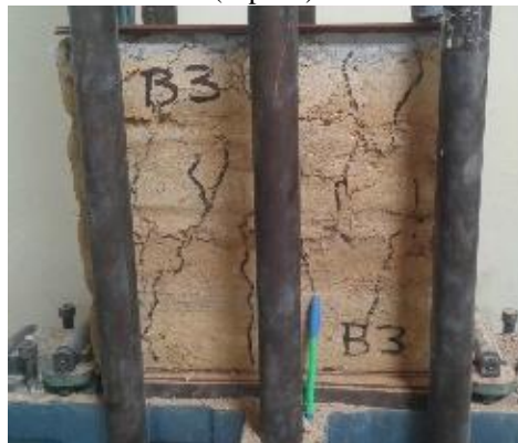
Foto 88 : Fallas que se presentan en el ensayo de las pilas de adobe (Tipo B)
