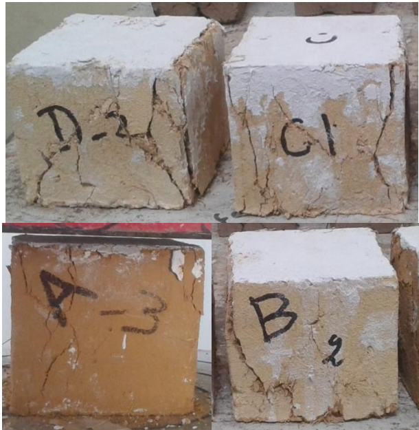
Foto 80 : Fallas que se presentan en el ensayo de los cubos de adobe.
