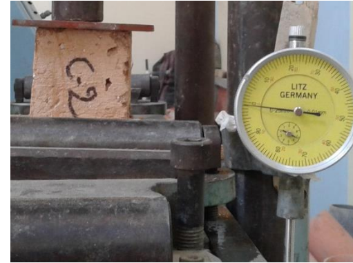
Foto 78 : Ensayo a compresión de la unidad (cubo) del adobe estabilizado (Tipo C)
