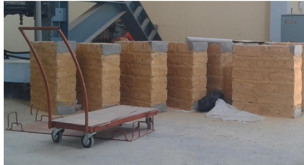
Foto 69 : Plataforma metálica y carro metálico elaborados especialmente para trasladar los muretes para ensayo.
