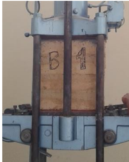
Foto 84 : Ensayo a compresión de la albañilería (pila) del adobe estabilizado (Tipo B)
