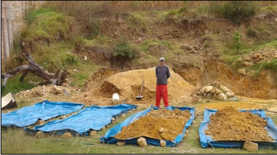
Foto 25 : Se aprecia la tierra excavada para pilas y muretes de adobe, junto a pozas de plástico para cada de espécimen de adobe tipo A, B, C y D.
