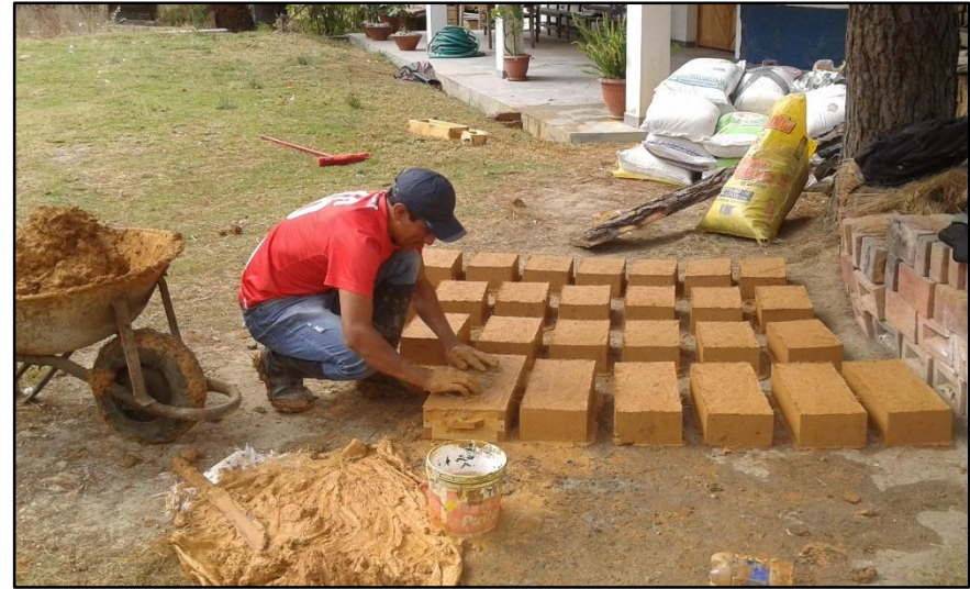
Foto 41 : Elaboración de especímenes de adobe para muretes, dimensiones internas de adobera M3 Y M4.
