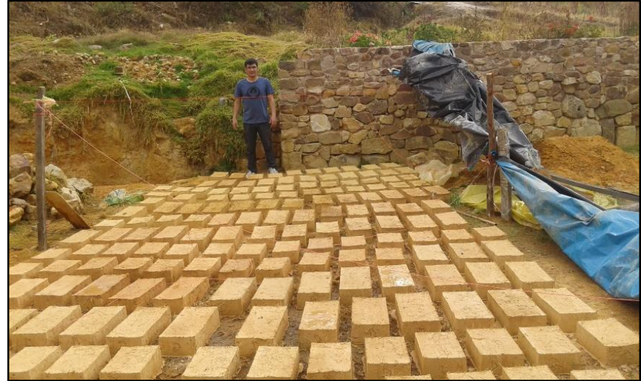
Foto 53 : Adobes convencionales y estabilizados para elaboración de muretes, después del proceso de secado.
