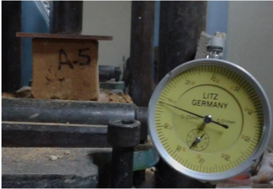
Foto 76 : Ensayo a compresión de la unidad (cubo) del adobe convencional (Tipo A)
