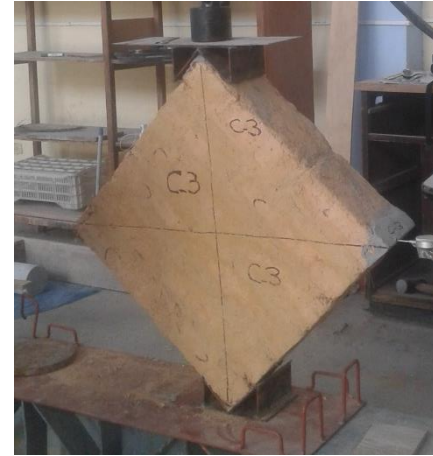
Foto 93 : Ensayo a compresión diagonal del murete del adobe estabilizado (Tipo C).
