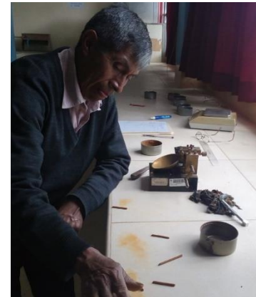
Foto 104 : Ensayo de límite plástico, elaborando cilindros de 3 mm de diámetro.
