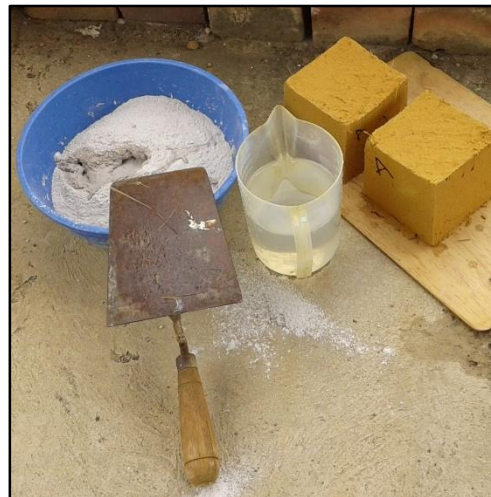
Foto 23 Enrazamiento de la cara superior con yeso de las unidades de adobe (cubos).
