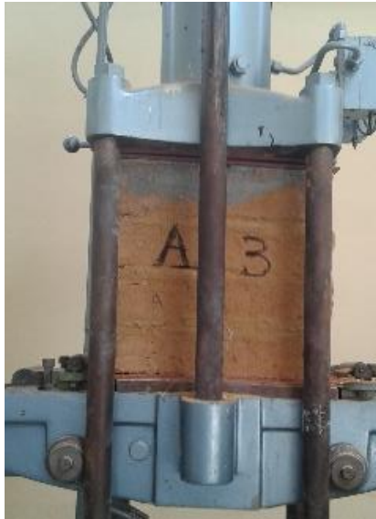
Foto 83 : Ensayo a compresión de la albañilería (pila) del adobe convencional (Tipo A).
