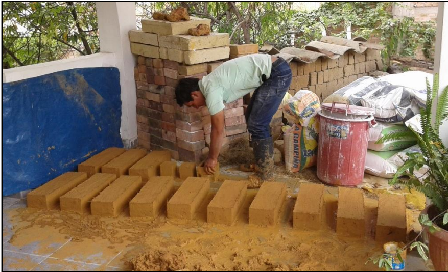
Foto 42 : Elaboración de especímenes de adobe para cubos y pilas, dimensiones internas de adobera M1 Y M2
