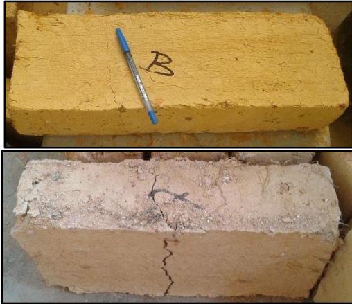
Foto 60 : Presencia de fisuras debido a su traslado o mala manipulación.
