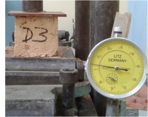
Foto 79 : Ensayo a compresión de la unidad (cubo) del adobe estabilizado (Tipo D)
