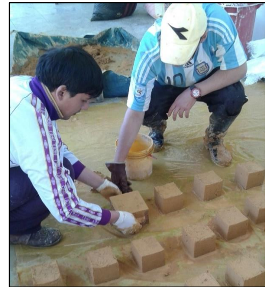
Foto 19 Desmoldeo de Unidades de adobe (cubos)
