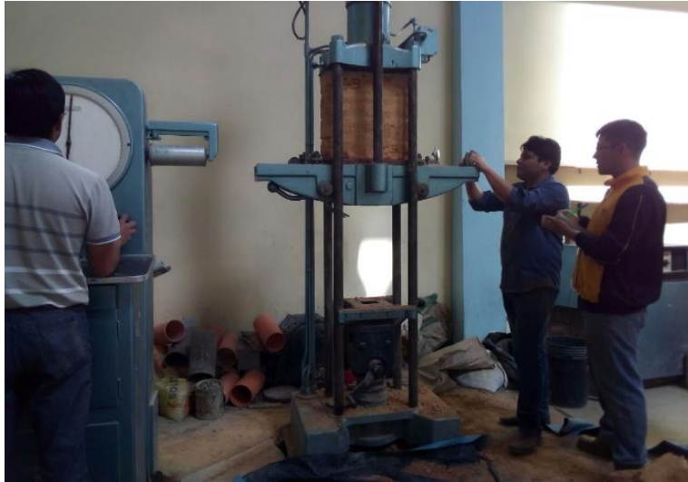
Foto 105 : Ensayo a compresión de la albañilería (pila) en máquina de tracción universal, toma de deformación vertical y tiempo.
