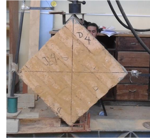
Foto 94 : Ensayo a compresión diagonal del murete del adobe estabilizado (Tipo D).
