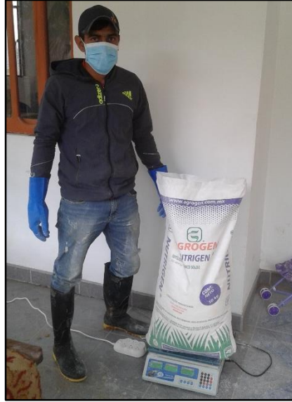
Foto 30 : Peso de cal apagada en balanza analítica, para elaboración de adobes estabilizados
