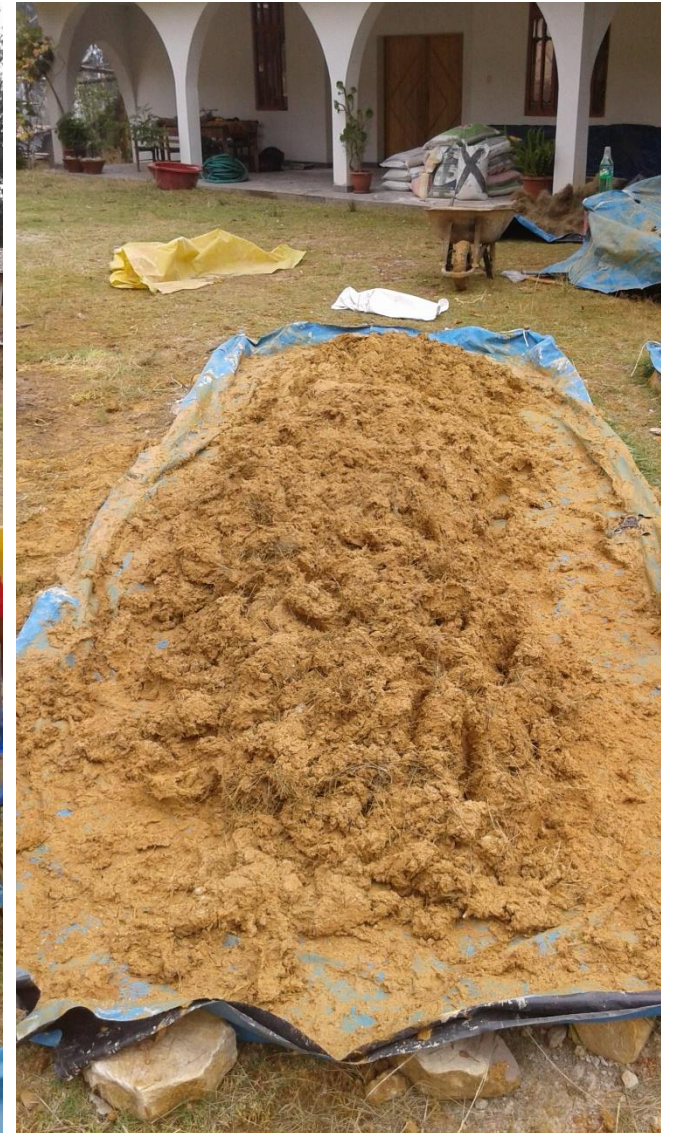
Foto 39 : Barro en su etapa final listo para la elaboración de adobes estabilizados.
