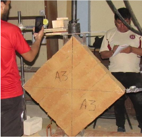
Foto 91 : Ensayo a compresión diagonal del murete del adobe convencional (Tipo A).
