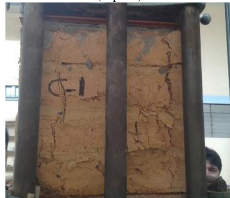
Foto 89 : Fallas que se presentan en el ensayo de las pilas de adobe (Tipo C)
