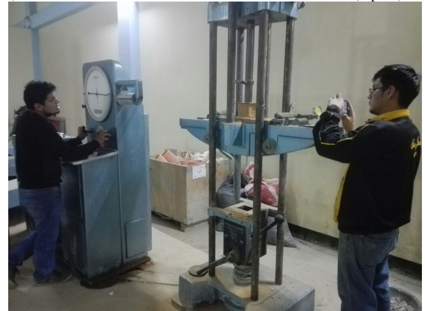
Foto 82 : Ensayo a compresión de la unidad (cubo) en máquina de tracción universal, toma de deformación vertical y tiempo.
