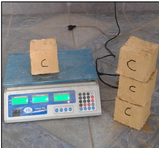
Foto 22 : Toma de peso seco de las unidades de adobe (cubos).
