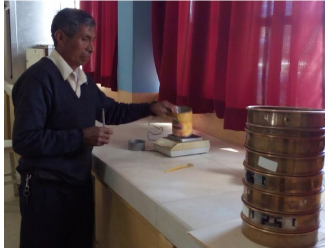
Foto 100 : Realización del ensayo granulométrico por tamizado por lavado.
