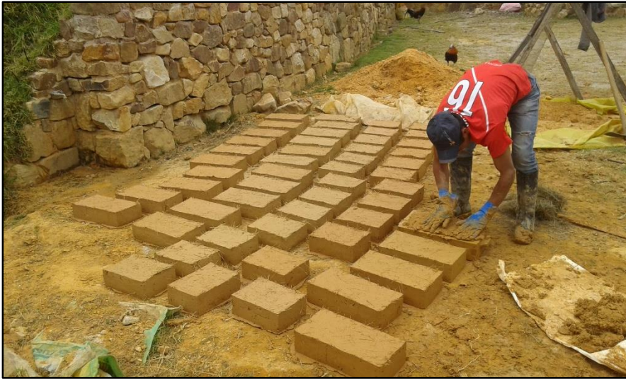
Foto 40 : Elaboración de especímenes de adobe para muretes, dos adobes de diferente tamaño.
