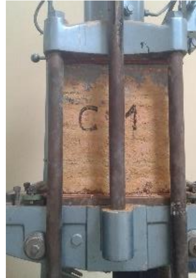
Foto 85 : Ensayo a compresión de la albañilería (pila) del adobe estabilizado (Tipo C)
