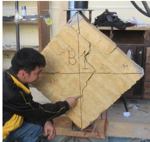
Foto 96 : Fallas diagonales y del mortero que se presentan en el ensayo de los muretes de adobe (Tipo B)
