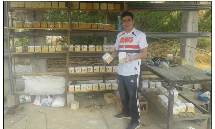
Foto 24 : Proceso de secado de las unidades de adobe.
