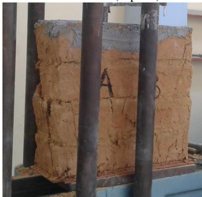
Foto 87 : Fallas que se presentan en el ensayo de las pilas de adobe (Tipo A)
