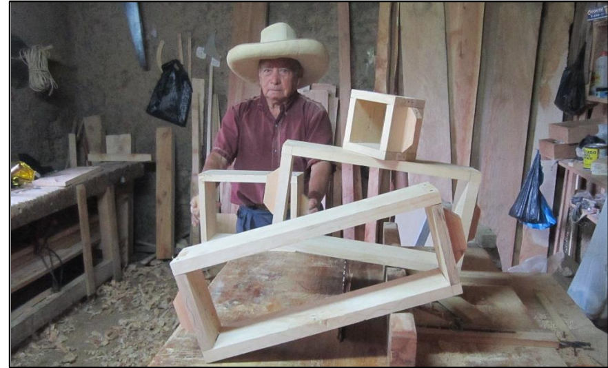
Foto 6 : Adoberas de pino para realizar los especímenes de adobe (unidad, pilas, muretes).
