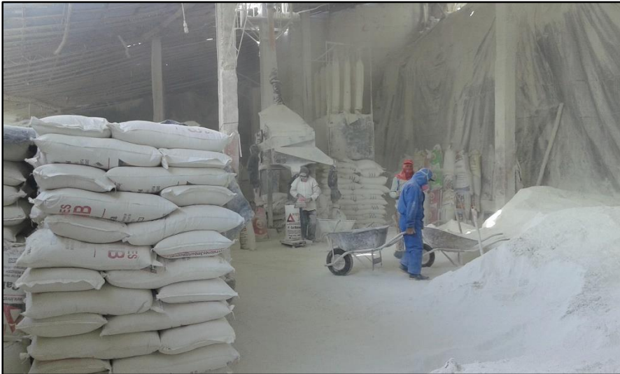
Foto 3 : Interior de un ambiente de la Empresa Minera El Progreso S.R.L., en pleno proceso de producción de óxido de calcio (cal viva).
