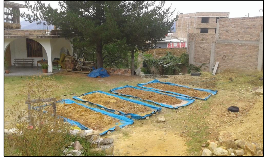
Foto 26 : Cuatro pozas de plástico con 1 ton de suelo y cal (0 %, 6%, 12% y 18 %) c/u para elaboración de pilas y muretes de adobe.
