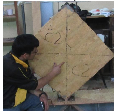
Foto 97 : Fallas diagonales que se presentan en el ensayo de los muretes de adobe (Tipo C)
