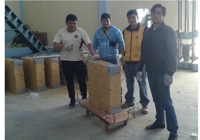
Foto 106 : Traslado de muretes en carro metálico para ensayo a compresión diagonal.
