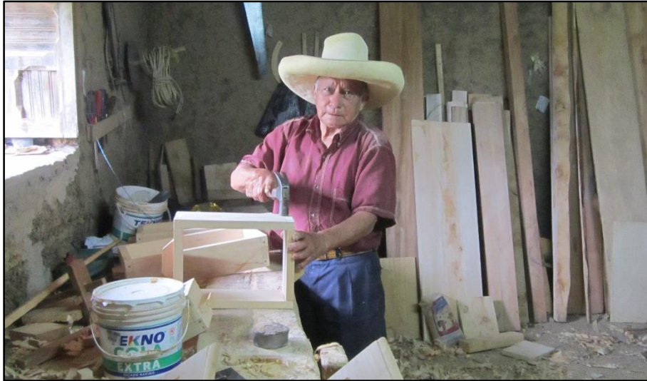
Foto 5 : El señor Amadeo Altamirano Díaz, experimentado carpintero elaborando las adoberas de madera pino.
