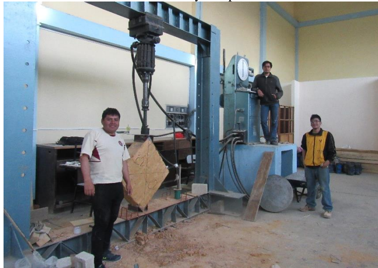
Foto 107 : Ensayo a compresión diagonal en pórtico de carga.
