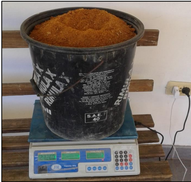
Foto 11 : Pesaje de suelo seco en la balanza analítica.
