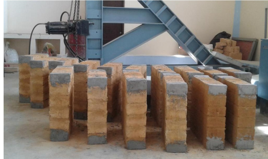
Foto 67 : Vista lateral de 16 muretes listos para ensayos a compresión diagonal.
