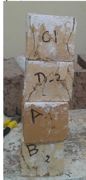
Foto 81 : Fallas que se presentan en el ensayo de los cubos de adobe.
