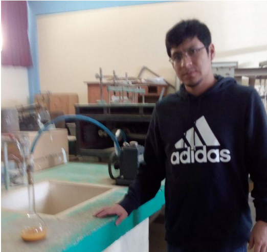
Foto 99 : Utilización de la bomba de vacíos para extraer el aire (ensayo del peso específico).
