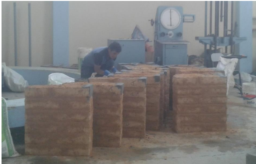
Foto 68 : Vista frontal de 16 muretes listos para ensayos a compresión diagonal.
