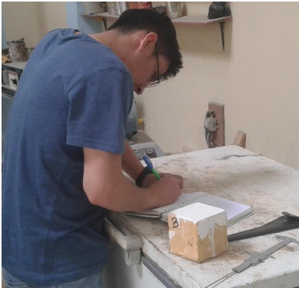
Foto 73 : Toma de medidas de unidades de adobe (cubos) con vernier.
