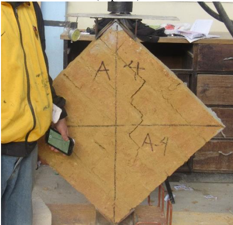
Foto 95 : Fallas diagonales y del mortero que se presentan en el ensayo de los muretes de adobe (Tipo A)
