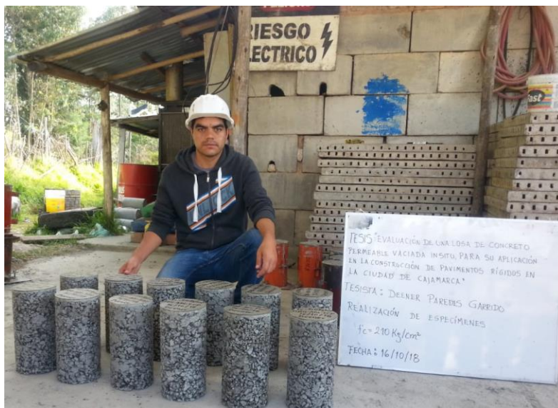
Fotografía 8. Especímenes de concreto permeable con aditivo y micro fibra.
