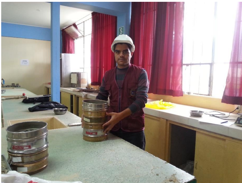
Fotografía 2. Ensayo de análisis granulométrico de los agregados.
