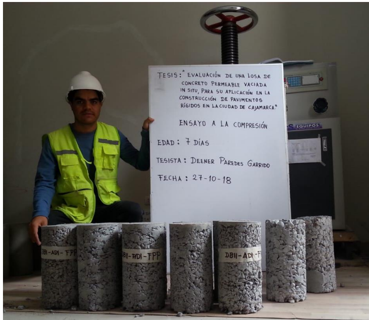
Fotografía 9. Ensayo a la compresión de probetas a los 7 días.
