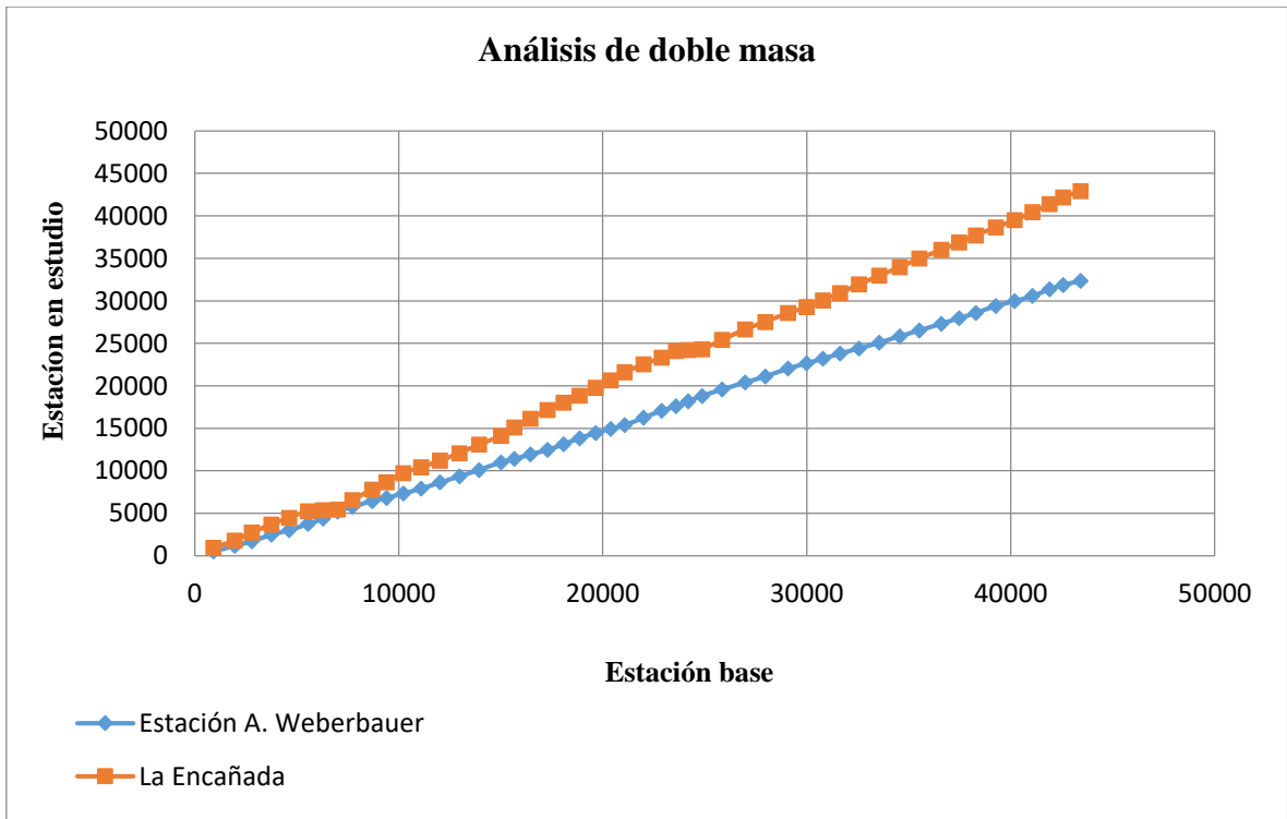
Figura 22.- Análisis de doble masa estación La Encañada
