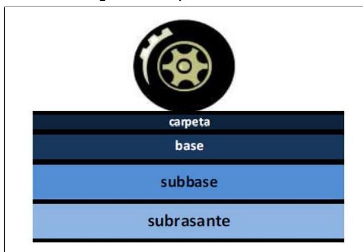
Esquema típico del paquete estructural de un pavimento flexible
