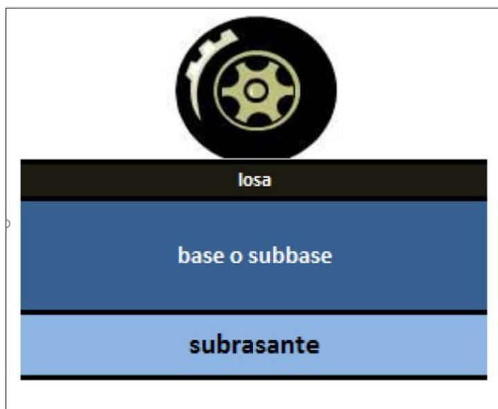
Esquema típico del paquete estructural de un pavimento
