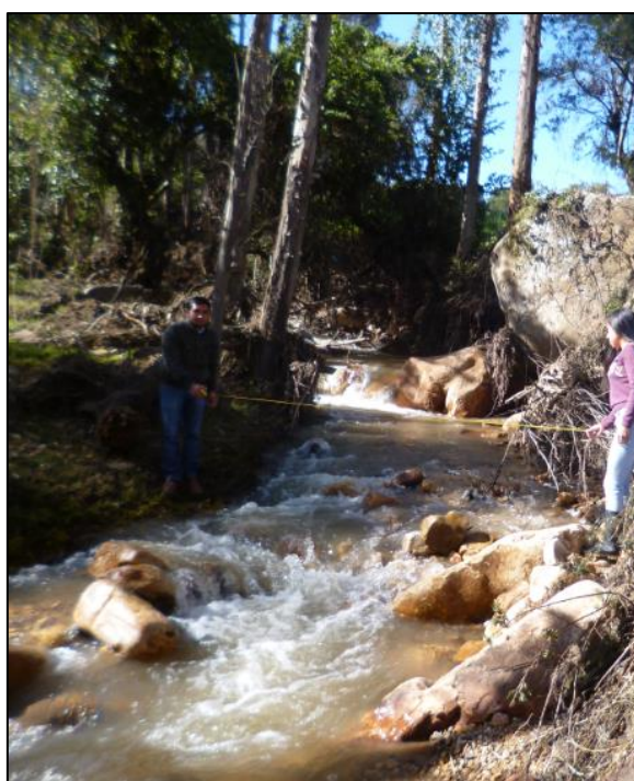
Foto N°27: Medida de anchura del río La Rinconada para determinación del caudal.
