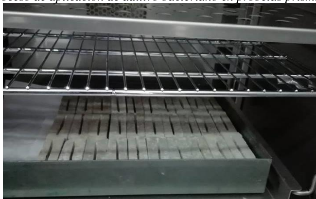
Figura 124: Proceso de incubación de aditivo bacteriano (cepas bacterianas) superficialmente por inyección por un periodo de 24 horas.
