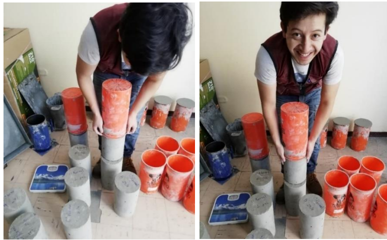
Figura 149: Desencofrado de probetas cilíndricas.
