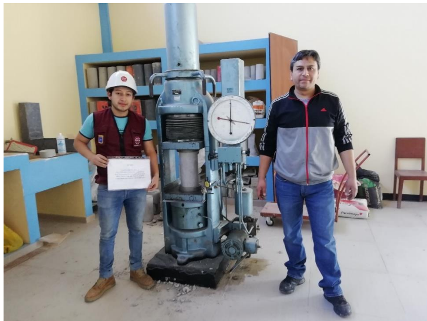
Figura 153: Ruptura de probetas cilíndricas a los 28 días. Izquierda: Tesista. Derecha: Encargado de laboratorio.
