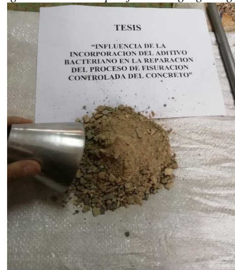
Figura 107: Determinación del agregado fino en la condición de las SSS.
