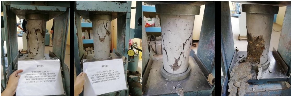
Figura 155: Ruptura de probetas cilíndricas a los 14 días. Vista de tipos y modos de falla.
