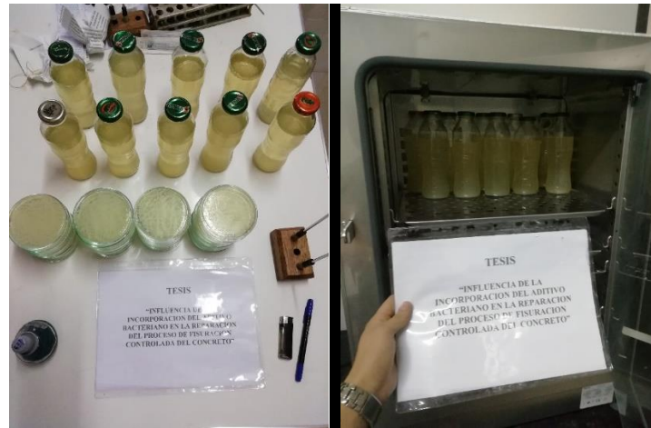
Figura 142: 1. Medio de cultivo esterilizado y placas Petri con medio de cultivo. 2. Incubación de aditivo bacteriano por 24 horas.
