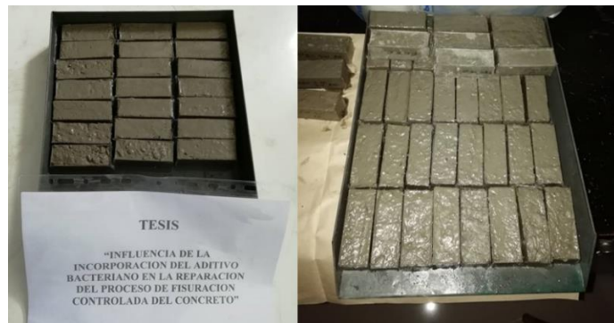
Figura 93: Probetas de concreto con adiciones bacterianas y sin adiciones bacterianas listas para el proceso de fragua.
