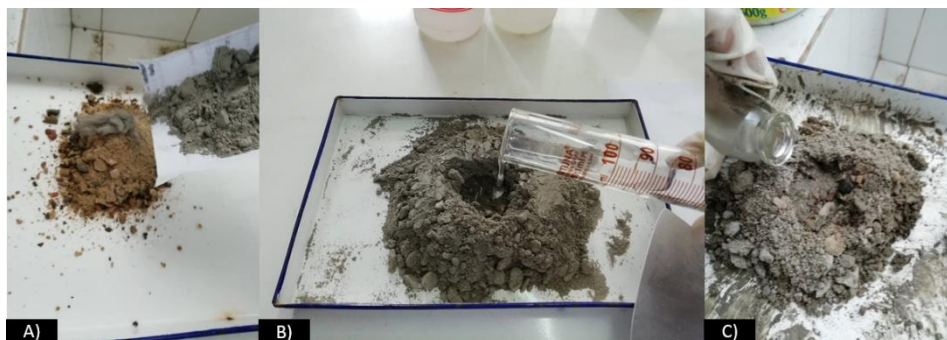
Figura 91: Proceso de elaboración de la mezcla. A) mezcla de materiales solidos arena y cemento. B) Adición de agua. C) Adición de aditivo Bacteriano.
