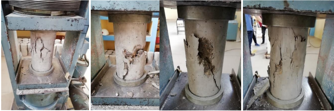
Figura 157: Ruptura de probetas cilíndricas a los 7 días. Vista de tipos y modos de falla.
