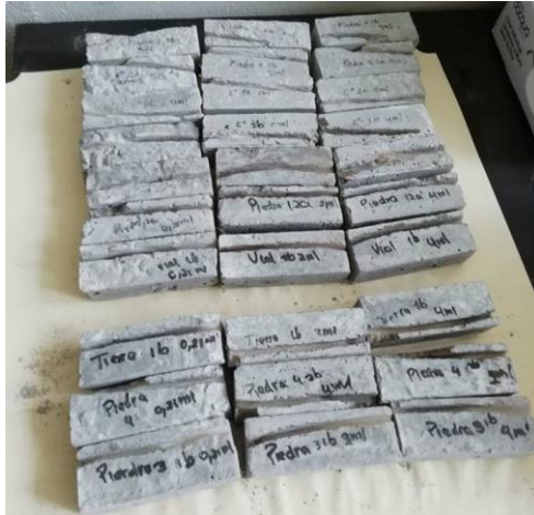
Figura 122: Probetas prismáticas fisuradas preparadas para el proceso de análisis de precipitación de carbonato de calcio a nivel microscópico.
