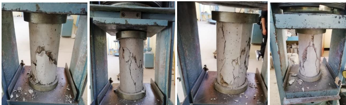
Figura 152: Ruptura de probetas cilíndricas a los 28 días. Vista de tipos y modos de falla.
