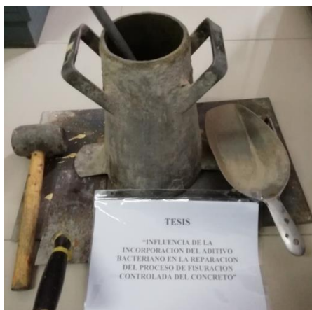
Figura 88: De izquierda a derecha: martillo de goma, badilejo, cono de Abrams y varilla compactadora, cucharón.
