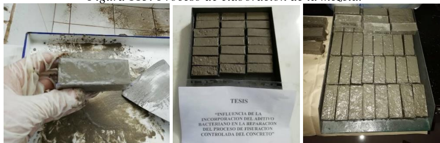
Figura 116: Probetas de concreto con adiciones bacterianas y sin adiciones bacterianas en proceso de fragua.
