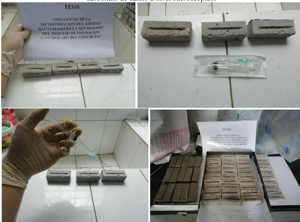
Figura 123: Proceso de aplicación de aditivo bacteriano en probetas prismáticas fisuradas.
