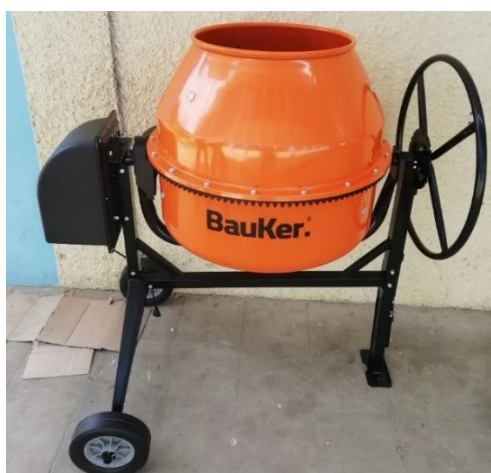
Figura 89: Trompo mezclador de concreto de capacidad de 120lts eléctrico marca Bauker
