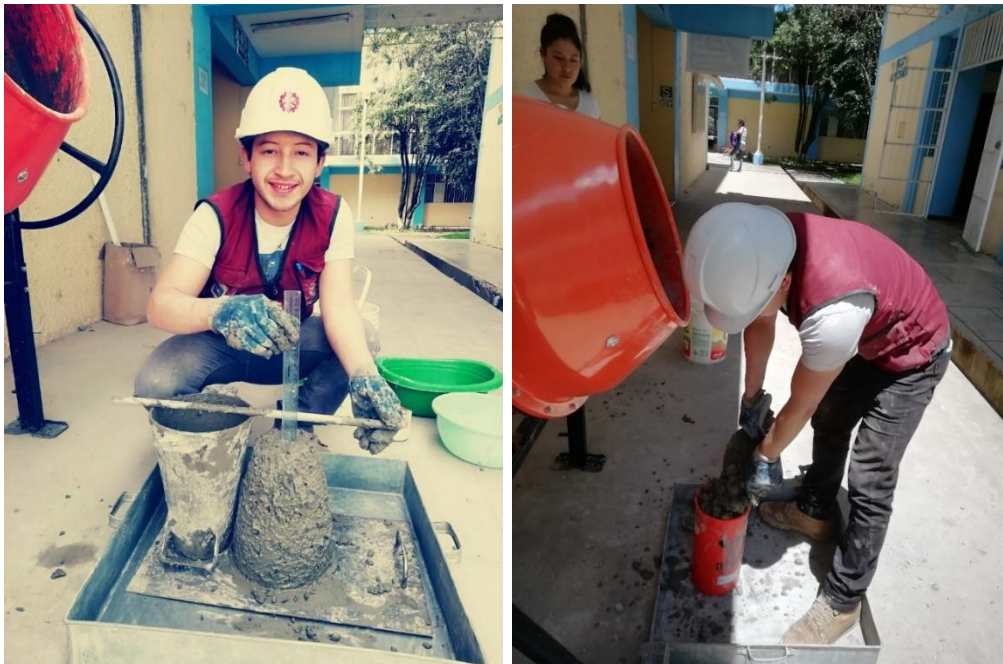
Figura 147: Izquierda: Medida del Slump de concreto bacteriano. Derecha: Llenado de moldes de concreto.
