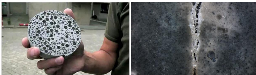
Figura 1: Detalle de cómo las bacterias rellenan los huecos con caliza. (Jonkers et. al, 2007)
