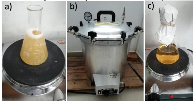
Figura 42: a) Agar nutritivo para el cultivo de las muestras. b) Material dentro del autoclave para esterilizar. c) Licuado de medio para verterlo en placas Petri.
