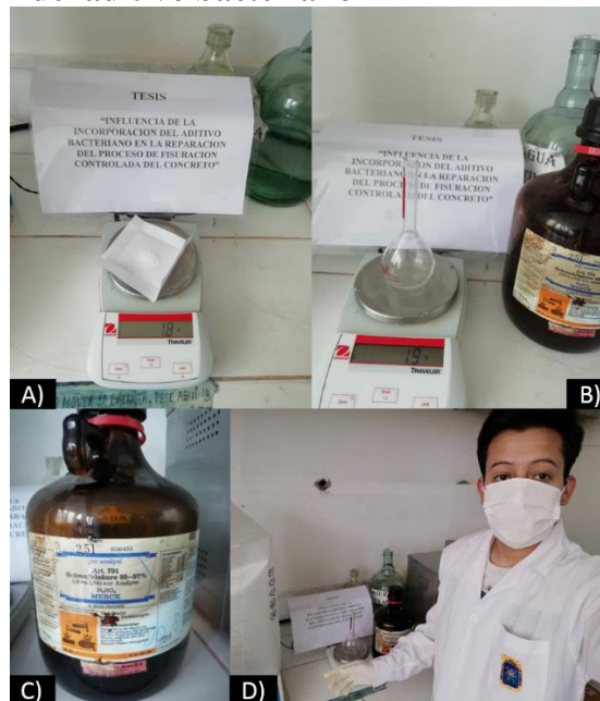
Figura 110: Conteo de esporas bacterianas por el método del tubímetro de Mc Farland para el (a) Pesaje de Cloruro de Bario (b) Pesaje de ácido sulfúrico (c) Frasco de ácido sulfúrico utilizado en la prueba (d) Tesista realizando el diseño del tubímetro de Mc Farland.
