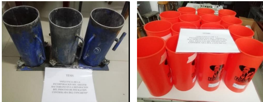
Figura 87: Moldes cilíndrico para ensayo en concreto de acero y de plástico de 6"x12" de 4 mm de espesor.
