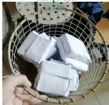
Figura 121: Probetas prismáticas esterilizadas en autoclave sin aditivo bacteriano a los 7 días de edad preparadas para el proceso de inyección de aditivo bacteriano.
