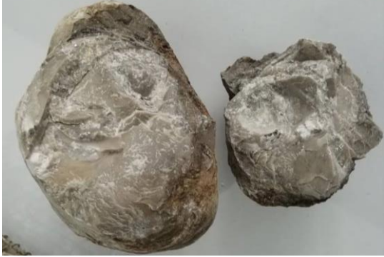
Figura 38: Roca 3 fracturada, utilizada para la extracción de muestra.
