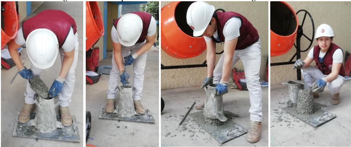
Figura 146: Proceso de medida del Slump de concreto bacteriano.
