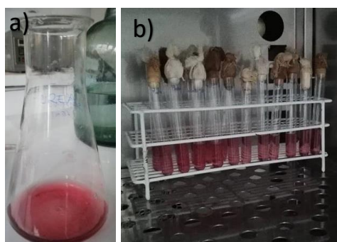
Figura 71: a) Medio de cultivo Ureasa. b) Tubos estériles con medio de cultivo y cepas bacterianas que presentan un resultado negativo.
