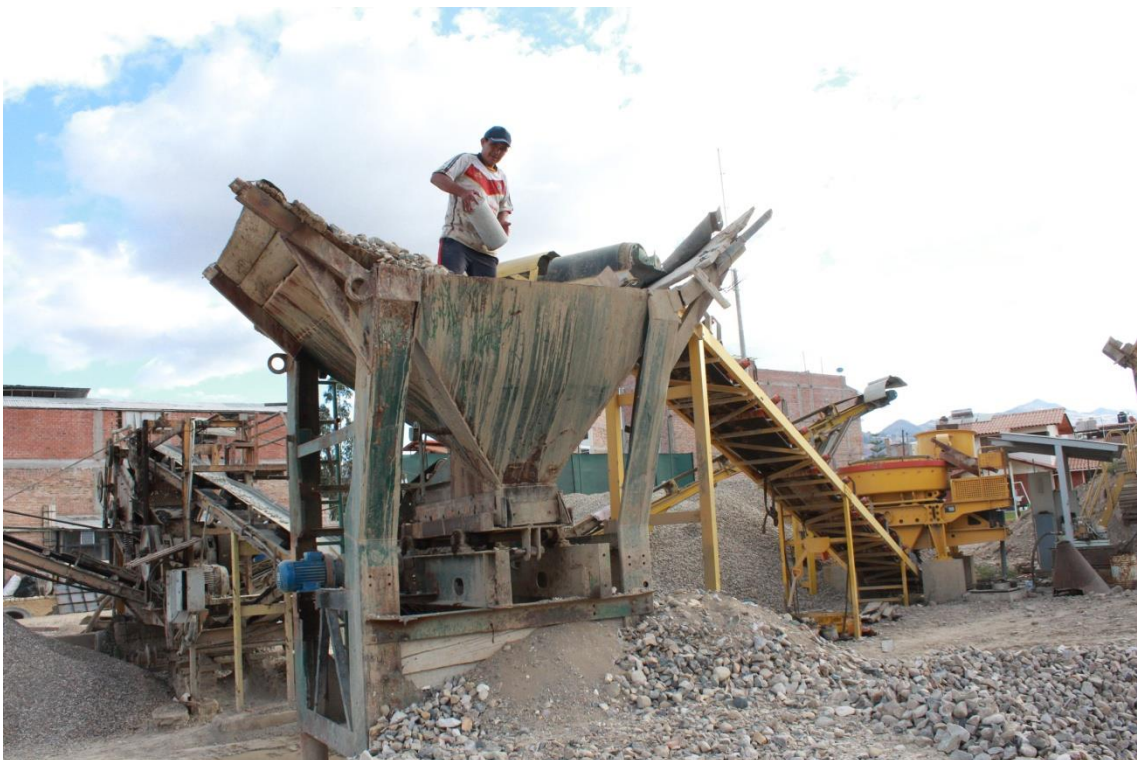
FOTO N° 4: Material reciclado chancado en la Planta Acosta
