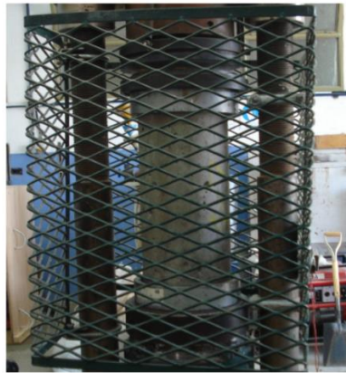
Figura 7: Ensayo de Compresión de probetas de concreto
