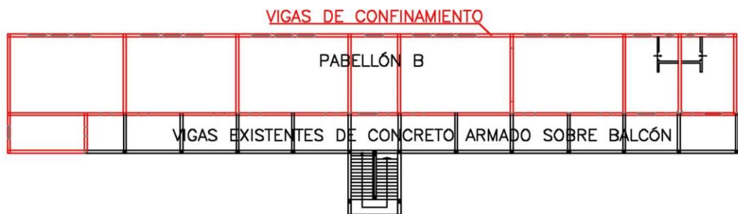
Figura 86. Construcción de vigas de confinamiento en Pabellón B.
