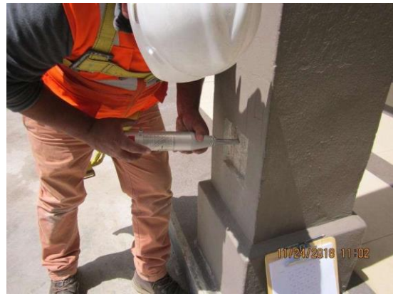
Ensayos de esclerometría
