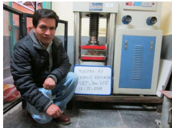
Ensayos a compresión de los ladrillos
