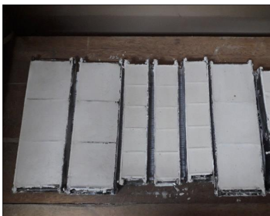
Figura 58: Probetas sin desencofrar para permeabilidad y prop. autolimpiable
