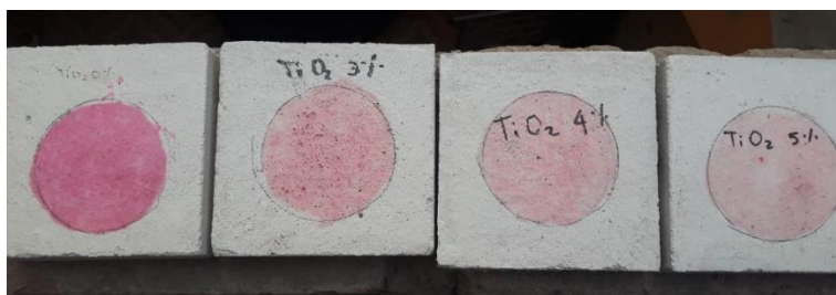
Figura 62: Especímenes de mortero con 0%,3%,4% y 5% de \text{TiO}_2 con Rodamina B expuestas a rayos UV, t = 4 horas
