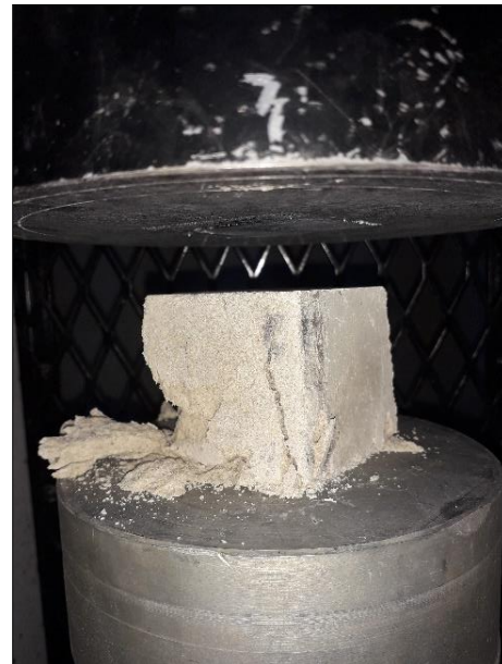
Figura 73: Rotura de probeta ensayada a resistencia a la compresión.
