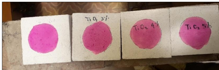
Figura 61: Especímenes de mortero con 0%,3%,4% y 5% de \text{TiO}_2 con Rodamina B expuestas a rayos UV, t = 0 horas
