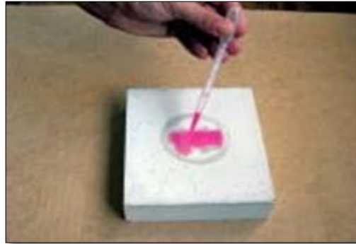
Figura 4: Aplicación de la solución de rodamina en la superficie de la muestra.
