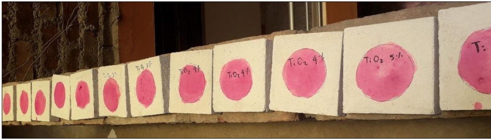
Figura 60: Especímenes de mortero con diferentes porcentajes de \text{TiO}_2 con Rodamina B
