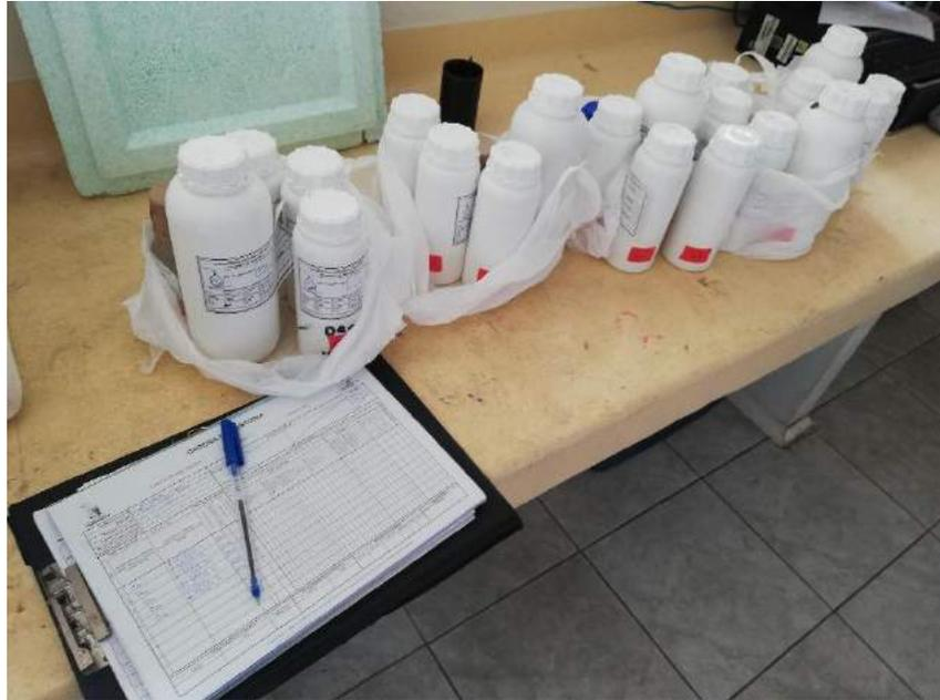
*Figura 50.* Frascos de plástico del Laboratorio Regional del Agua para toma de muestras de la calidad del agua
