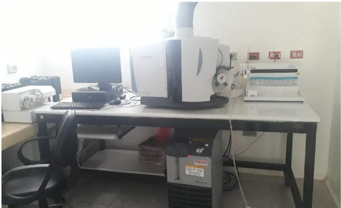
*Figura 57.* Espectrofotómetro óptico, junto al digestor de metales
