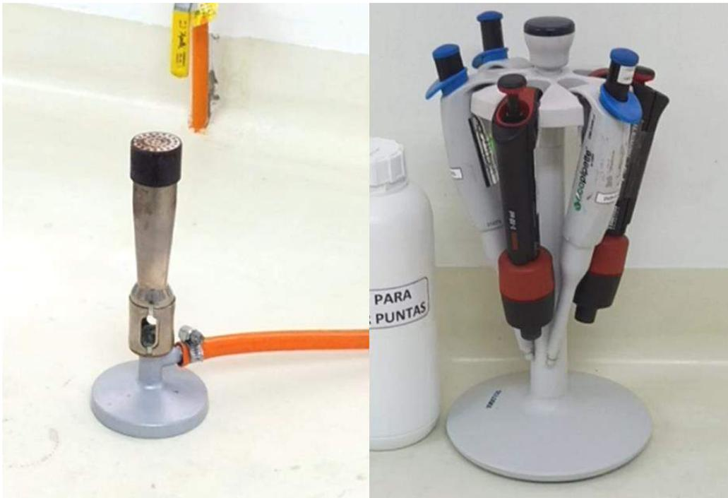
Figura 53. Mechero Bunsen (a) y micropipetas (b)
