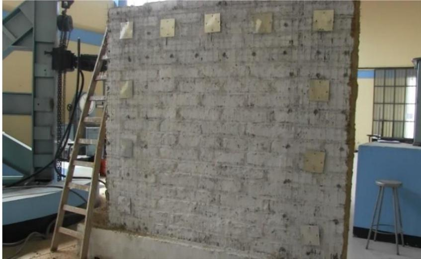
**Figura 21.** Muro reforzado terminado vista posterior
