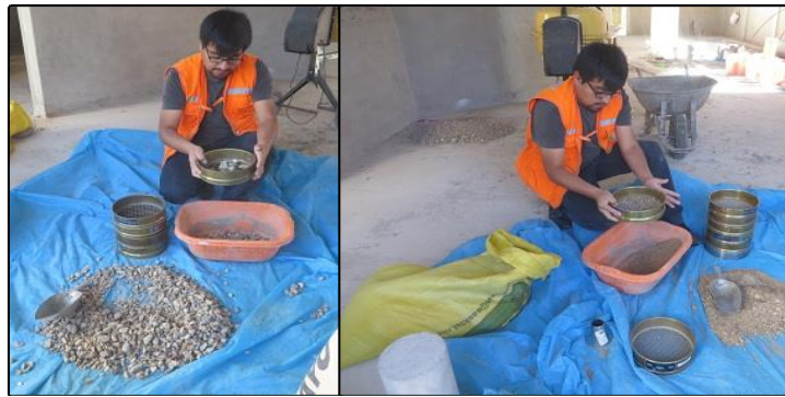
Figura 9: Análisis Granulométrico del Agregado Fino y Agregado Grueso.
