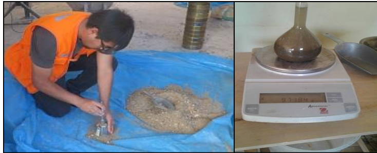
Figura 10: Peso específico y absorción del agregado fino
