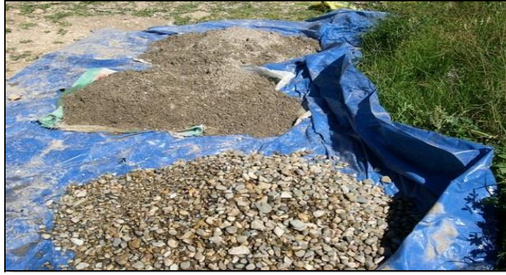
Figura 8: Método del cuarteo para obtener la muestra más representativa del Agregado grueso.
