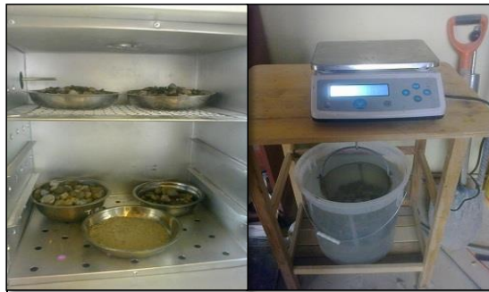
Imagen 06 Peso Especifico y Absorcion del Agregado Grueso
