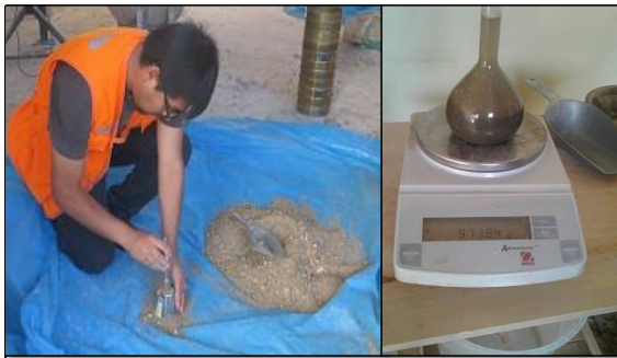
Imagen 05 Peso Especifico y Absorcion del Agregado Fino
