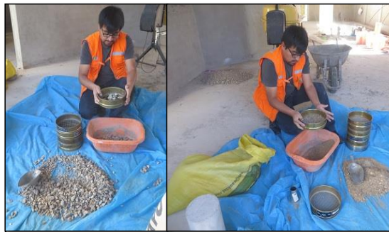
Imagen 04 Analisis Granulometrico del Agregado Fino y Agregado Grueso
