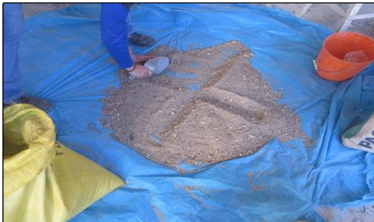
Figura 7: Método del cuarteo para obtener la muestra más representativa del agregado fino.
