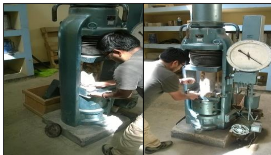
Imagen 16 Observacion sobre el tipo de falla del espécimen realizado en el ensayo a compresion
