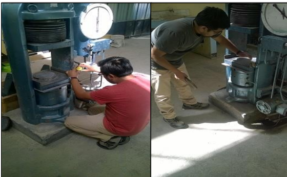
Imagen 13 Colocacion del deformimetro
