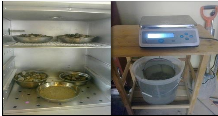
Figura 11: Peso específico y absorción del agregado grueso
