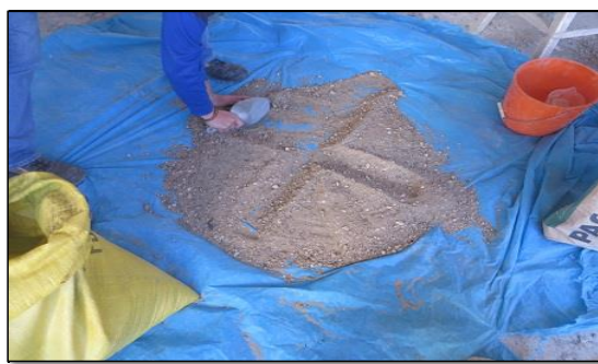
Imagen 02 Metodo del cuarteo para obtener la muestra mas representativa del Agregado Fino
