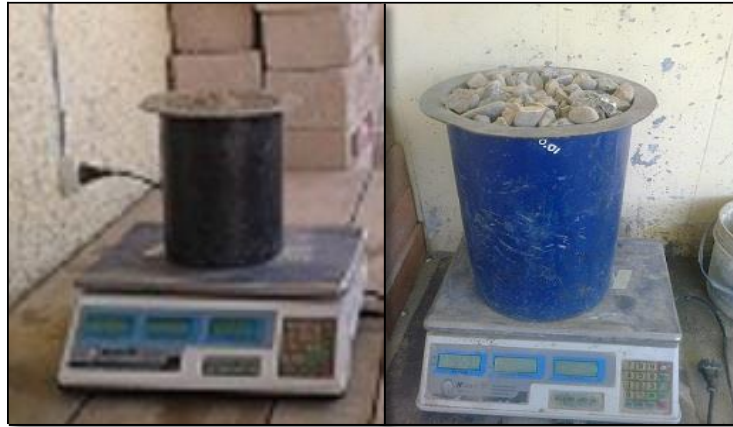
Figura 12: Peso Unitario Volumétrico Suelto y Compactado de los Agregados
