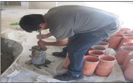
Imagen 11 Elaboración de los especímenes cilíndricos de concreto
