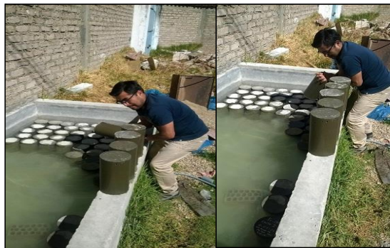
Imagen 12 Curado del concreto a los 3,5 y 7 dias.
