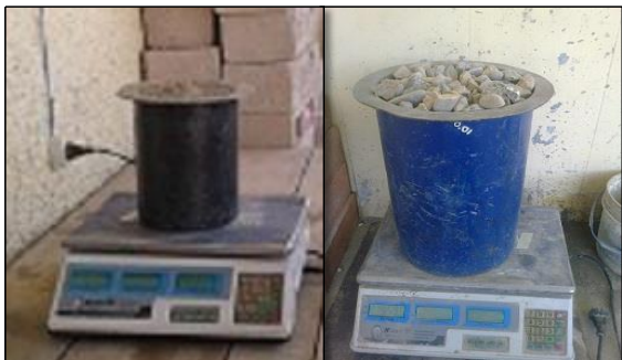
Imagen 07 Peso Unitario Volumetrico Suelto y Compactado de los Agregados
