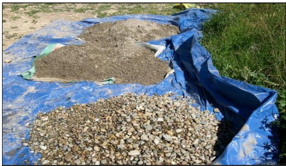
Imagen 03 Metodo del cuarteo para obtener la muestra mas representativa del Agregado Grueso
