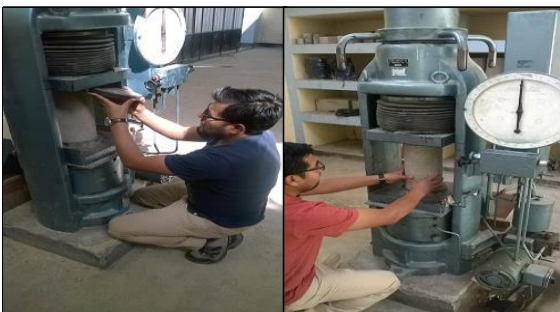
Imagen 15 colocacion de los platos retenedores con discos de neopreno.
