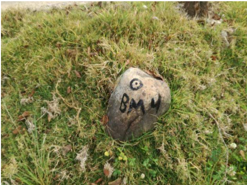
Figura N° 50: BM 4 dejado encampo para el cambio de estación en nuestro levantamiento topográfico. Fuente: Fotografía Propia
