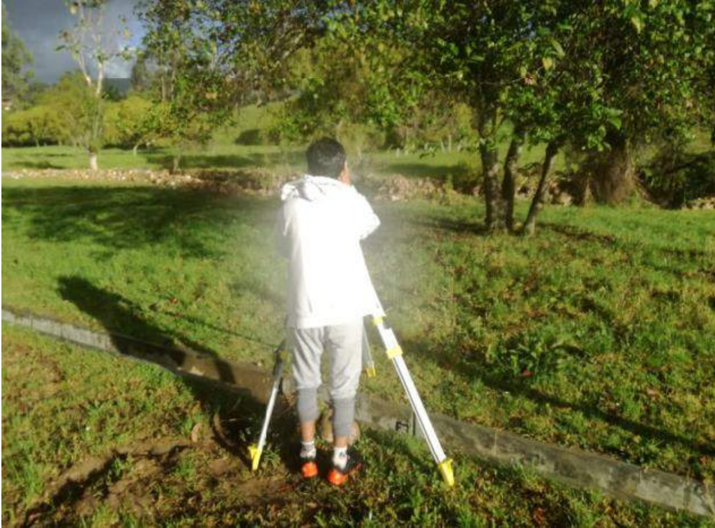
Figura N° 49: Uso de la estación TS02 para el levantamiento topográfico. Fuente: Fotografía Propia
