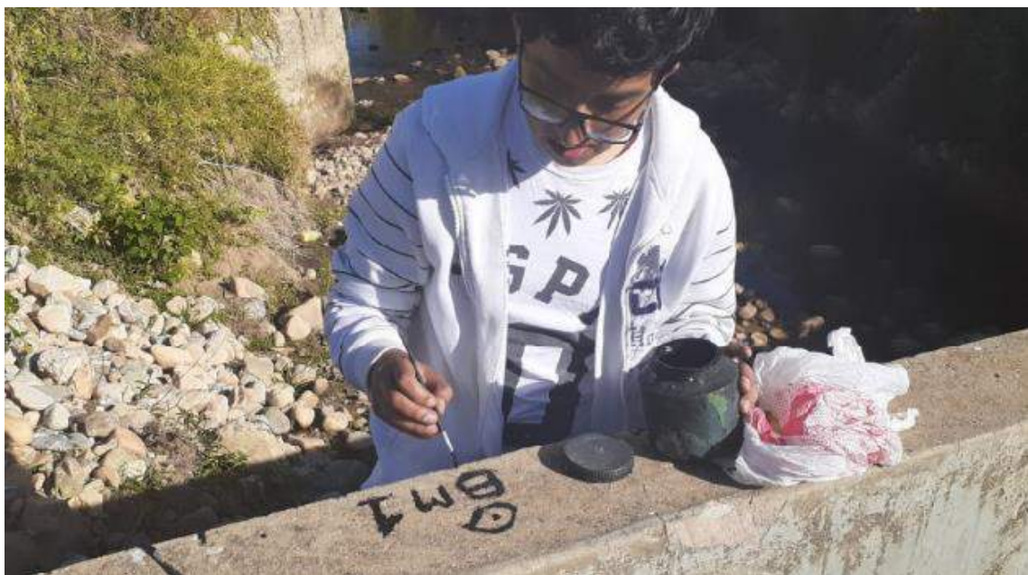
Figura N° 46: Pintado de BM1 para el levantamiento topográfico en un punto fijo.
