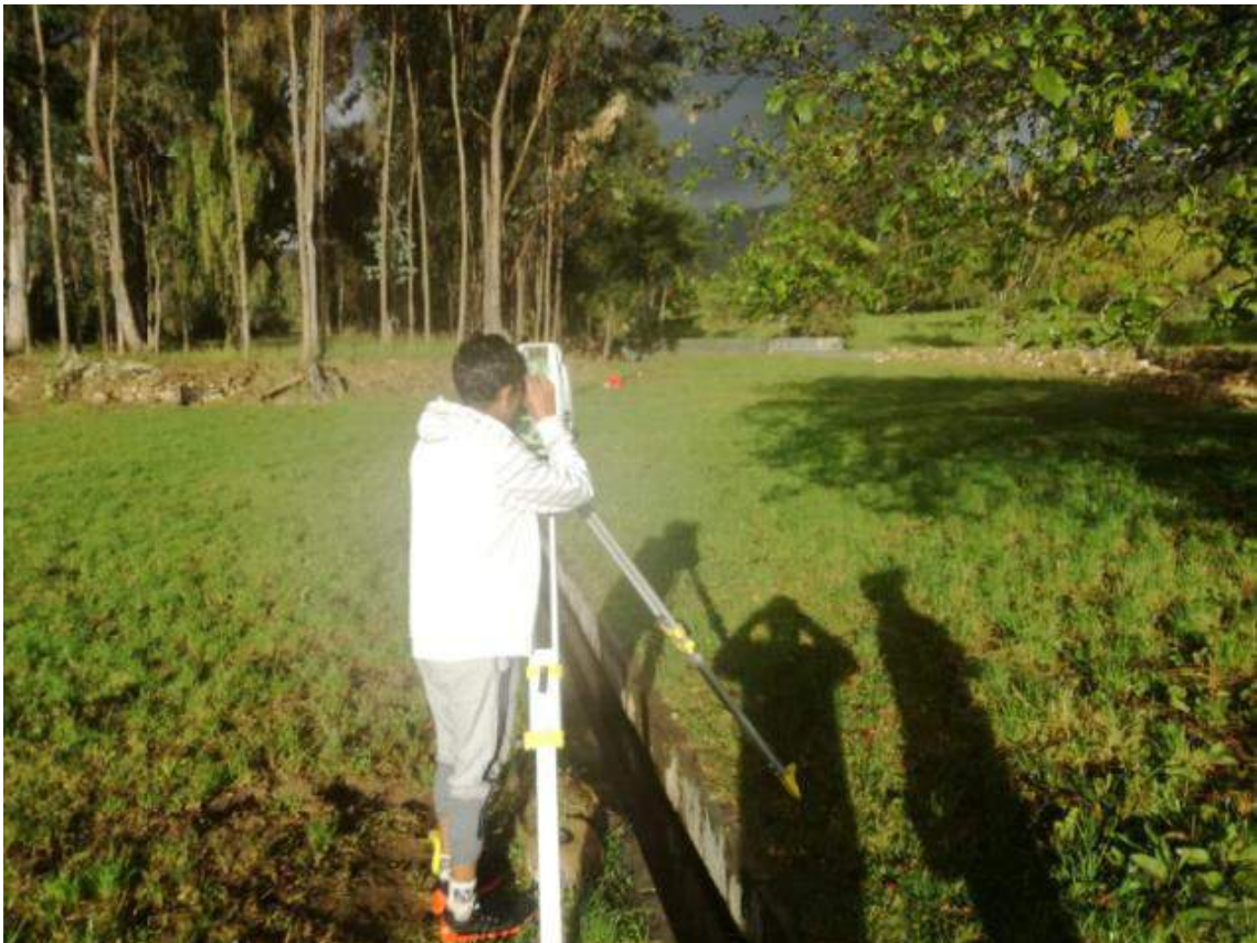
Figura N° 48: Uso de la estación TS02 para el levantamiento topográfico.
