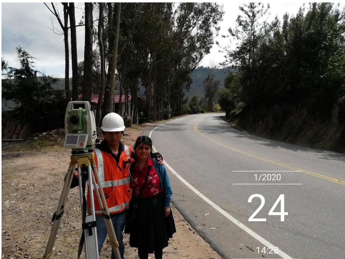
Fotografía N° 10: Cambio de estación en tramos con curvas.
