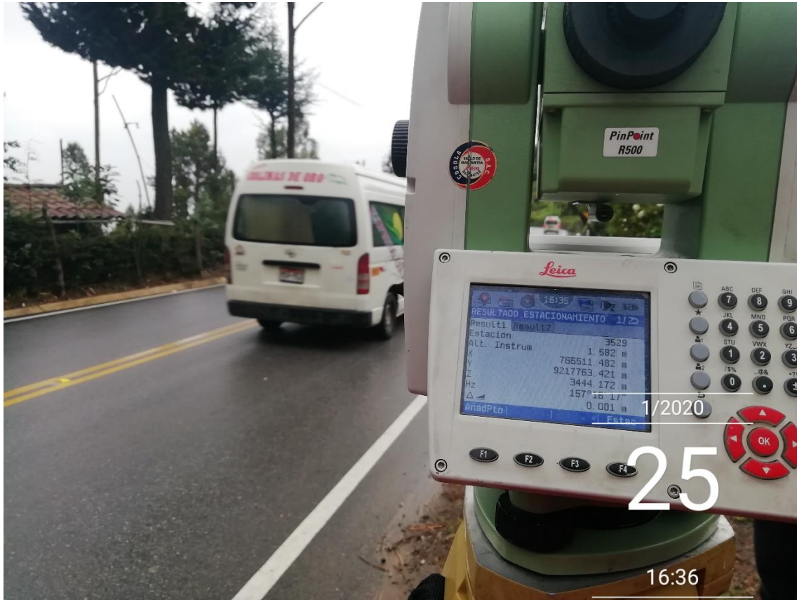
Fotografía N° 15: Verificación de la precisión en cada cambio de estación.
