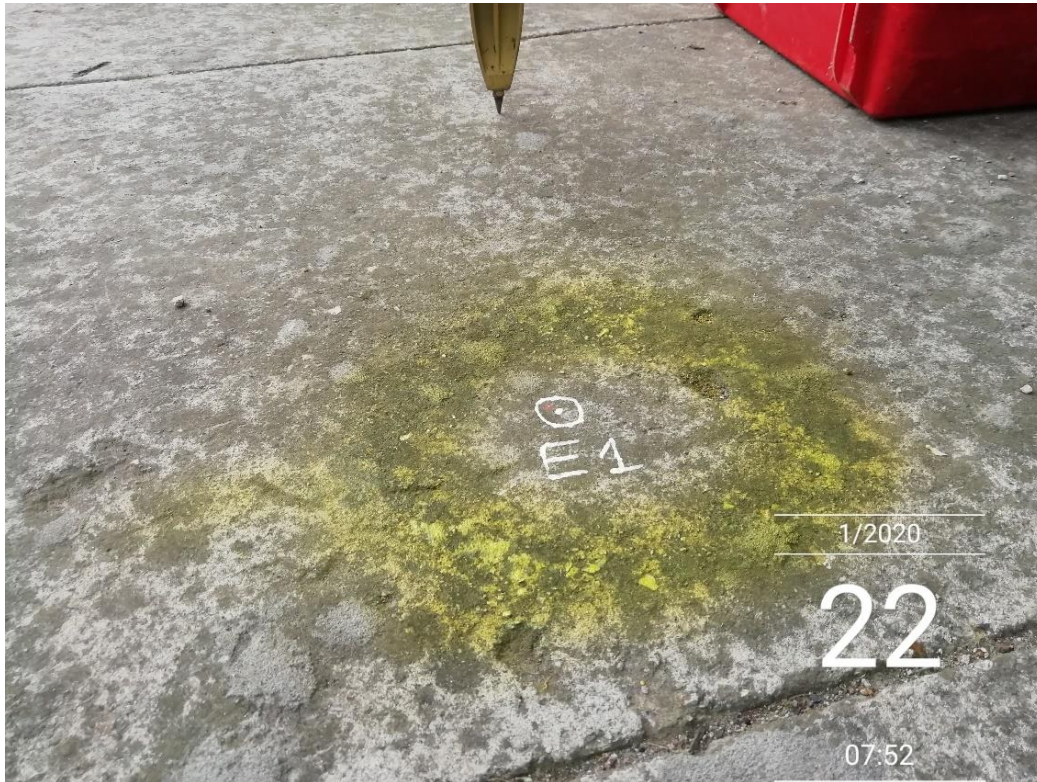
Fotografía N° 1: Punto de primera estación para el levantamiento topográfico.
