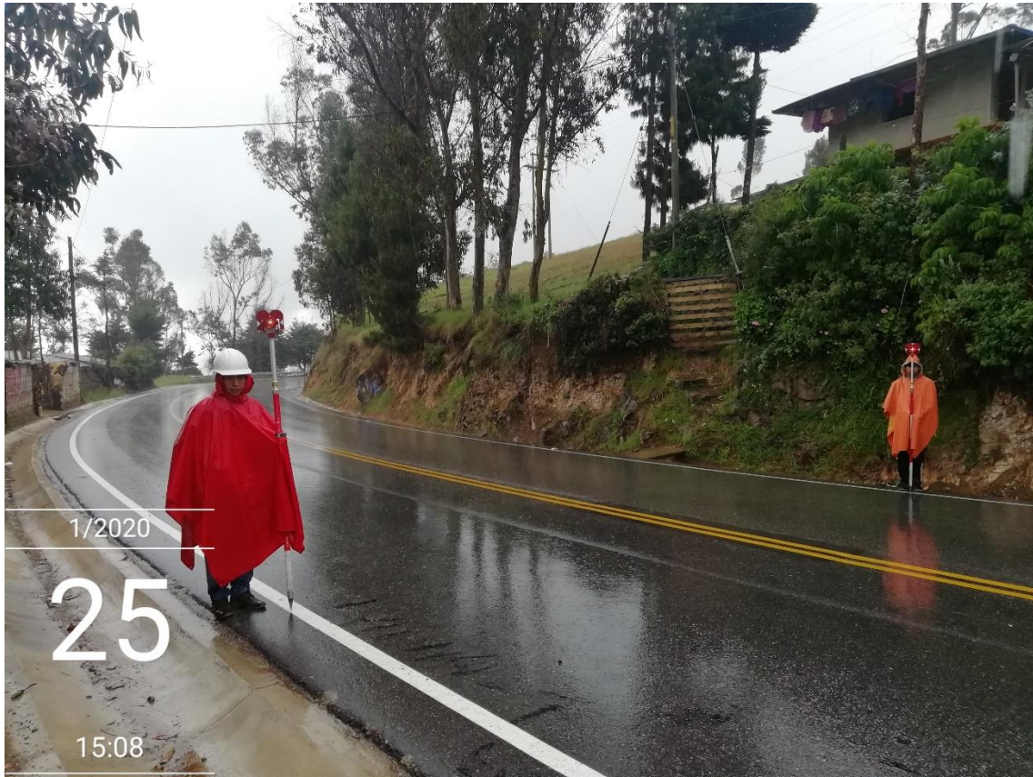
Fotografía N° 13: Toma de puntos del ancho de calzada.
