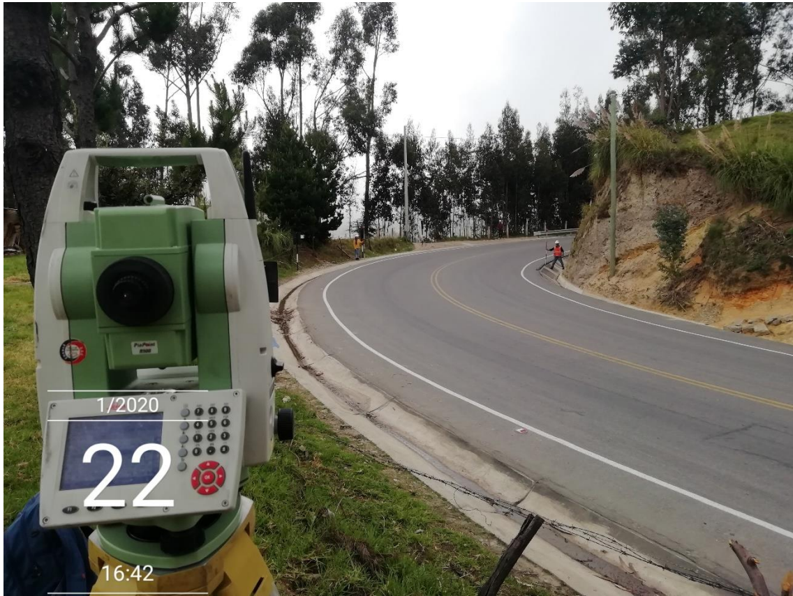
Fotografía N° 3: Toma de puntos del ancho de calzada.
