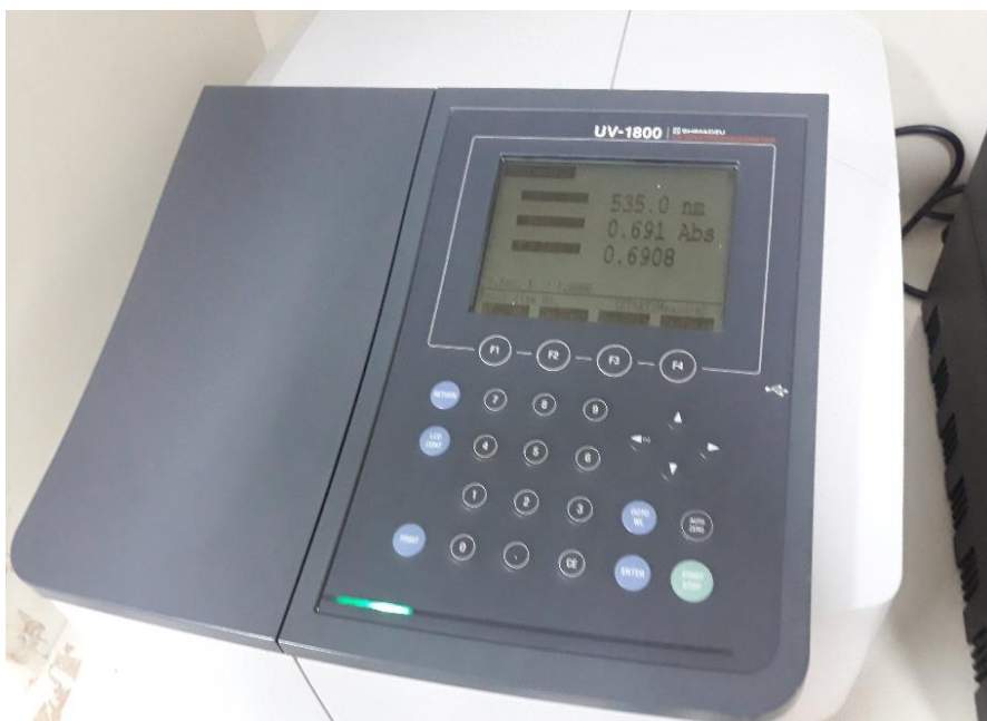
Figura 19. Espectrofotómetro Shimadzu UV - 1800 donde se hizo la lectura de la absorbancia de la muestra de antocianina a una longitud de onda de 535 nm (nanómetros) para la determinación del porcentaje de antocianinas.
