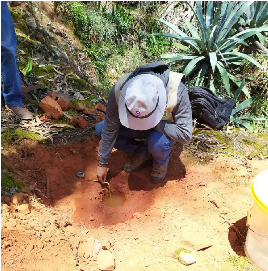
Foto 6. Tomando las lecturas del descenso del agua.
