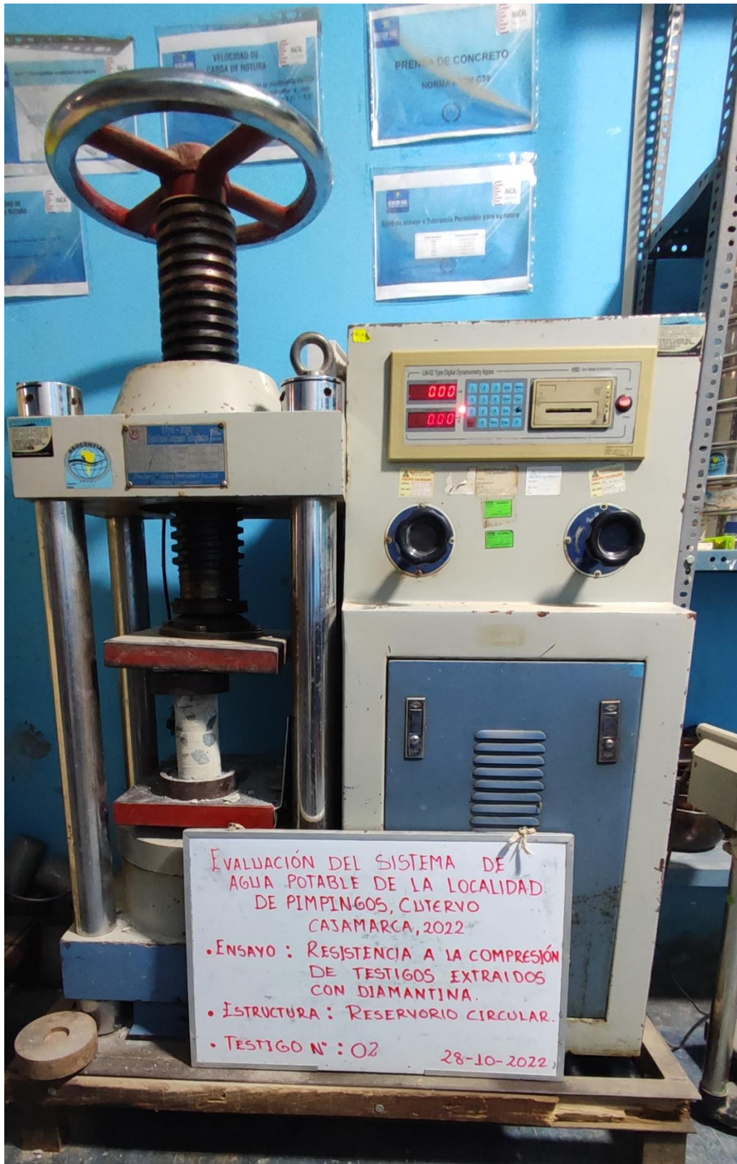
Foto 36: Ensayos estándar de compresión uniaxial del testigo N° 02.
