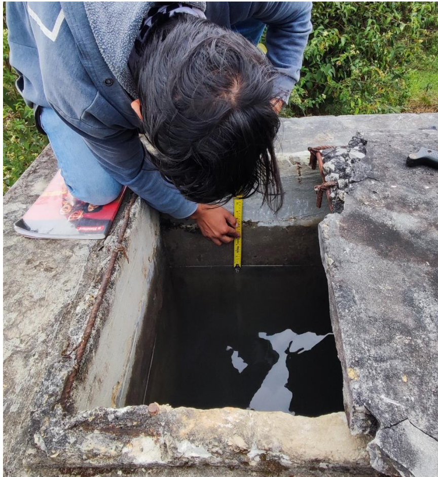
Foto 31: Medición de consumo de agua en el reservorio rectangular.
