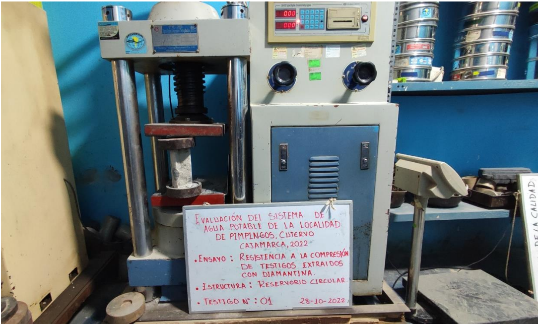
Foto 35: Ensayos estándar de compresion uniaxial del testigo N° 01.
