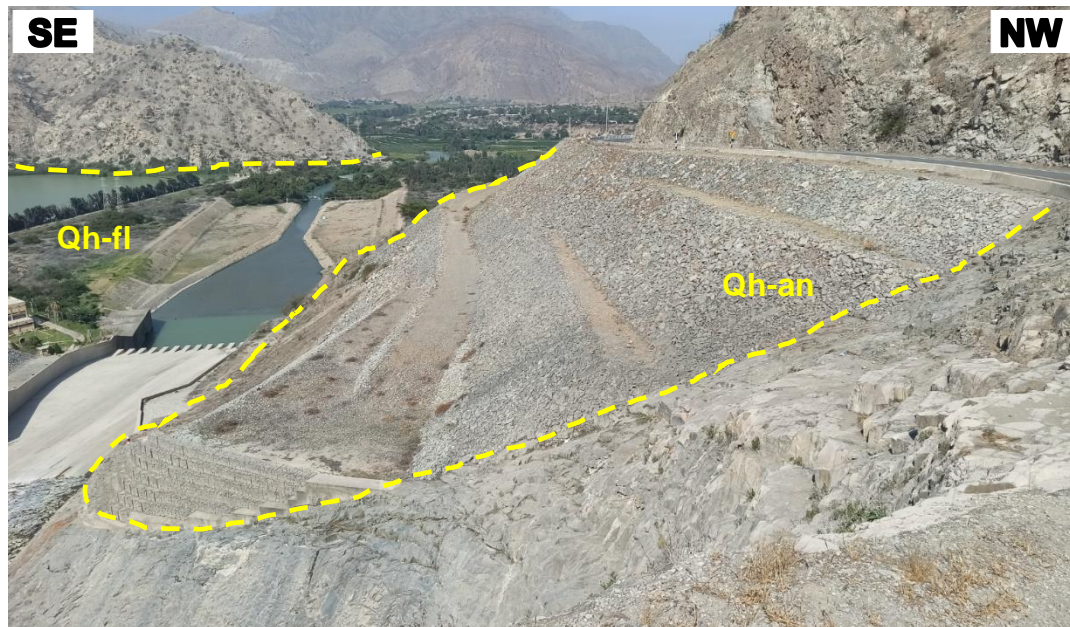
Foto 3.1. Depósitos cuaternarios de tipo antrópico y fluvial. Parte baja del Valle Jequetepeque. Coordenadas: E 697282; N 9199954; Cota 418 m.s.n.m.
