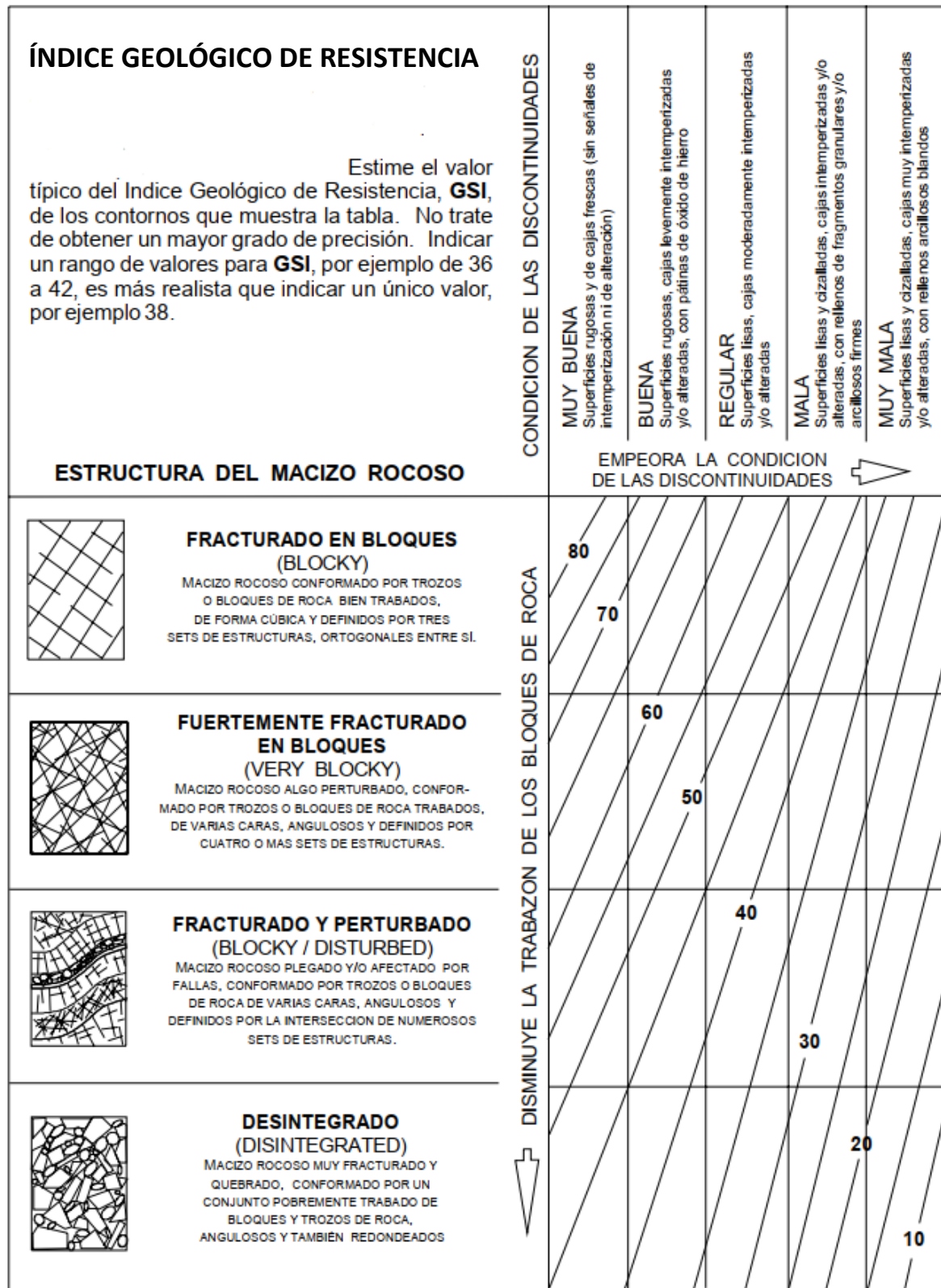
Figura 2.5. Estimación del índice Geológico de resistencia, GSI, en base a una descripción geológica de macizo rocoso.
