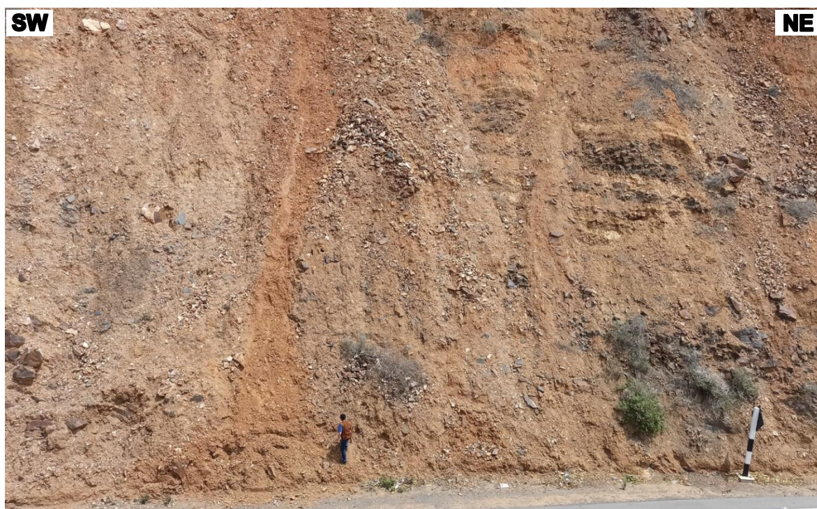
Foto 3.29: Depósito coluvio-aluvial cubriendo afloramiento de areniscas calcáreas, entre el Km.36+270 y Km. 36+366 de la carretera Ciudad de Dios - Cajamarca. Coordenadas: E 697415; N 9200707; Cota= 429 m.s.n.m.
