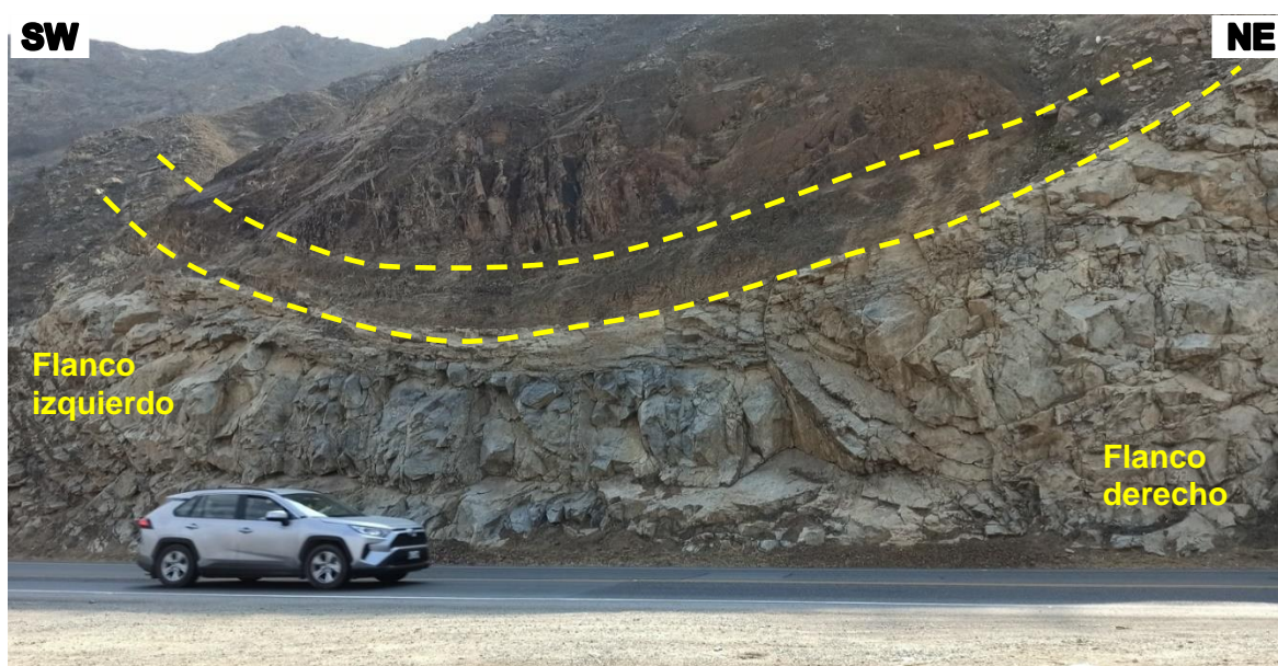
Foto 3.13: Núcleo de Sinclinal, en la Formación Chúlec. El eje del Sinclinal, corta transversalmente la Carretera Ciudad de Dios - Cajamarca. Presenta los siguientes datos estructurales, Flanco izquierdo: Az= N 256°, Buz= 62° NW; Flanco derecho: Az= N 84°, Buz= 60° SE Coordenadas: E 697328; N=9200406; Cota= 421 m.s.n.m.
