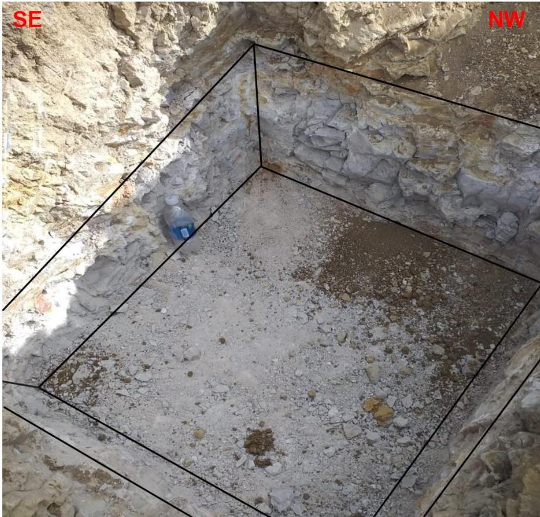
Foto 10. Calicatas para obtener muestra de Arcilla. Ubicación: (E: 775518, N: 9203953 y C: 2818 msnm)
