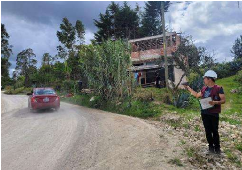
Figura N°13. Medición de la velocidad de operación.
