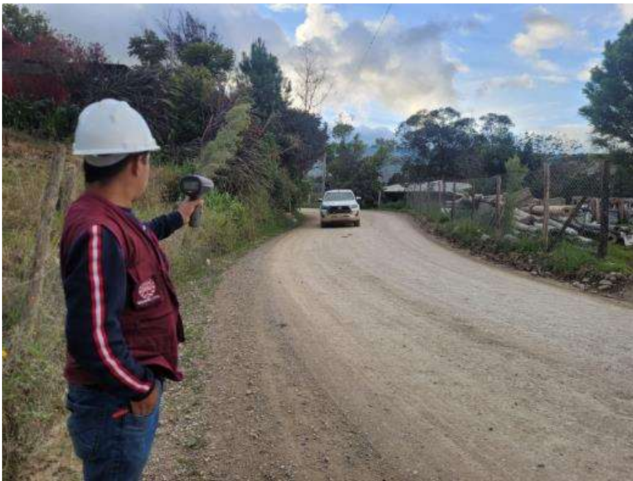
Figura N°12. Medición de la velocidad de operación.
