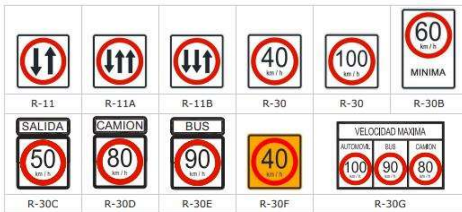
Figura 2.10. Ejemplos de señales reguladoras – restricción.
