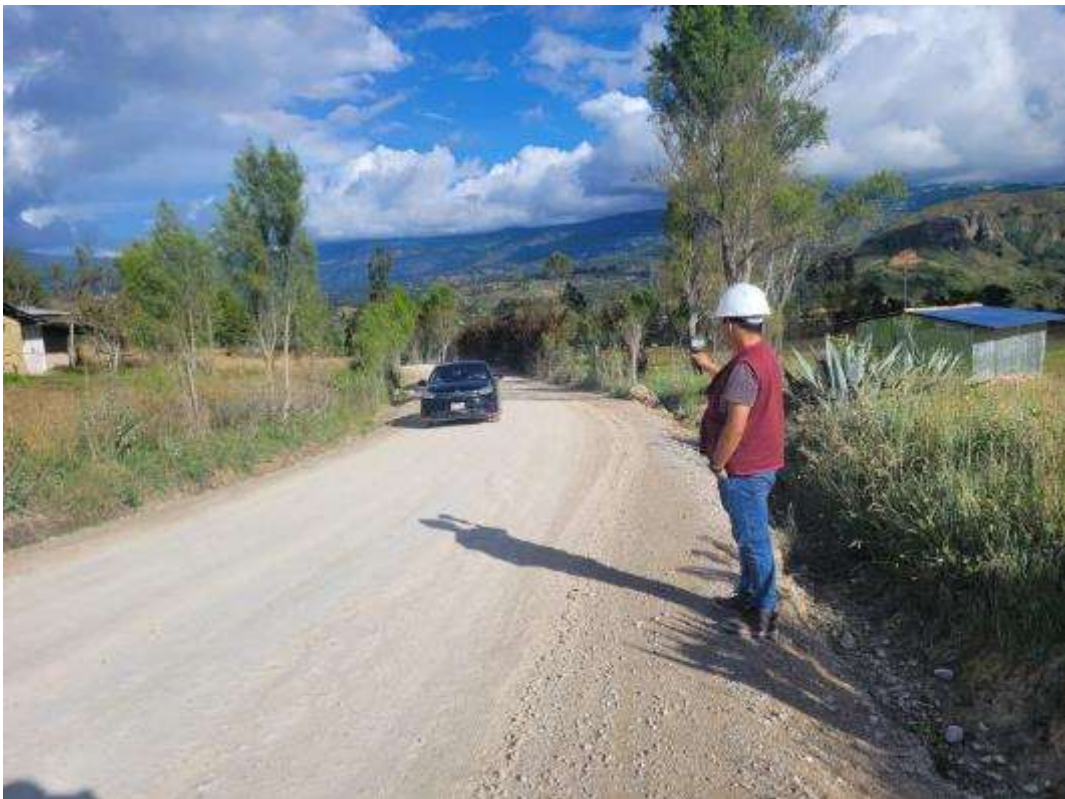
Figura N°14. Medición de la velocidad de operación.
