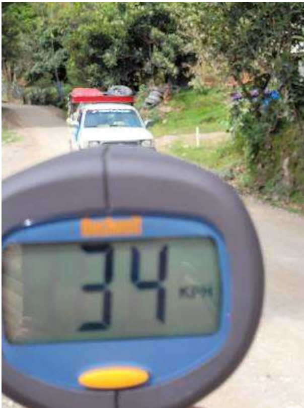
Figura N°10. Medición de la velocidad de operación.
