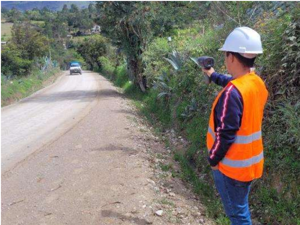
Figura N°11. Medición de la velocidad de operación.
