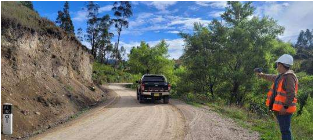
Figura N°09. Medición de la velocidad de operación.
