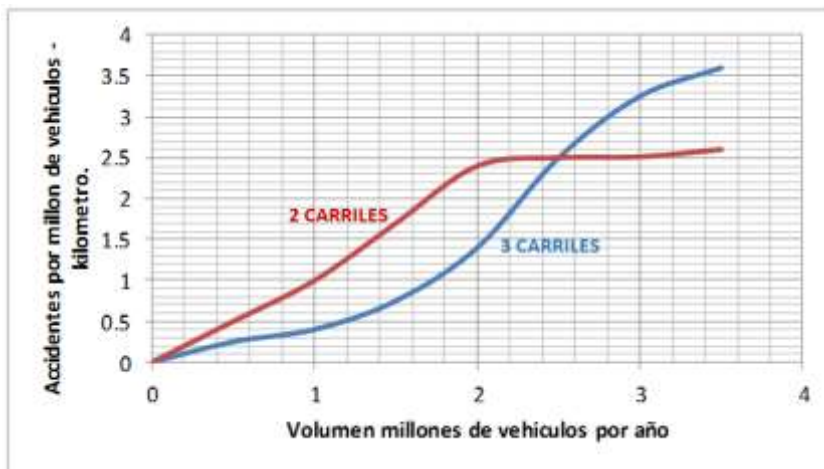
Figura 2.2. Índice de accidentes para carreteras de 2 y 3 carriles con relación al volumen de tránsito.
