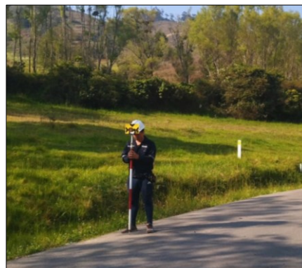
Figura 21. Prisma junto con el bastón usados en el levantamiento topográfico
