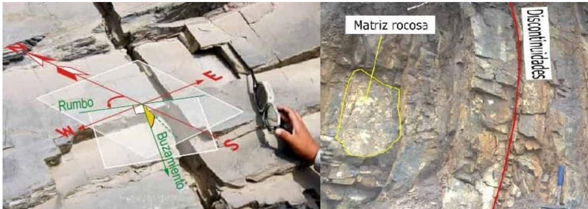
Figura 3: Esquema ilustrativo de discontinuidades (González de Vallejo, 2002).
