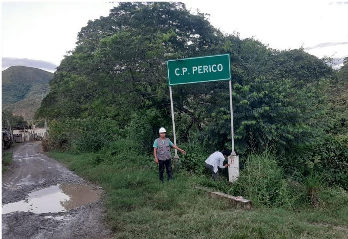
Fotografía 5. Marcación de BM20 en la localidad de Perico
