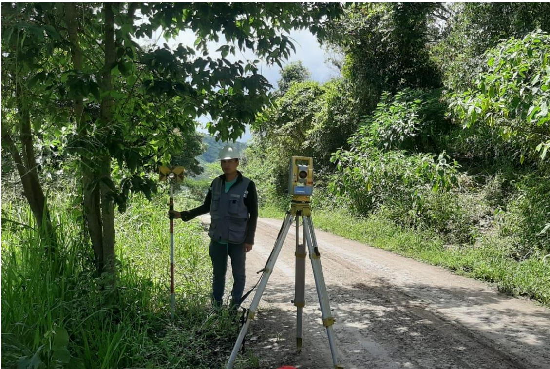
Fotografía 4. Levantamiento topográfico en la carretera.
