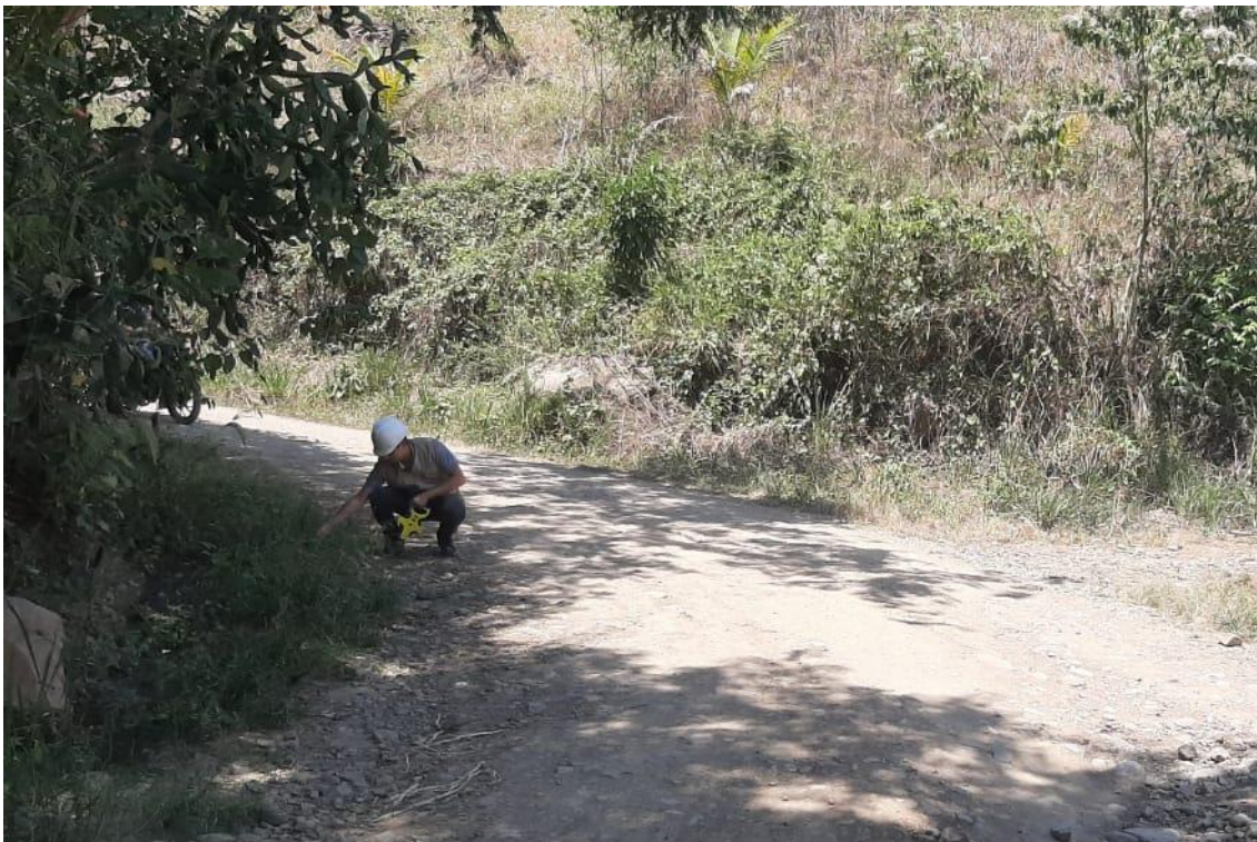
Fotografía 14. Medición de la berma existente de una sección de la carrera.
