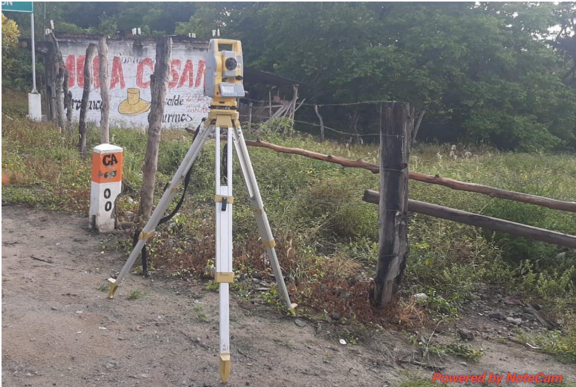
Fotografía 1. Estación n°01 del levantamiento topográfico de la carretera.
