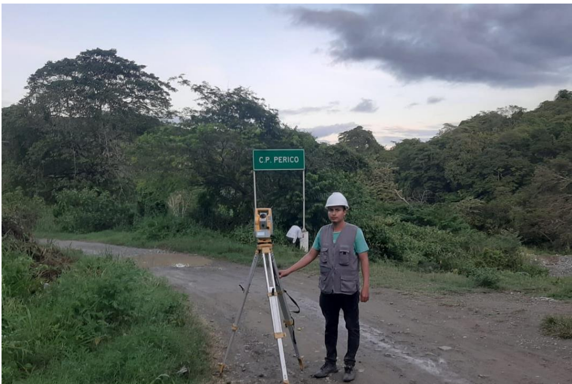
Fotografía 2. Levamiento topográfico de carretera en la localidad de Perico.
