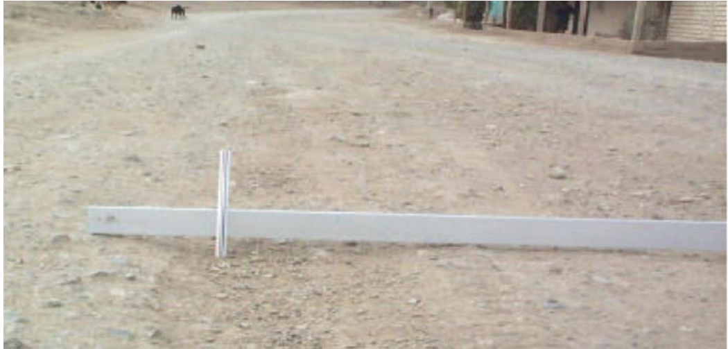
Figura 1.- Gravedad 1: Huellas/hundimientos sensibles al usuario, pero < 5 cm.
