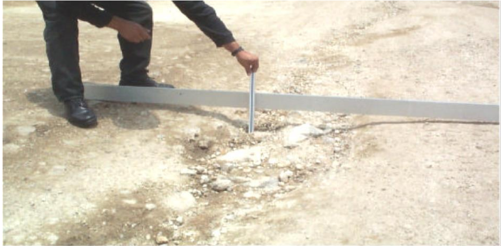
Figura 6.- Gravedad 3: Profundidad \geq 10 cm.
