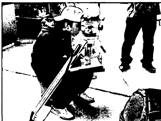
Foto 29. Toma de datos con nivel de ingeniero desde el papel milimetrado centrado en el centro de los muretes de cada una de las combinaciones.
