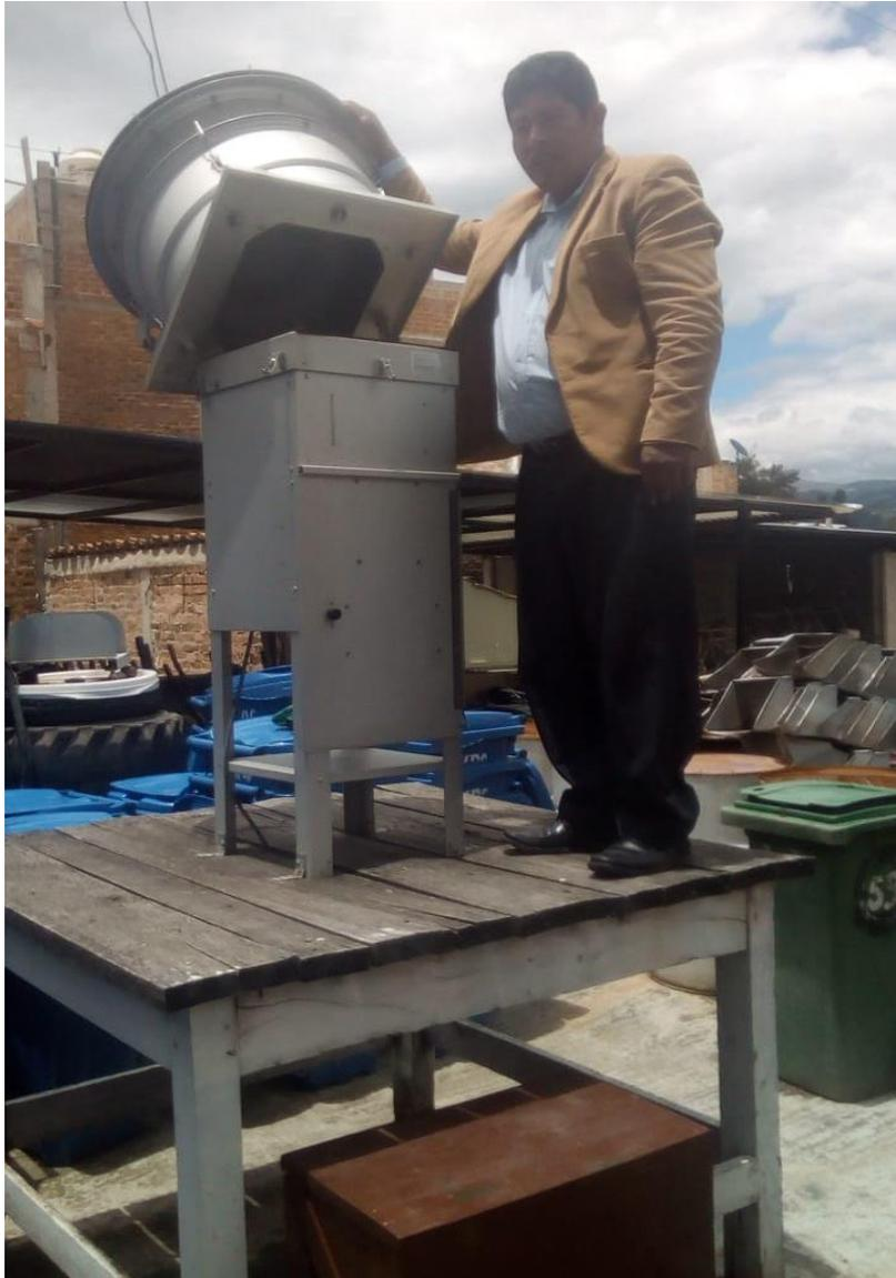
Figura 31. Colocado de *filtro de aire* en el muestreador de aire
