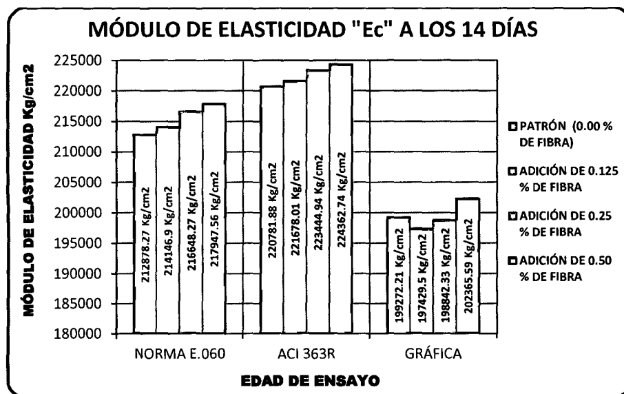
Gráfico N° 20: Módulos de Elasticidad de las diferentes adiciones de fibra de vidrio según Norma E.060, ACI 363R y Gráfica a los 14 días de ensayo.
