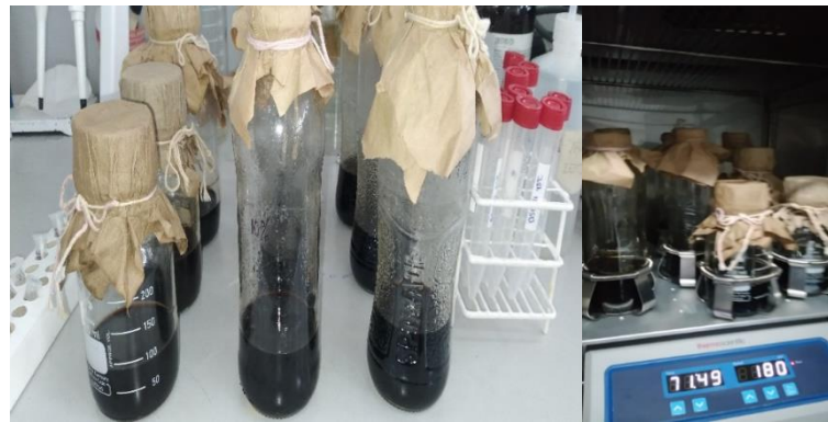
Figura 12. Medio utilizado para los procesos fermentativos y sistema de incubación y agitación empleado.
