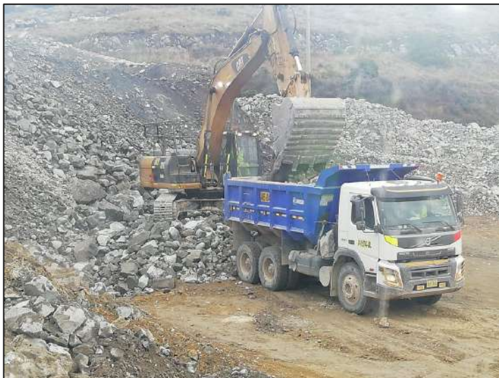
Figura 17: Volquete Marca Volvo de San Martín C.G, realizando el carguío de rocas.
