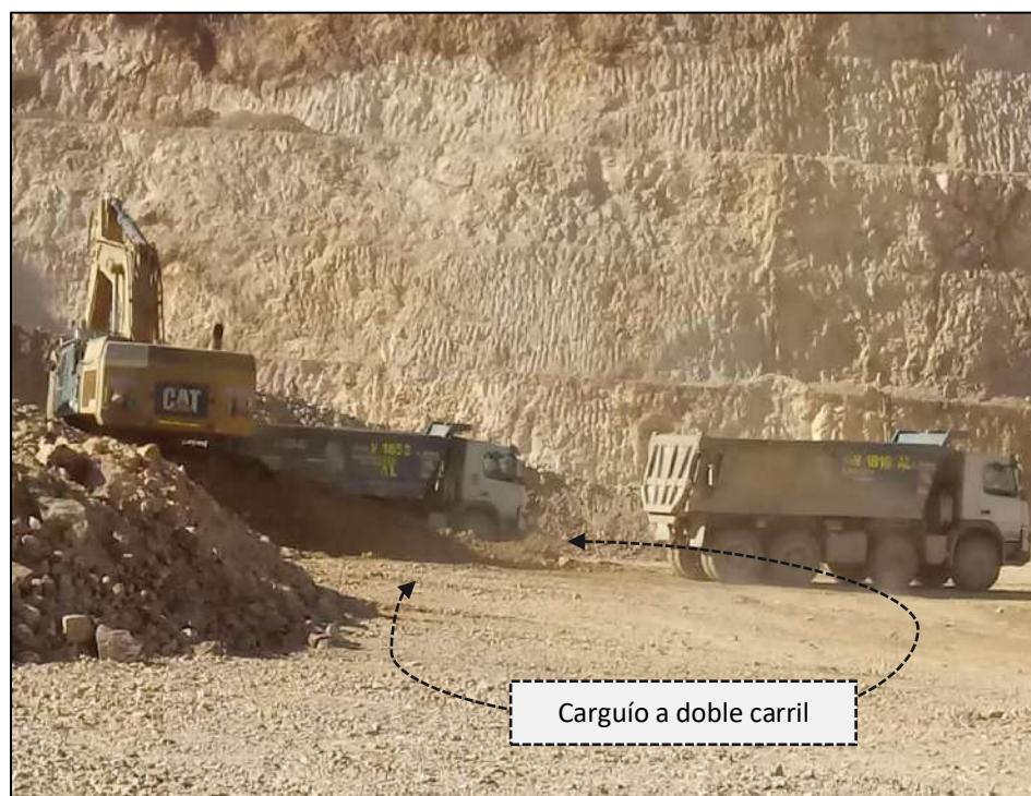
Figura 13: Carguío a doble carril del material acopiado.
