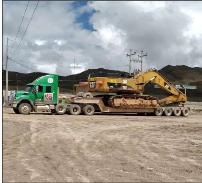
Figura 7: Excavadora en traslado en cama baja
