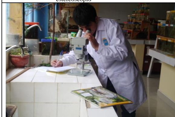
Figura 103 Realizando el inventario de MIB y cálculo de la calidad del agua del río San Lucas
