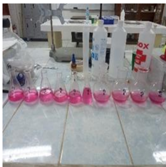
Titulación de muestras con (hidróxido de sodio)
