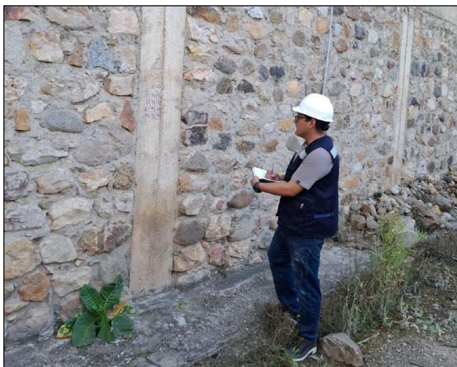
Fotografía N°6. Punto de ensayo de esclerometría – Columna C2
