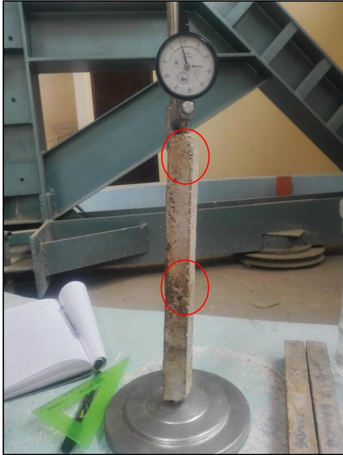
Figura 52. Presencia de fisuras en las barras de mortero a los 11, 14 días.
