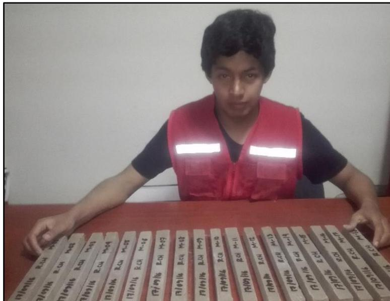
Figura 31. Codificación de las barras de mortero 25x25x285 mm
