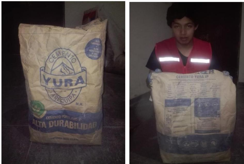
Figura 29. Cemento IP Yura. Norma técnica ASTM C150 NTP 334.09
