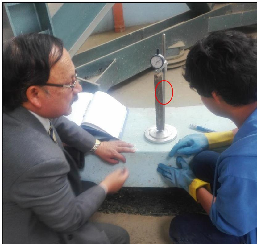
*FIGURA N° 40 barras de mortero a los 14 días con expansiones mayores a 1.5% presencia de ligeras curvaturas*
