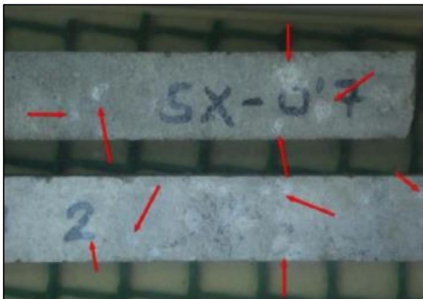
*FIGURA N° 41 barras de mortero a los 14 días con depósitos en la superficie*
