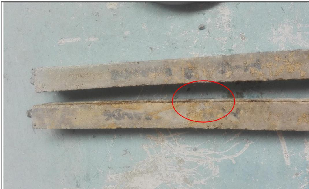
Figura 53. Presencia de curvaturas de la probeta a los 14 días.
