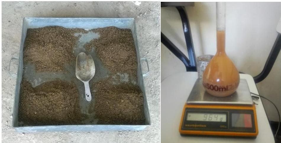
Figura 24. Selección del agregado fino por cuarteo, frasco lleno con la muestra y el agua hasta la marca de 500cm<sup>3</sup>.
