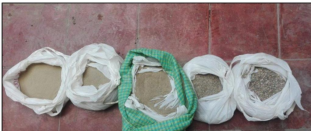
*Figura 27. Gradación del agregado según la tabla N° 1 de la cantera Roca Fuerte.*
