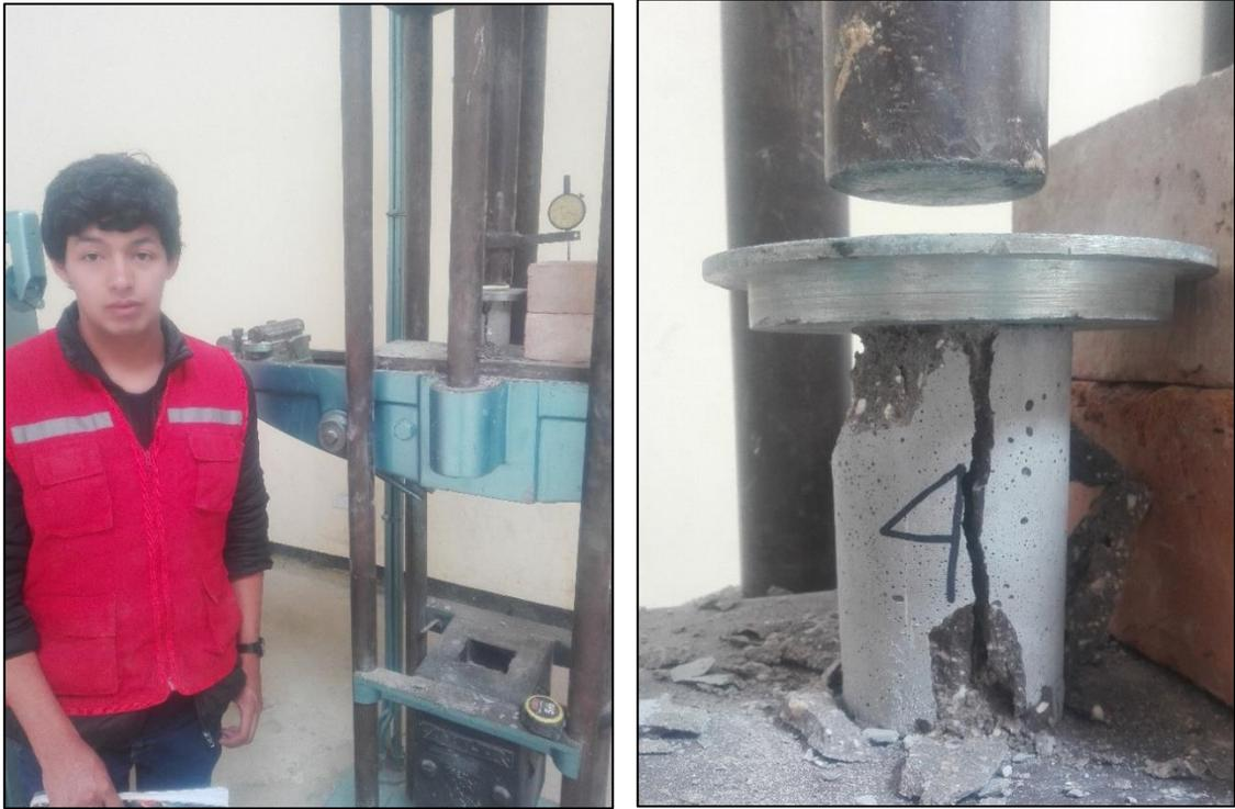
*FIGURA N° 43 Ensayo de resistencia a la compresión*
