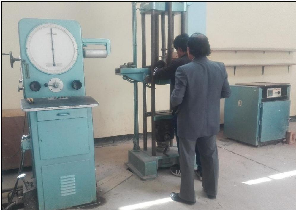
*FIGURA N° 44 verificación del Ensayo de resistencia a la compresión*
