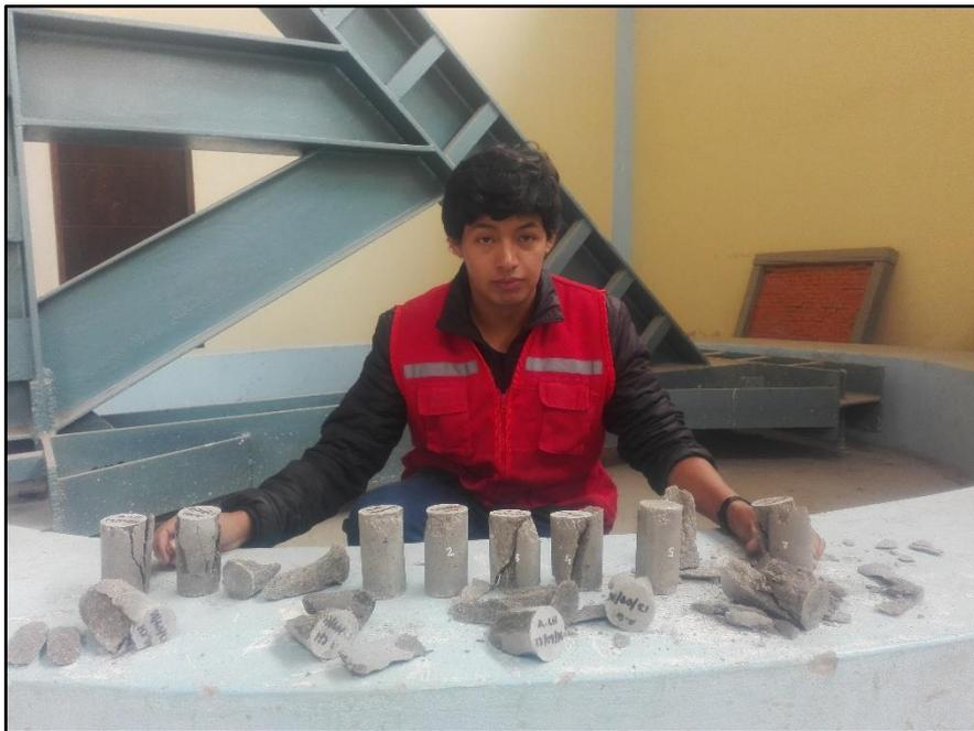
Figura 55. Rotura de probetas probadas para compresión.
