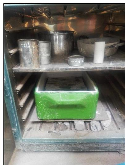
Figura 49. Almacenaje en horno a temperatura 80°C
