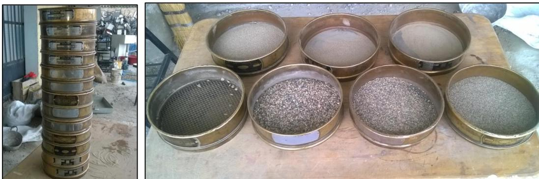
Figura 25. Juego de tamices empleado en el ensayo granulométrico.
