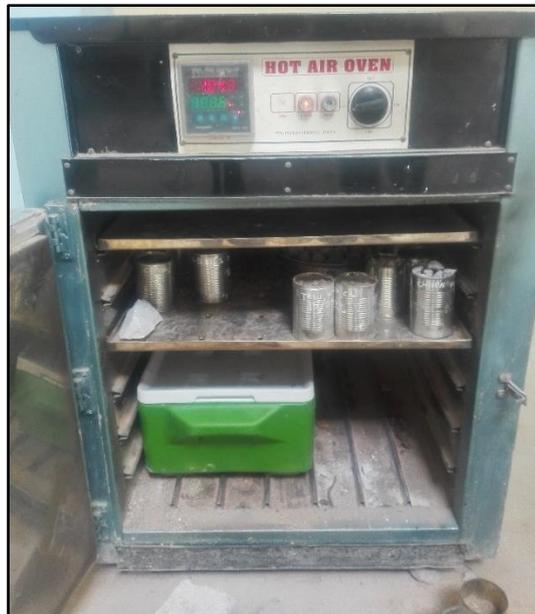
Figura 34. Almacenaje en horno de convección a una temperatura de 80 °C (176 °F).
