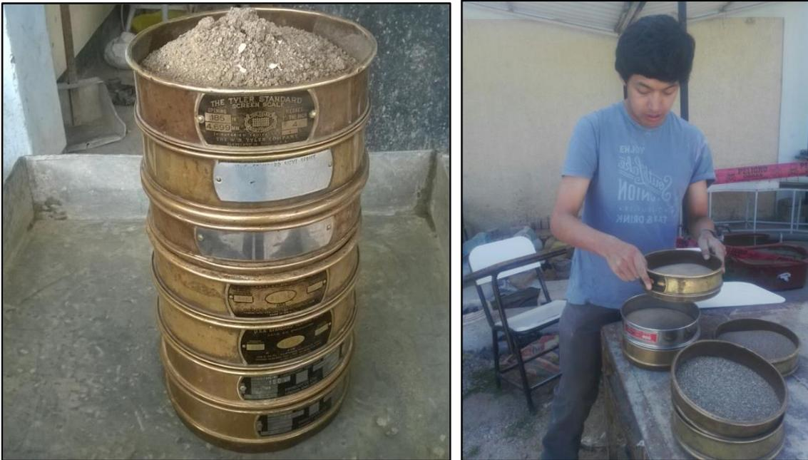
Figura 45. Ensayo granulométrico del agregado fino.
