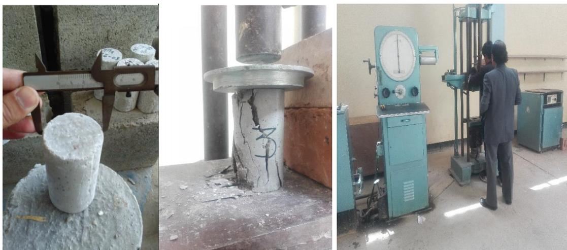
Figura 26. Toma de medidas del mortero, ensayo a compresión del mortero, tipo de falla corte diagonal del mortero.
