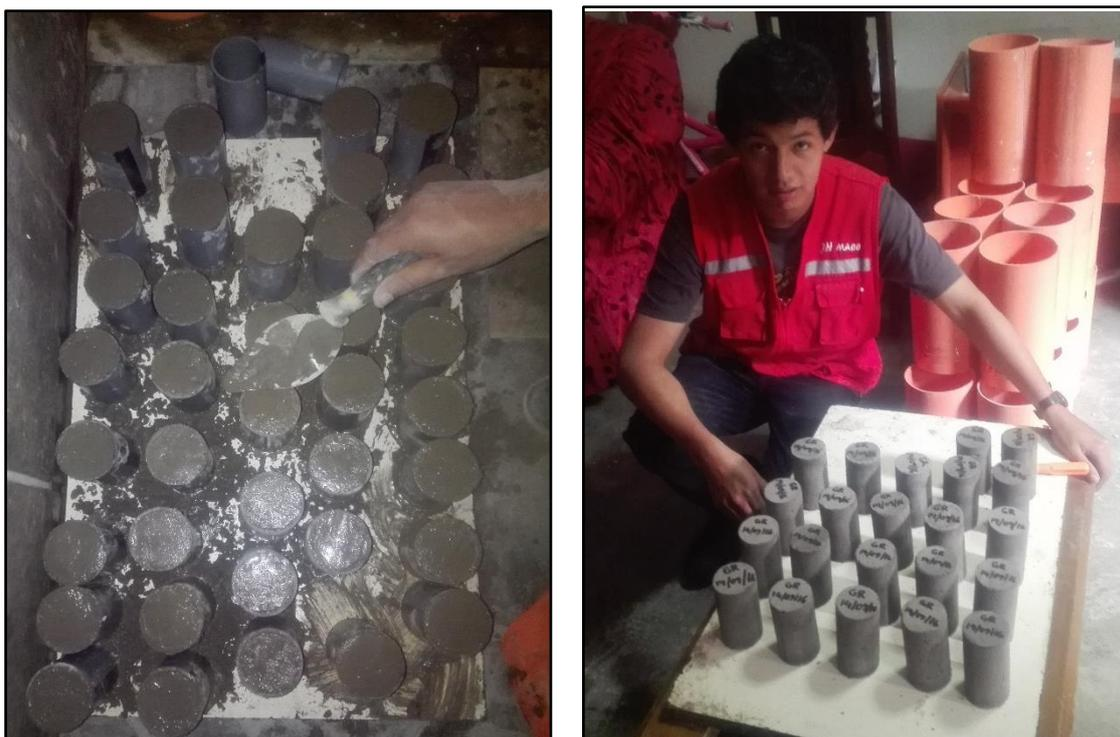
*FIGURA N° 42 Probetas de mortero para ensayo a la compresión*
