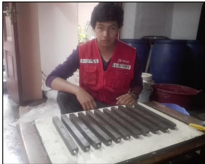
Figura 48. Barras de mortero desencofradas
