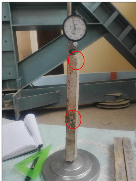
*FIGURA N° 39 barras de mortero a los 14 días presencia de fisuras, formación de gel en expansiones mayores a 1.5%*
