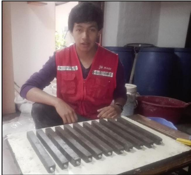
Figura 30. Desmolde de las barras de mortero 25x25x285 mm
