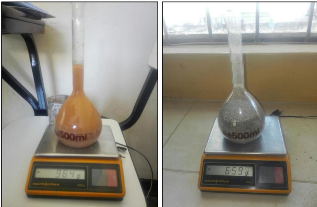
Figura 46. Ensayo Peso específico del agregado fino
