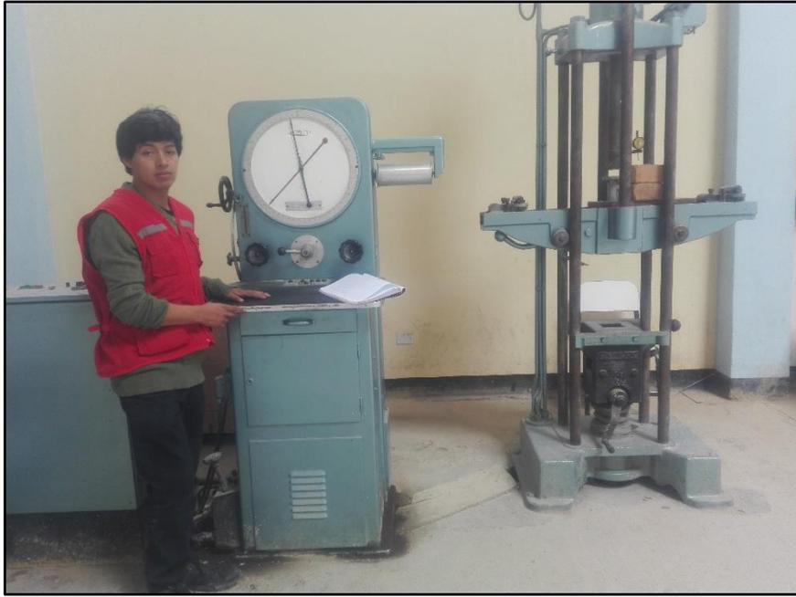
Figura 54. Ensayo de compresión del mortero.
