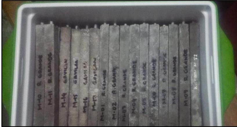
Figura 32. Almacenamiento de las barras de mortero
