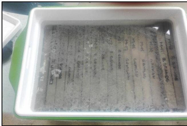
Figura 33. Curado de las barras de mortero
