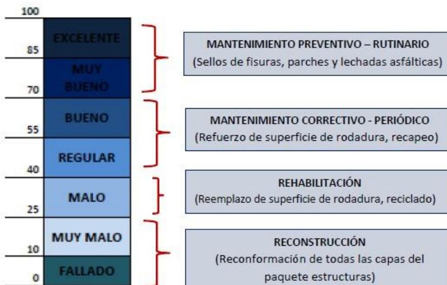
Figura 3.06 Escala de Graduación y tipo de intervención según escala de PCI.
