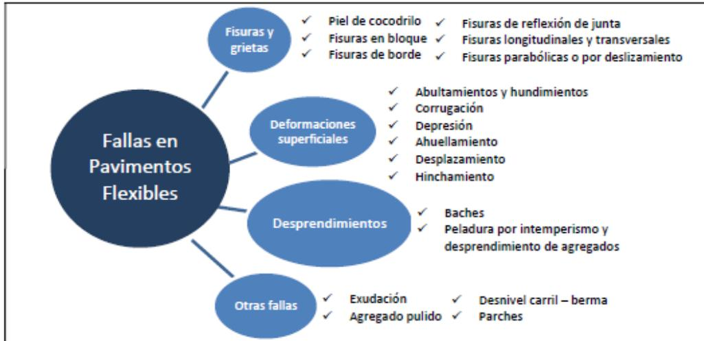
Figura 2.03. Fallas en pavimentos flexibles. (Fuente: Vásquez, 2002)
