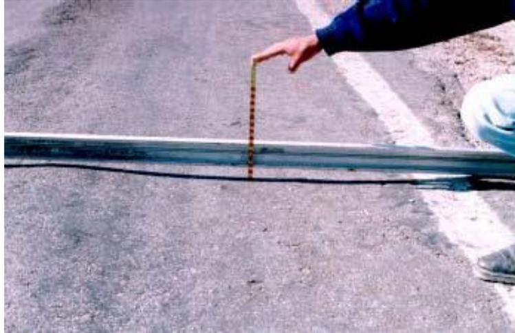
**Figura 2.29. Falla Tipo: Ahuellamientos**
