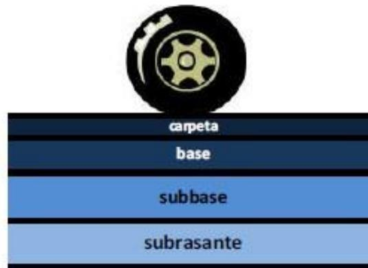
Figura 2.01 Esquema típico del paquete estructural de un pavimento
